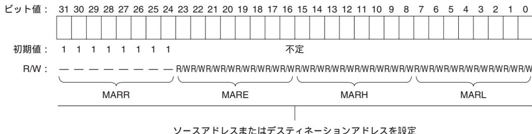
MAR がソースアドレスレジスタとして機能するか、デスティネーションアドレスレジスタとして機能するかは、起動要因によって自動的に決定されます。起動要因が SCI チャンネル 0 の受信完了割り込み、および A/D 変換器の変換終了割り込みの場合はデスティネーションアドレスレジスタとして、それ以外の場合にはソースアドレスレジスタとして機能します。
