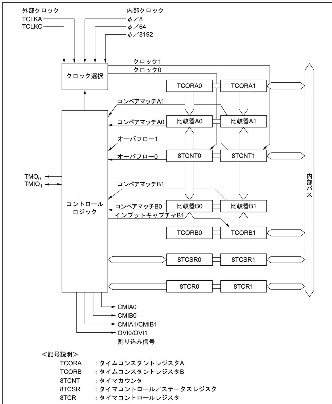
図 10.1 8ビットタイマのブロック図 (2チャンネル分: グループ0)
