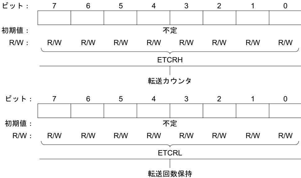
リピートモードでは、ETCRH は 8 ビットの転送カウンタとして機能し、ETCRL は転送回数を保持します。ETCRH は 1 回の転送を行うたびに 1 だけデクリメントされ、H'00 になると ETCRL の内容が転送されます。以降この動作を繰り返して転送が行われます。
