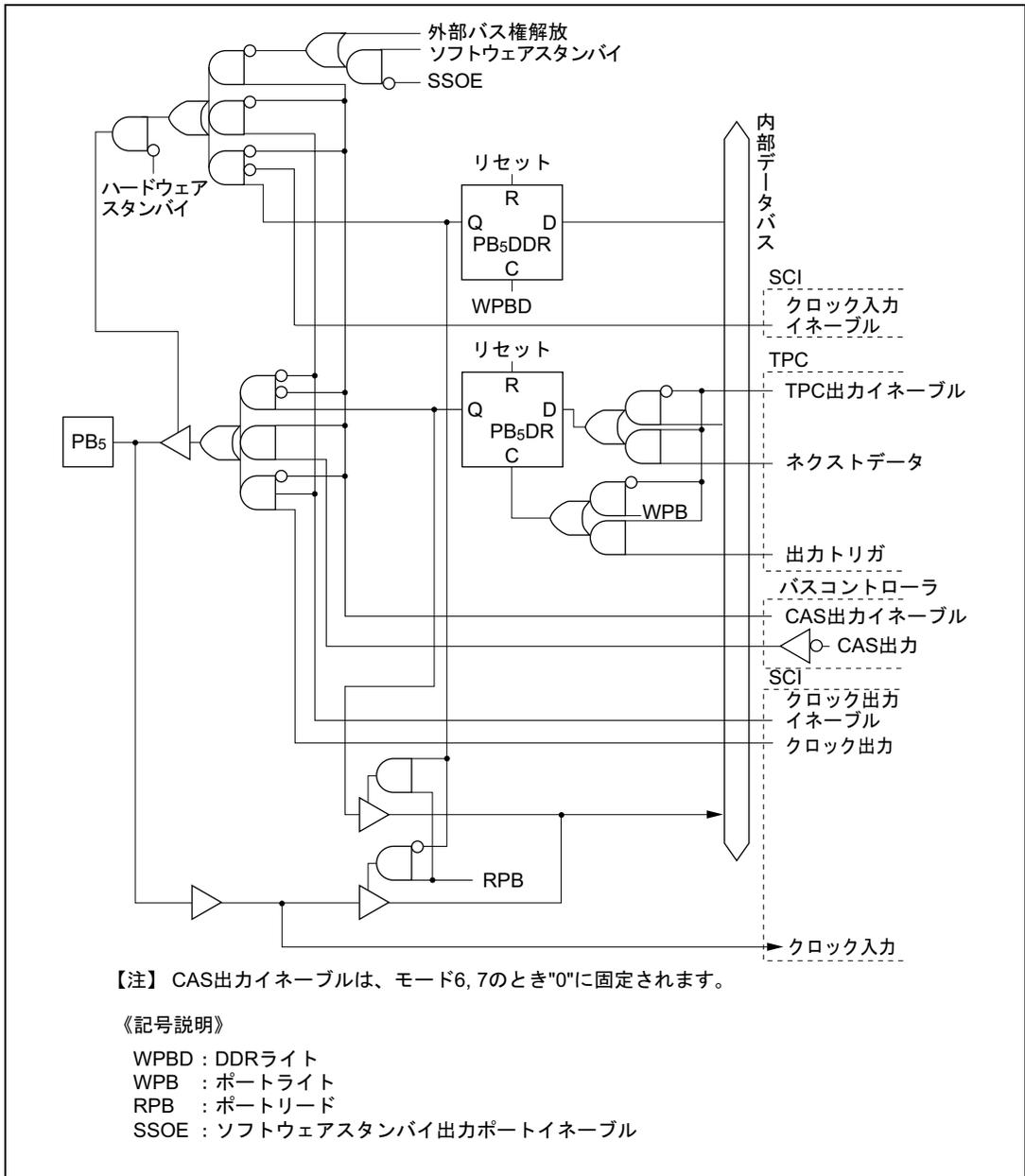
図 C.11 (f) ポート B ブロック図 (PB<sub>5</sub> 端子)
