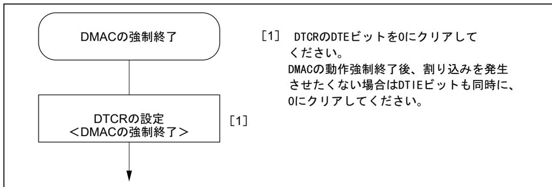
図 7.22 DMAC 動作の強制終了手順
