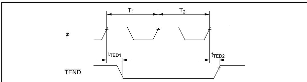
図 21.25 DMAC、 $\overline{\text{TEND}}$  出力タイミング/2 スタートアクセス
