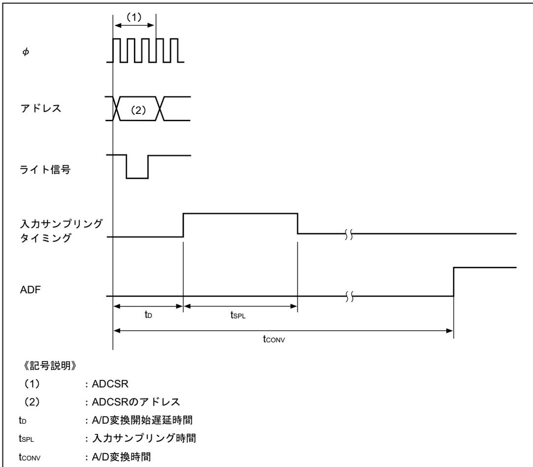
図 15.5 A/D 変換タイミング
