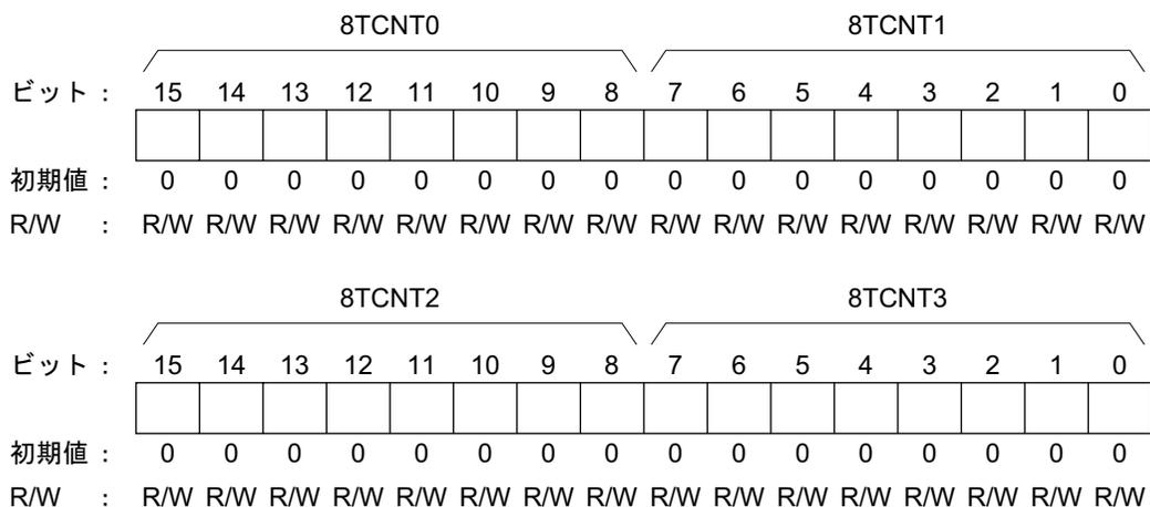
8TCNTはそれぞれ8ビットのリード/ライト可能なアップカウンタで、入力する内部または外部クロックによってカウントアップされます。入力するクロックは、8TCRのCKS2~CKS0ビットで選択します。8TCNTの値は、CPUから常にリード/ライト可能です。
