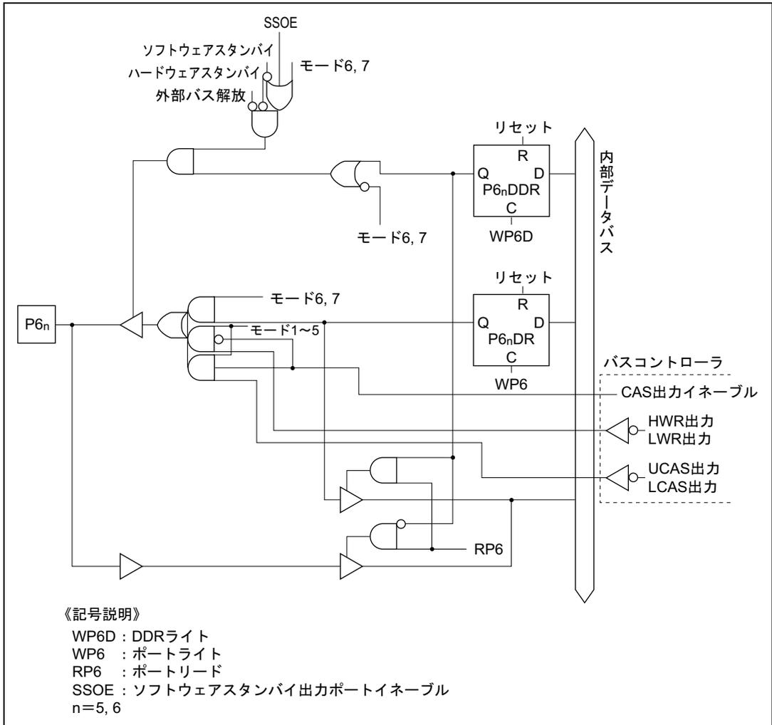
図 C.6 (f) ポート 6 ブロック図 (P6<sub>5</sub>、P6<sub>6</sub> 端子)
