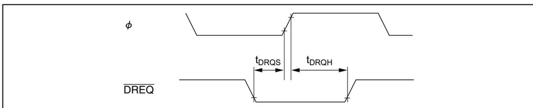
図 21.27 DMAC、 $\overline{\text{DREQ}}$  入力タイミング
