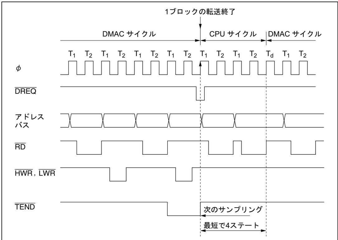
図 7.18 ブロック転送モード時の  $\overline{DREQ}$  端子の立ち下がりエッジによる DMAC 起動タイミング
