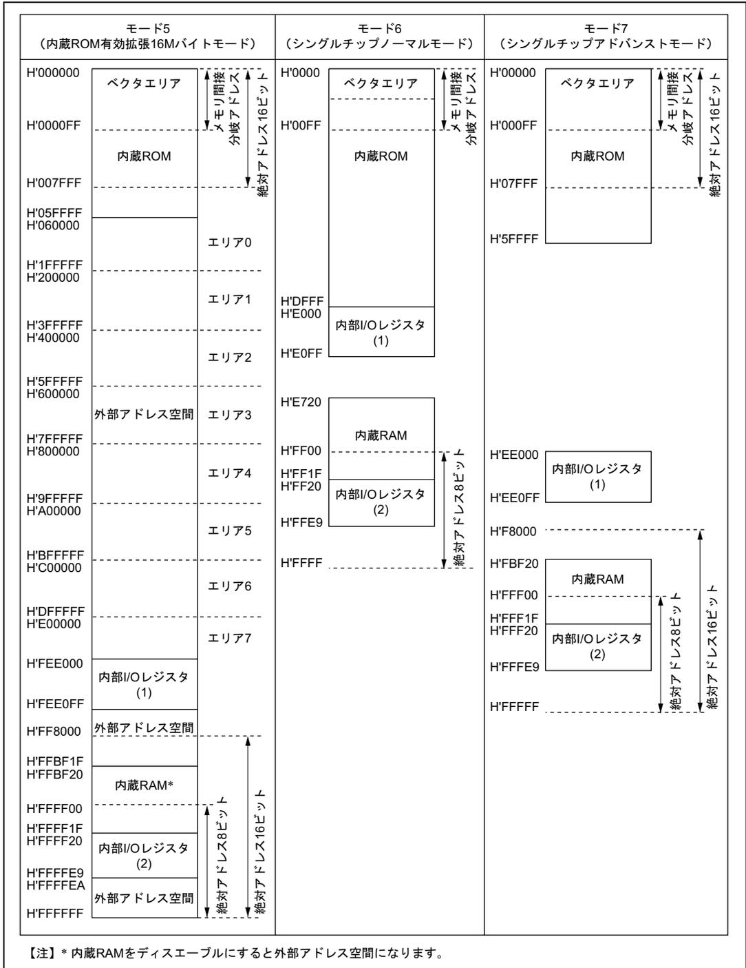
図 3.1 H8/3028 グループの各動作モードにおけるメモリマップ (EMC ビット=1 のとき) (2)
