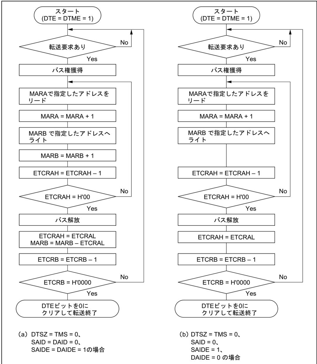
図 7.11 ブロック転送モードの動作フロー
