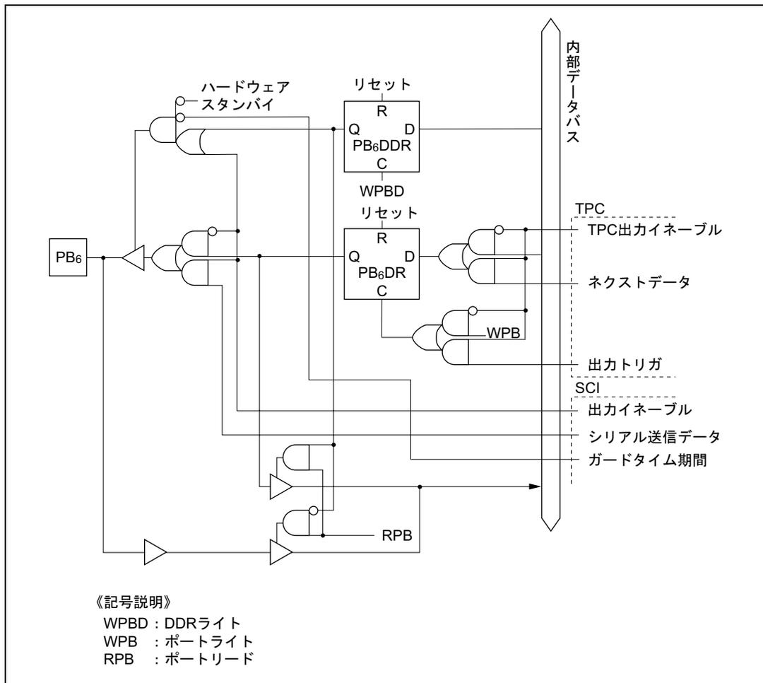
図 C.11 (g) ポート B ブロック図 (PB<sub>6</sub> 端子)
