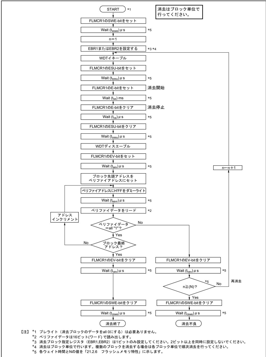
図 18.11 イレース/イレースペリファイフロー（単一ブロック消去）
