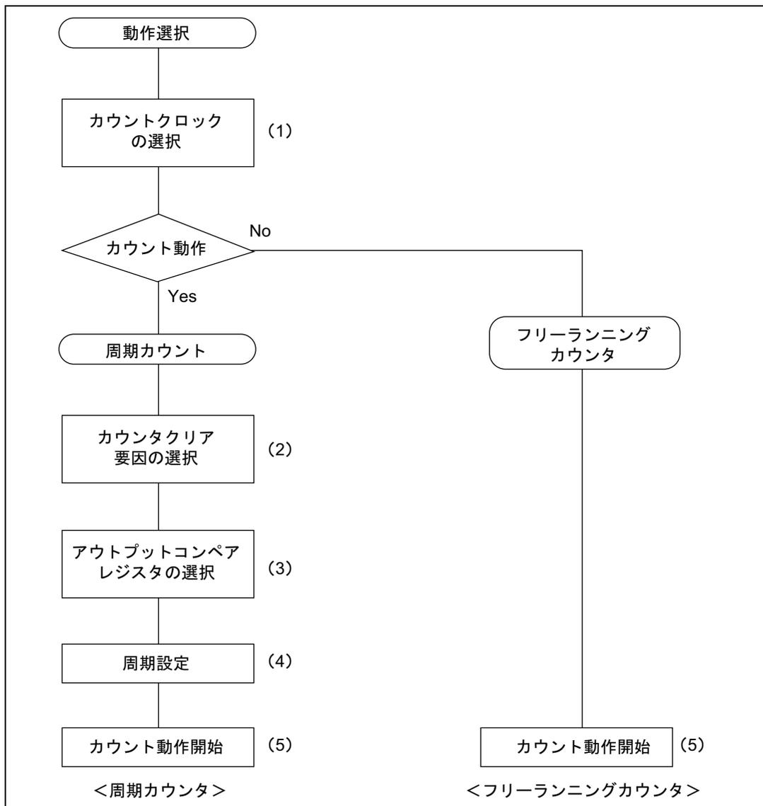
図 9.12 カウント動作設定手順例
