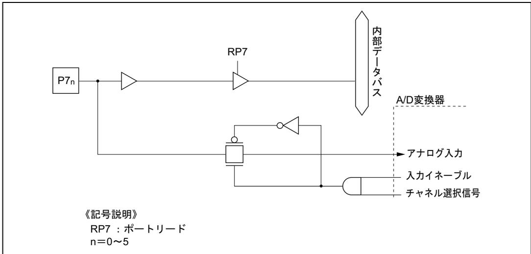
図 C.7 (a) ポート7ブロック図 (P7<sub>0</sub>~P7<sub>5</sub>端子)
