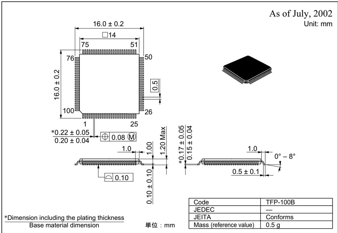
図 G.2 外形寸法図 (TFP-100B)
