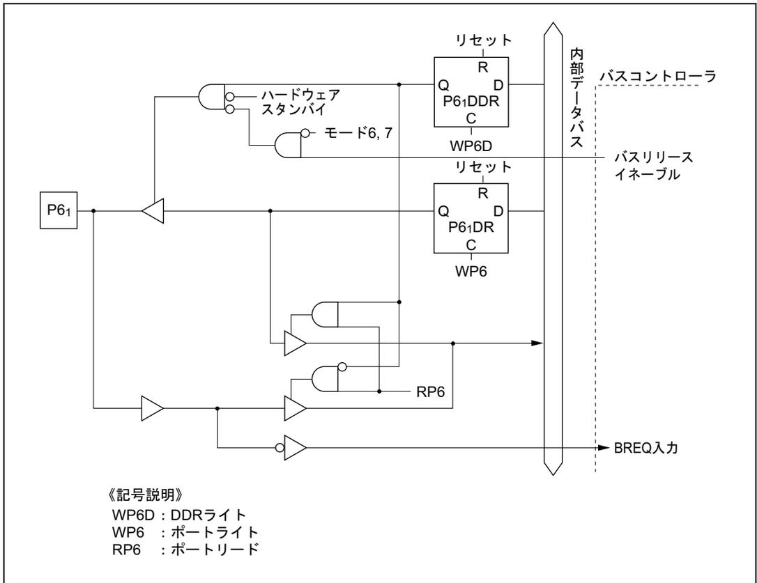
図 C.6 (b) ポート 6 ブロック図 (P6<sub>1</sub> 端子)
