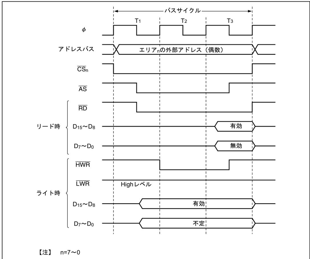
図 6.11 16 ビット 3 ステートアクセス空間のバス制御信号タイミング
