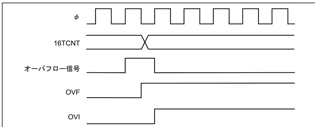
図 9.35 OVF のセットタイミング
