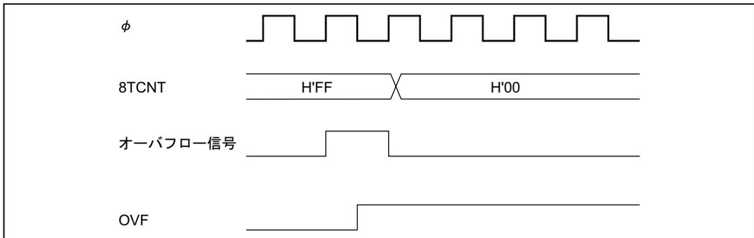
図 10.16 OVF のセットタイミング
