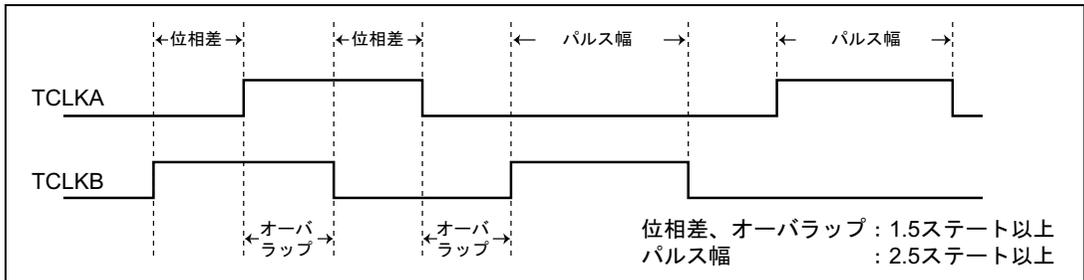
図 9.31 位相計数モード時の位相差、オーバーラップおよびパルス幅
