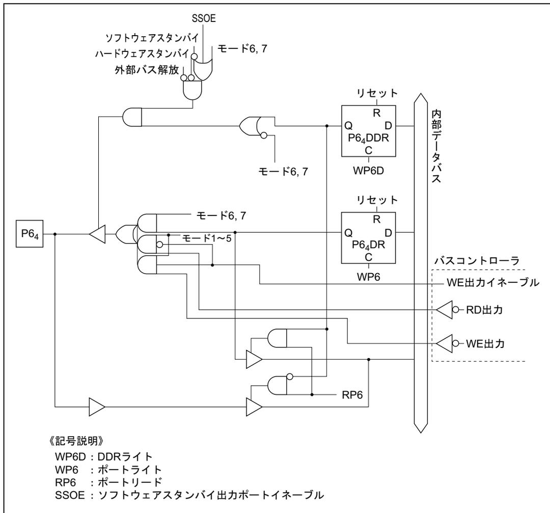
図 C.6 (e) ポート 6 ブロック図 (P6<sub>4</sub>端子)
