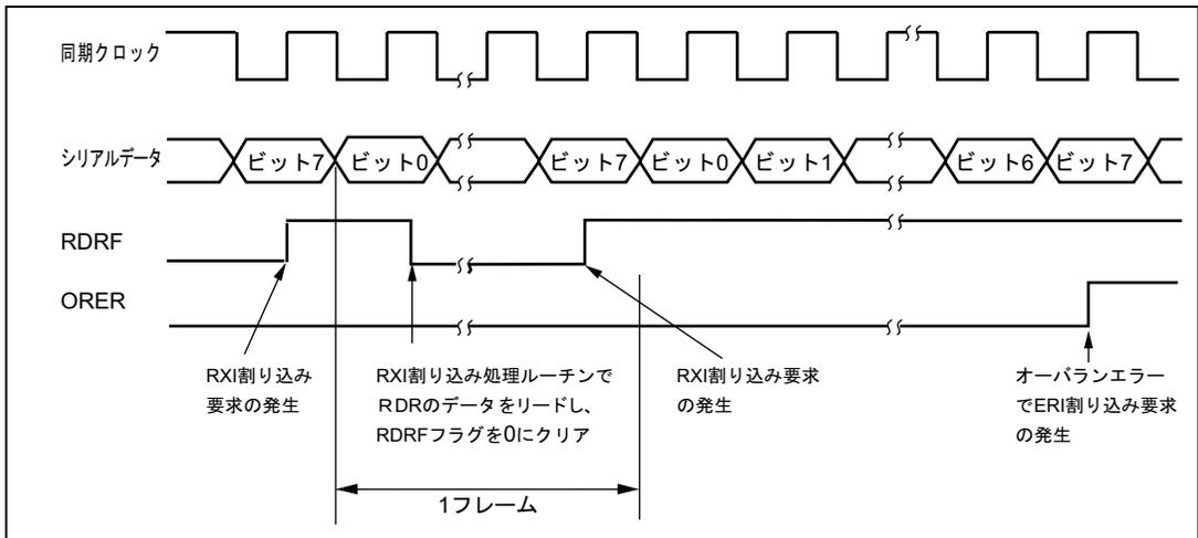
図 13.19 SCI の受信時の動作例
