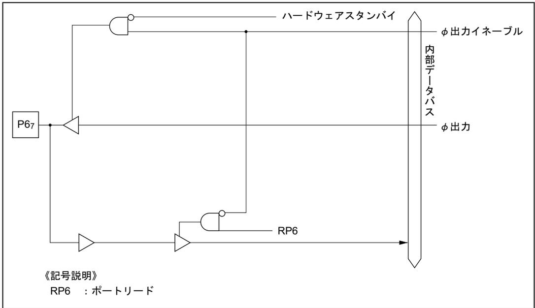
図 C.6 (g) ポート 6 ブロック図 (P6<sub>7</sub> 端子)
