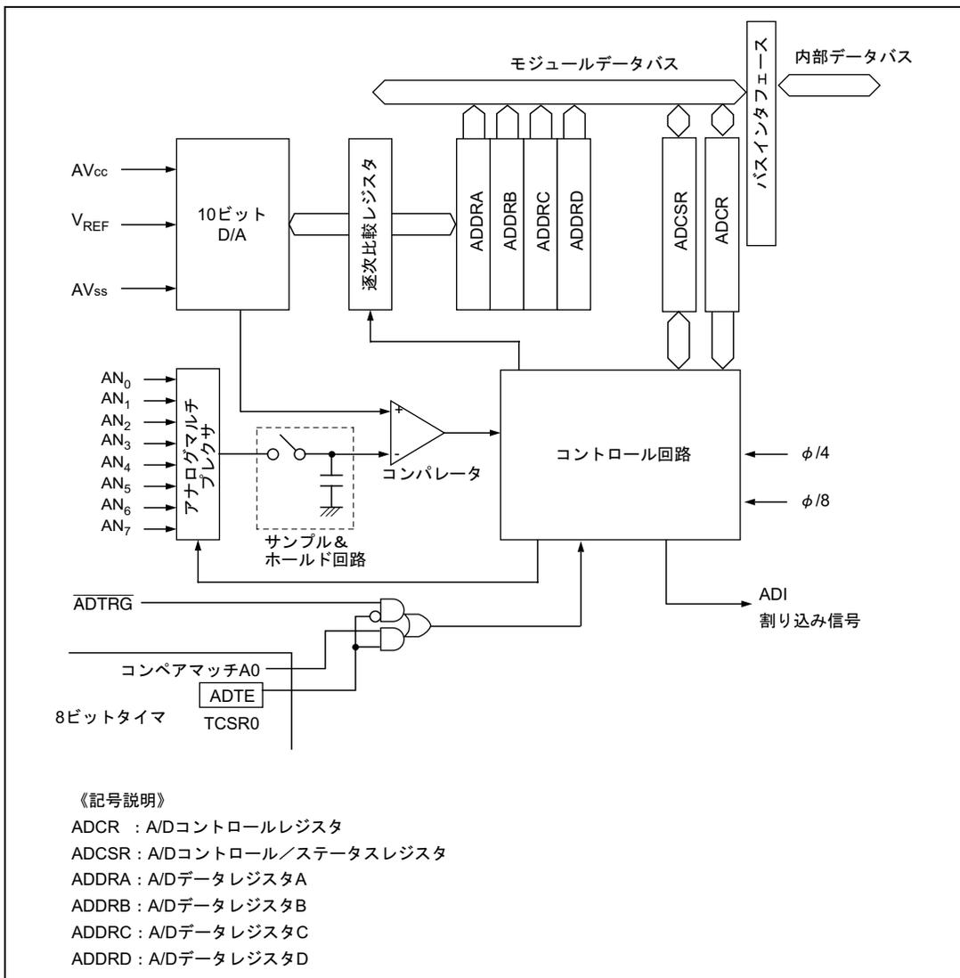
図 15.1 A/D 変換器のブロック図
