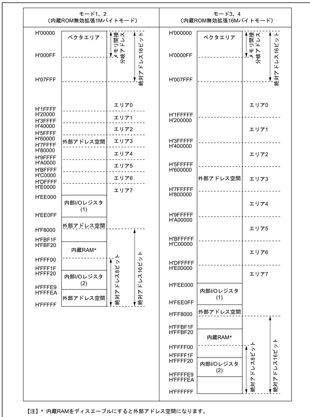
図 3.1 H8/3028 グループの各動作モードにおけるメモリマップ (EMC ビット=1 のとき) (1)
