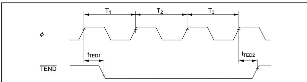
図 21.26 DMAC、 $\overline{\text{TEND}}$  出力タイミング/3 スタートアクセス
