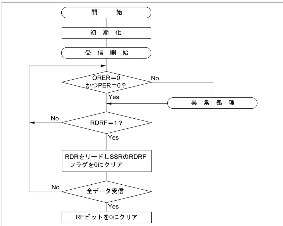
図 14.8 受信処理フローの例
