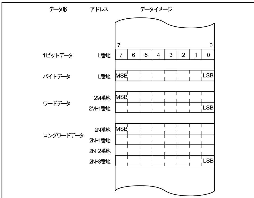
図 2.8 メモリ上でのデータ構成
