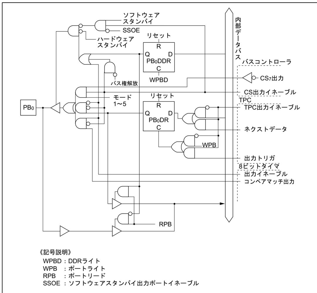
図 C.11 (a) ポートBブロック図 (PB<sub>0</sub> 端子)
