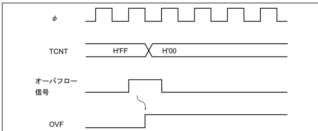
図 12.6 OVF フラグのセットタイミング
