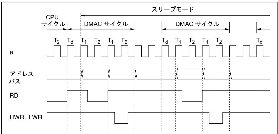
図 7.24 スリープモード中のサイクルスチールモードのタイミング
