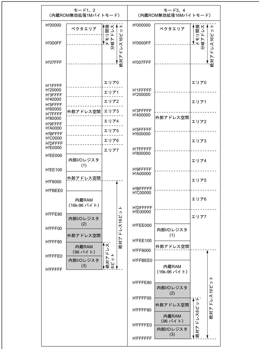
図 3.2 H8/3028 グループの各動作モードにおけるメモリマップ (EMC ビット=0 のとき) (1)
