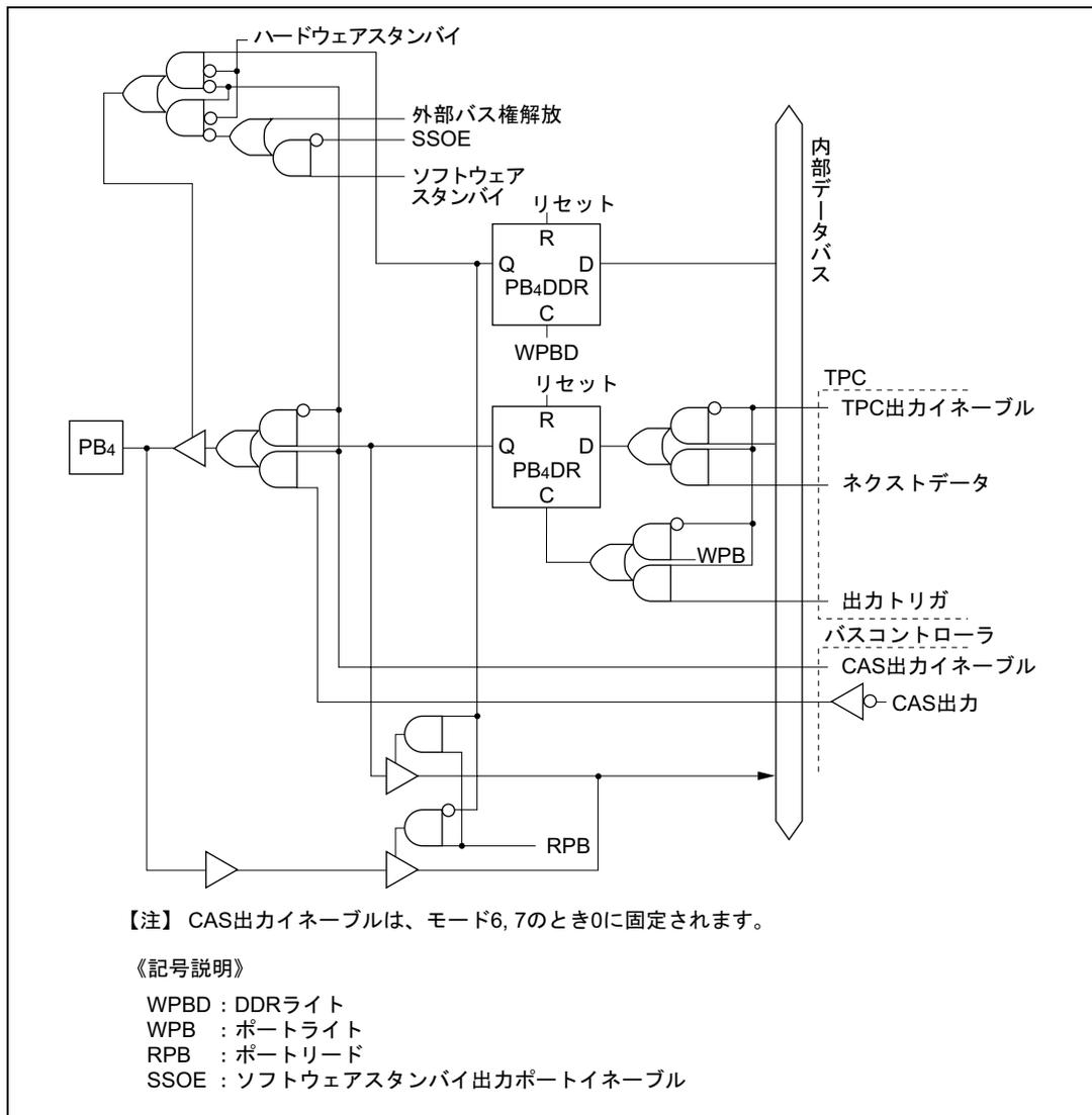
図 C.11 (e) ポート B ブロック図 (PB<sub>4</sub> 端子)
