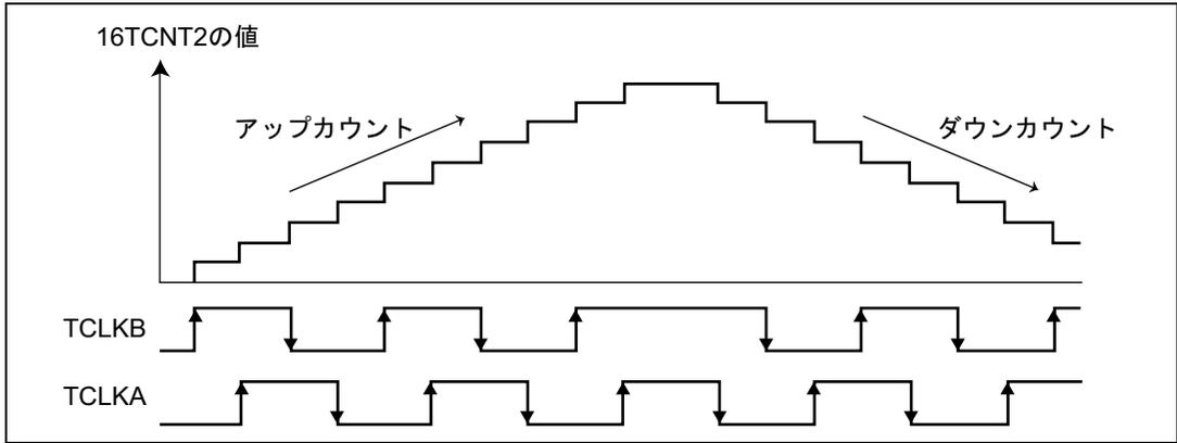
図 9.30 位相計数モードの動作例
