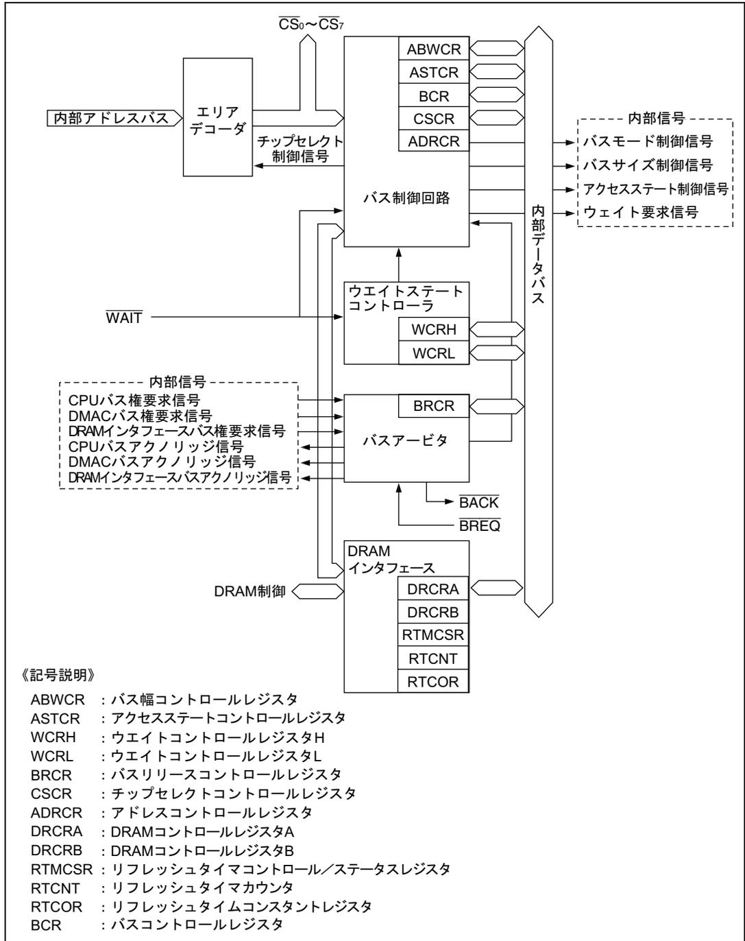
図 6.1 バスコントローラのブロック図
