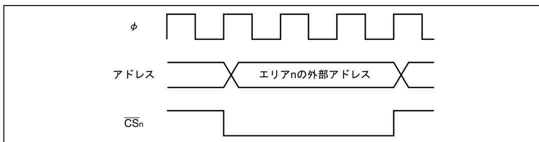
図 6.4  $\overline{CS}_n$  信号の出力タイミング (n=0~7)
