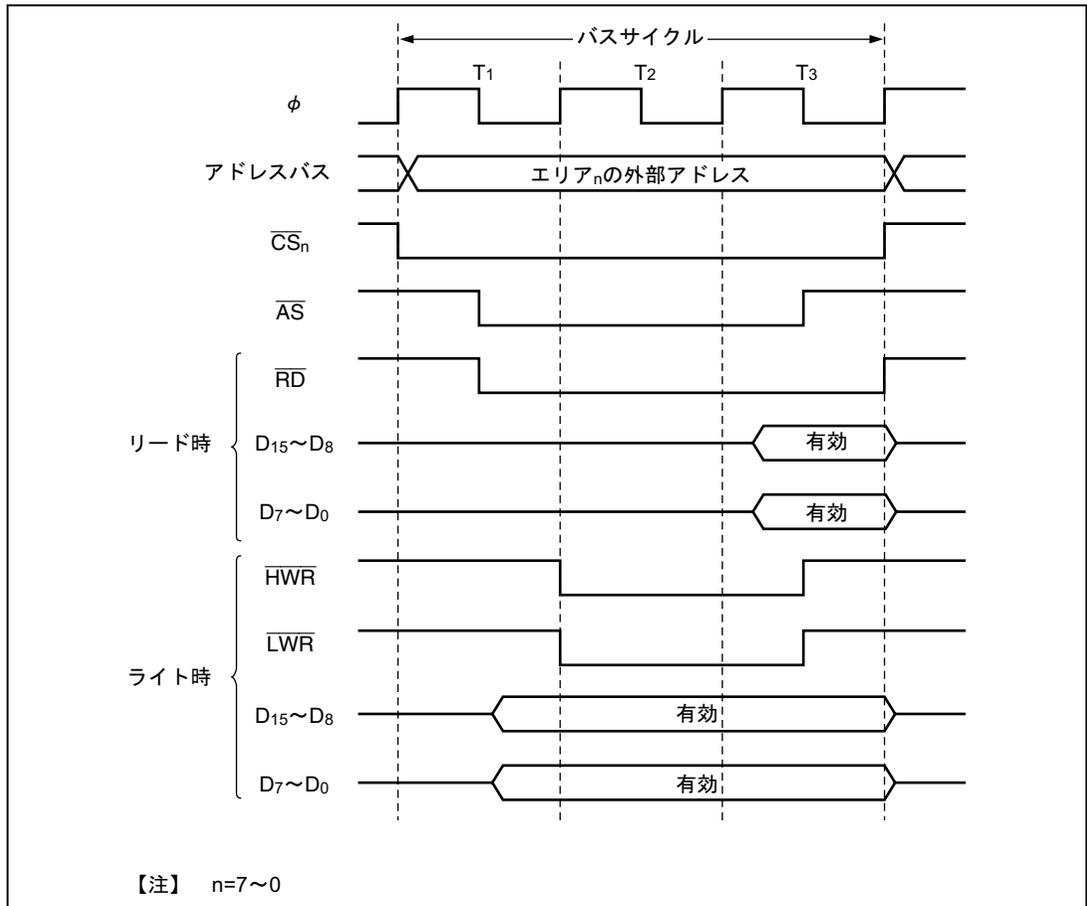
図 6.13 16 ビット 3 ステートアクセス空間のバス制御信号タイミング
