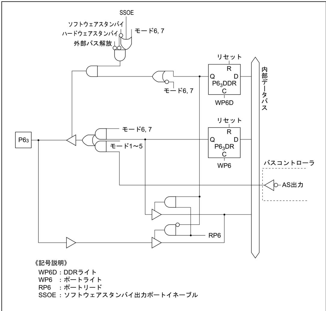
図 C.6 (d) ポート 6 ブロック図 (P6<sub>3</sub> 端子)
