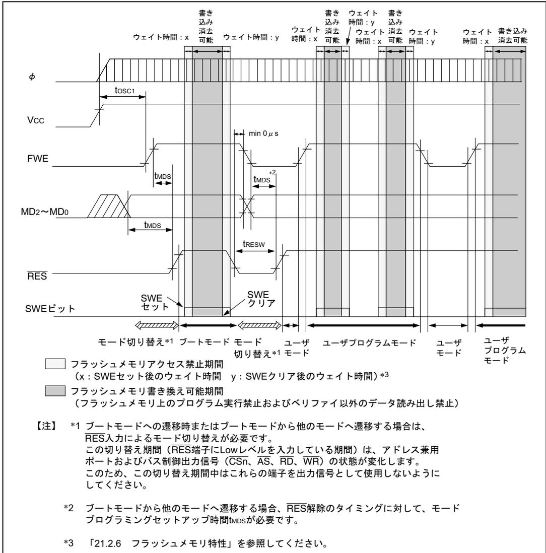
図 18.18 モード遷移タイミング (例: ブートモード⇒ユーザモード⇄ユーザプログラムモード)
