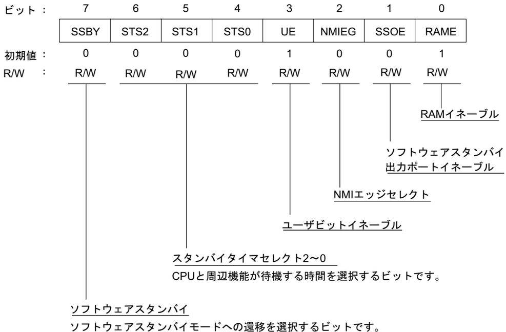
SYSCR は 8 ビットのリード/ライト可能なレジスタで、ビット 7 の SSBY ビットとビット 6~4 の STS2~STS0 ビットとビット 1 の SSOE ビットにより低消費電力状態の制御を行います。なお、SYSCR のその他のビットについての詳細は「3.3 システムコントロールレジスタ (SYSCR)」を参照してください。
