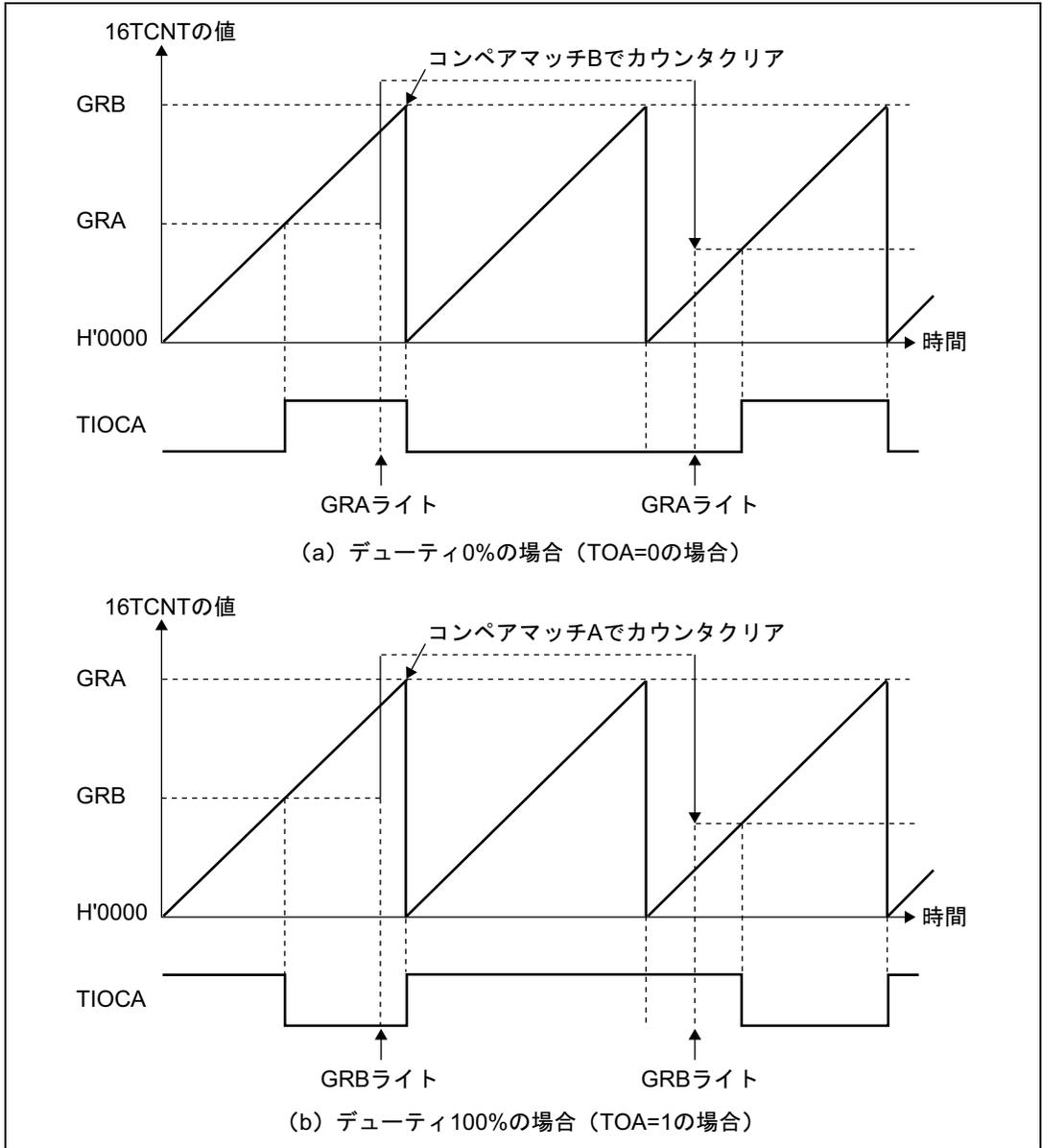
図 9.28 PWM モードの動作例 (2)
