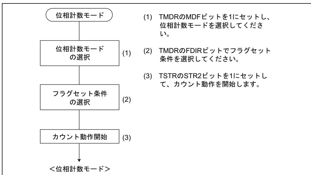
図 9.29 位相計数モードの設定手順例
