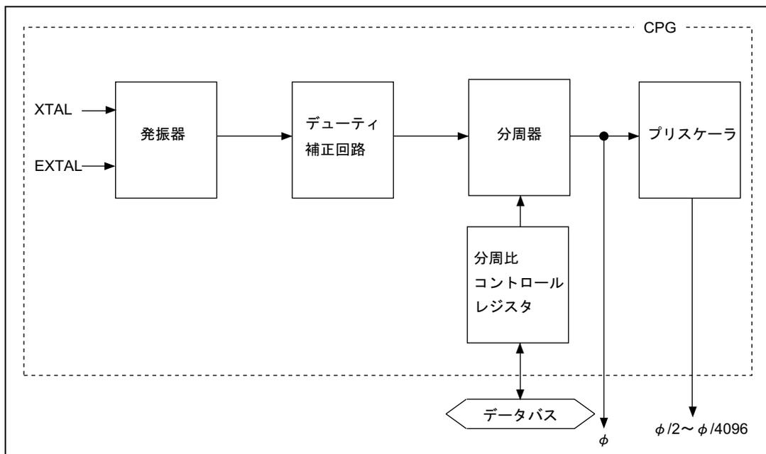
図 19.1 クロック発振器のブロック図
