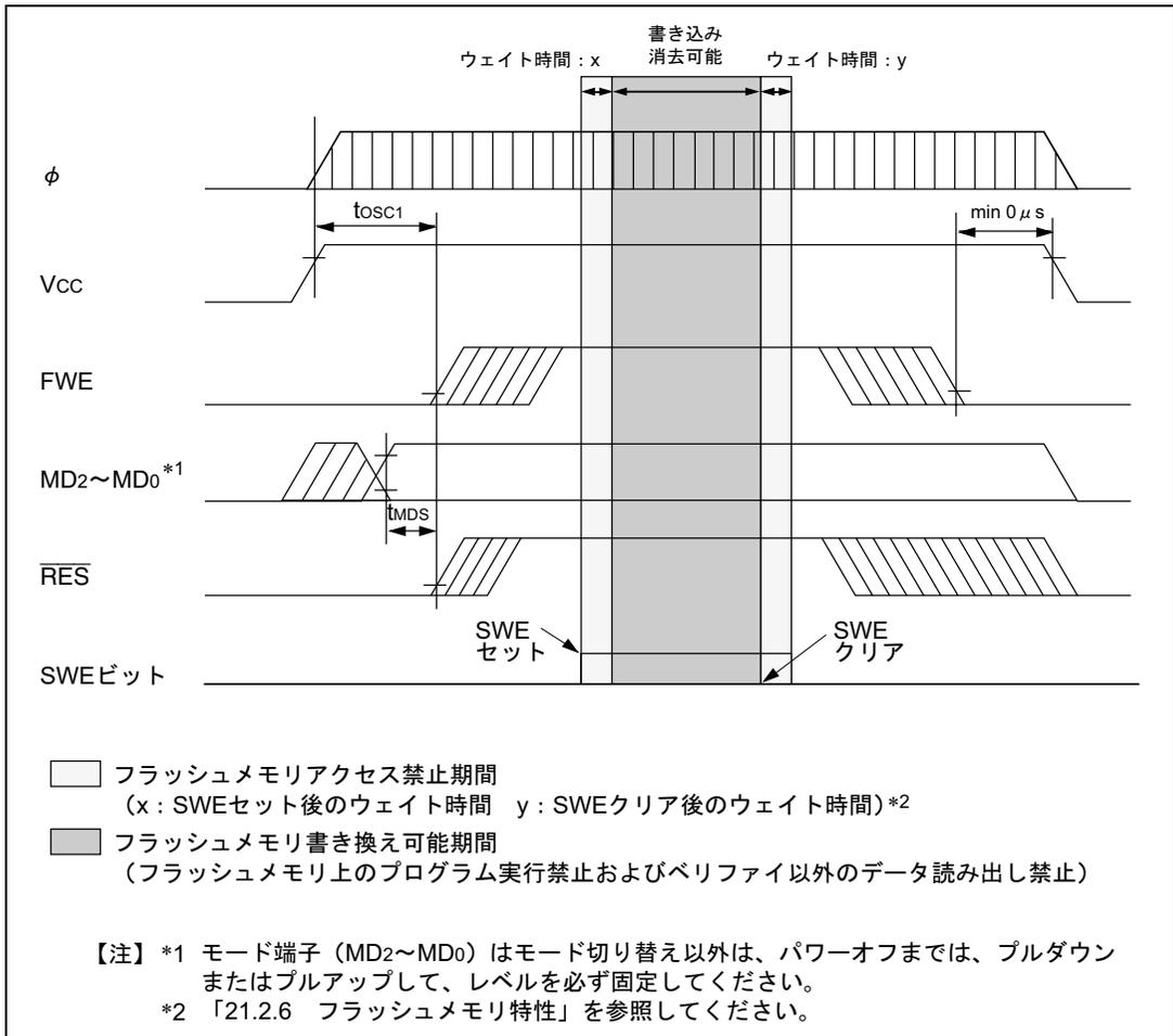
図 18.17 電源投入/切断タイミング (ユーザプログラムモード)
