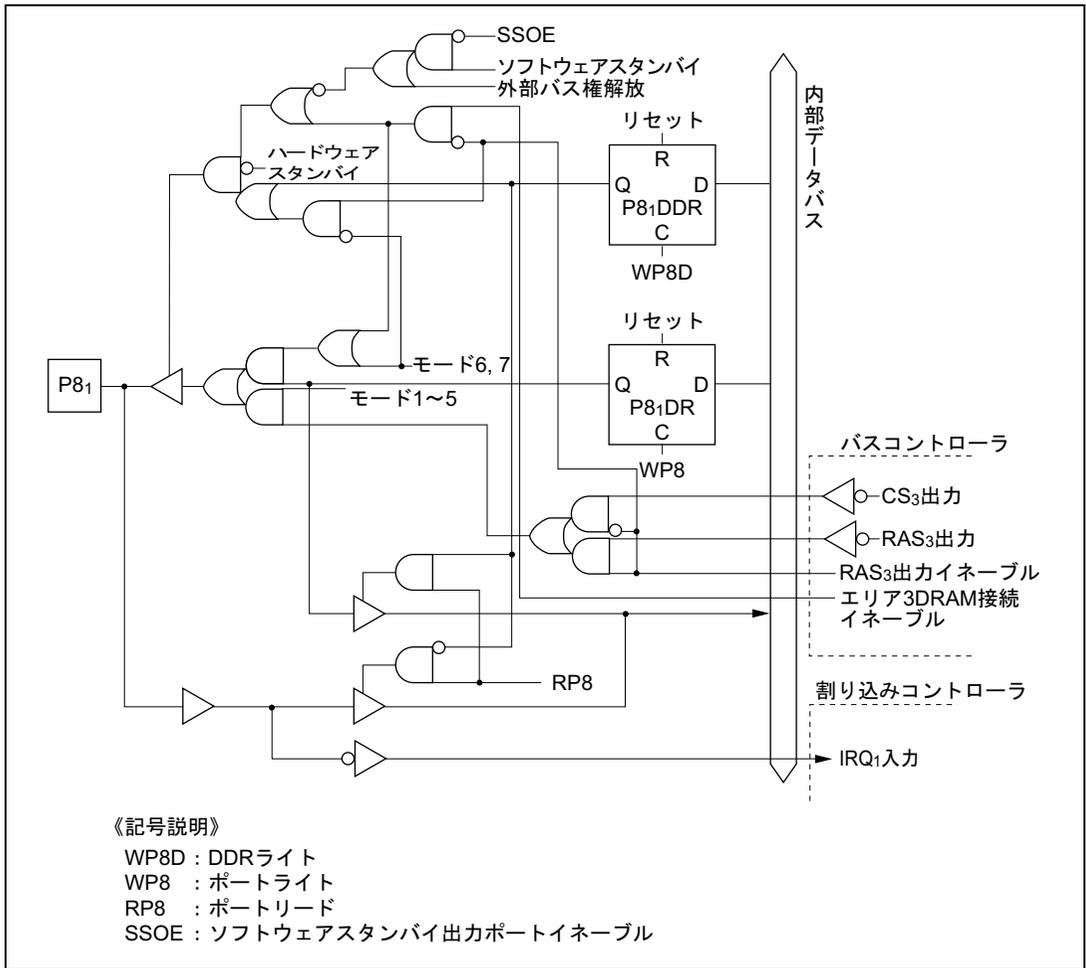
図 C.8 (b) ポート 8 ブロック図 (P8<sub>1</sub> 端子)
