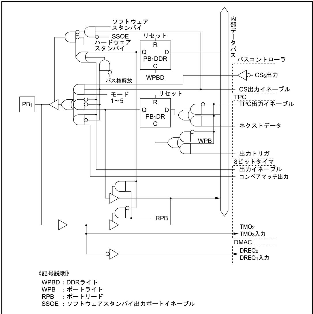
図 C.11 (b) ポート B ブロック図 (PB<sub>1</sub> 端子)
