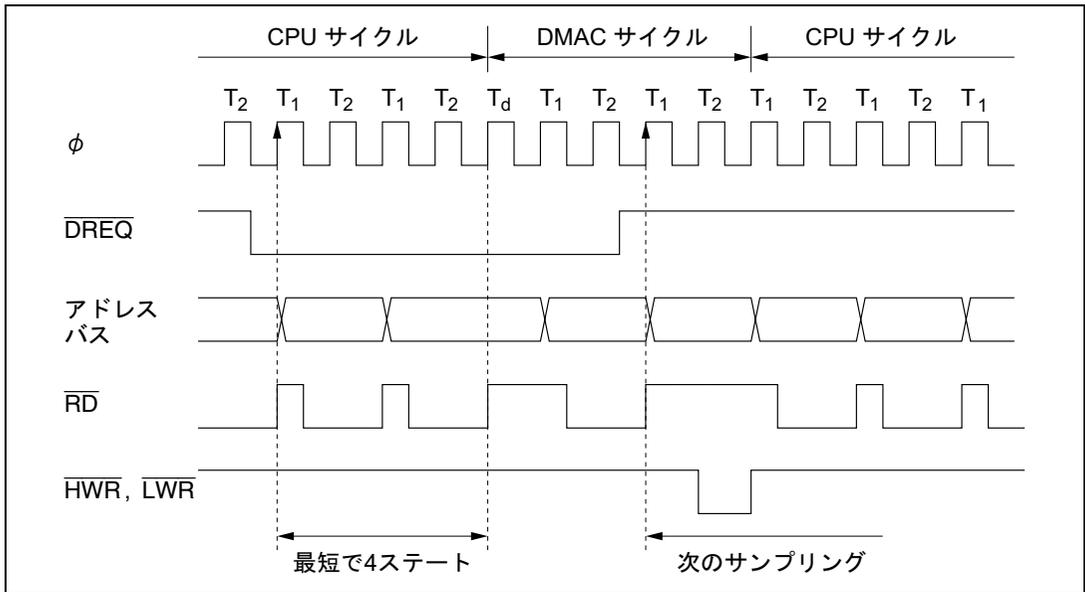
図 7.17 ノーマルモード時の  $\overline{DREQ}$  端子の Low レベルによる DMAC 起動タイミング
