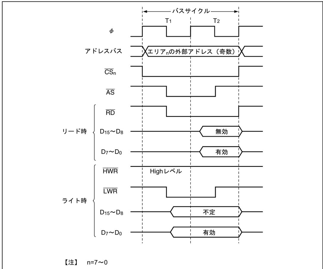
図 6.15 16 ビット 2 ステートアクセス空間のバス制御信号タイミング
