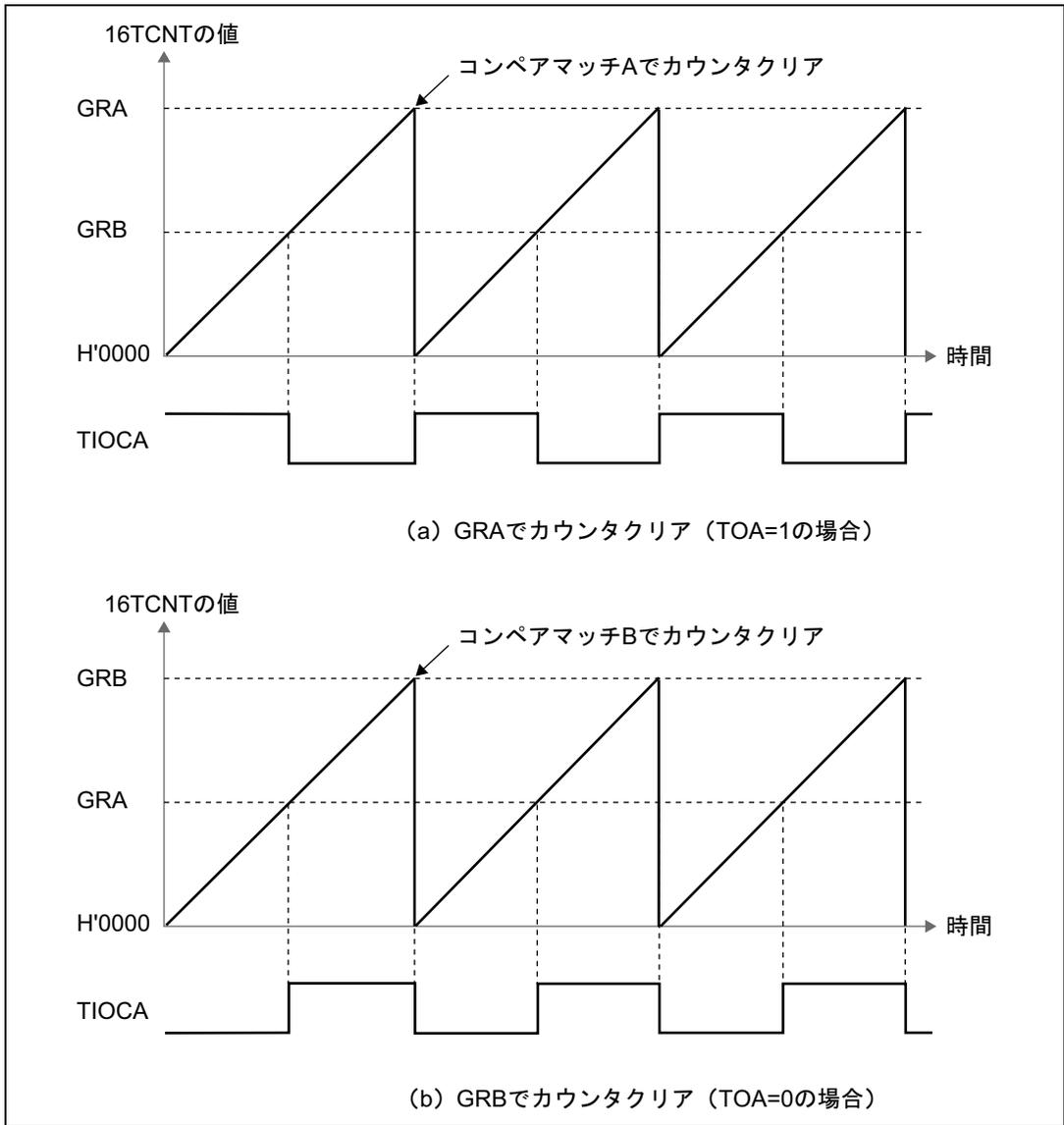
図 9.27 PWM モードの動作例 (1)
