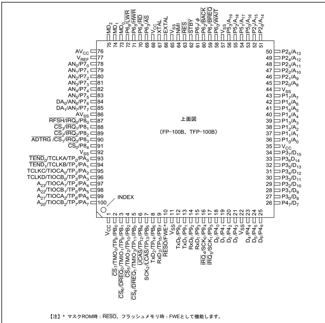
図 1.2 ピン配置図 (FP-100B、TFP-100B : 上面図)
