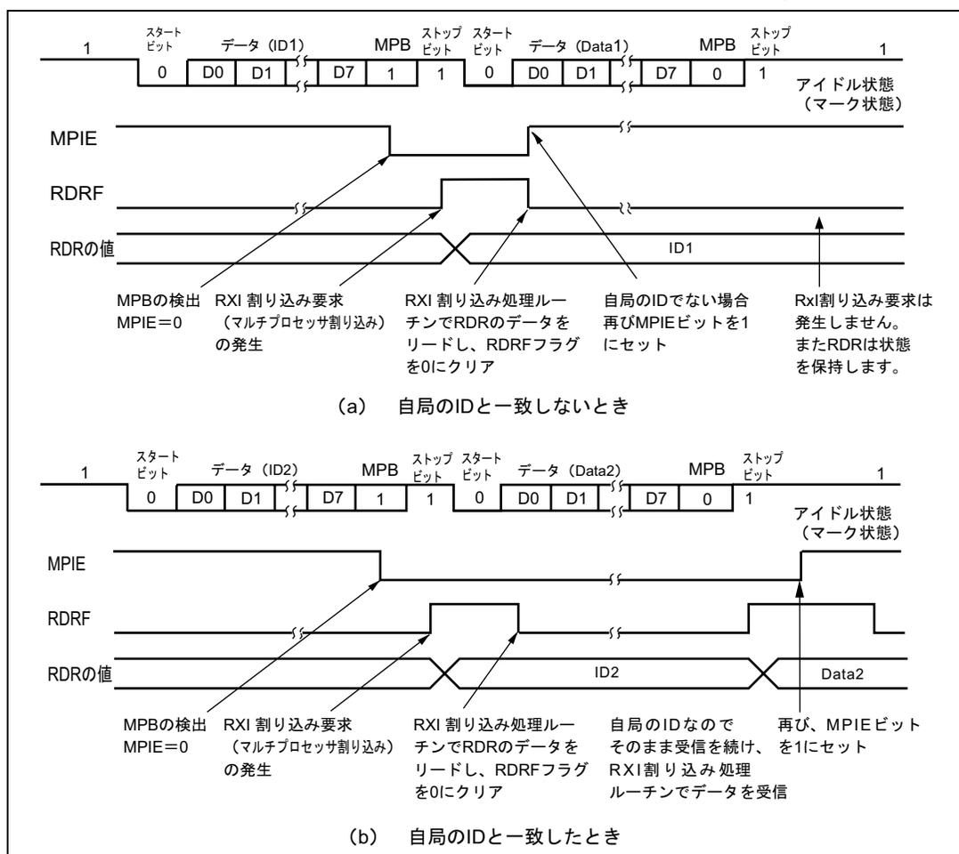
図 13.13 SCI の受信時の動作例
