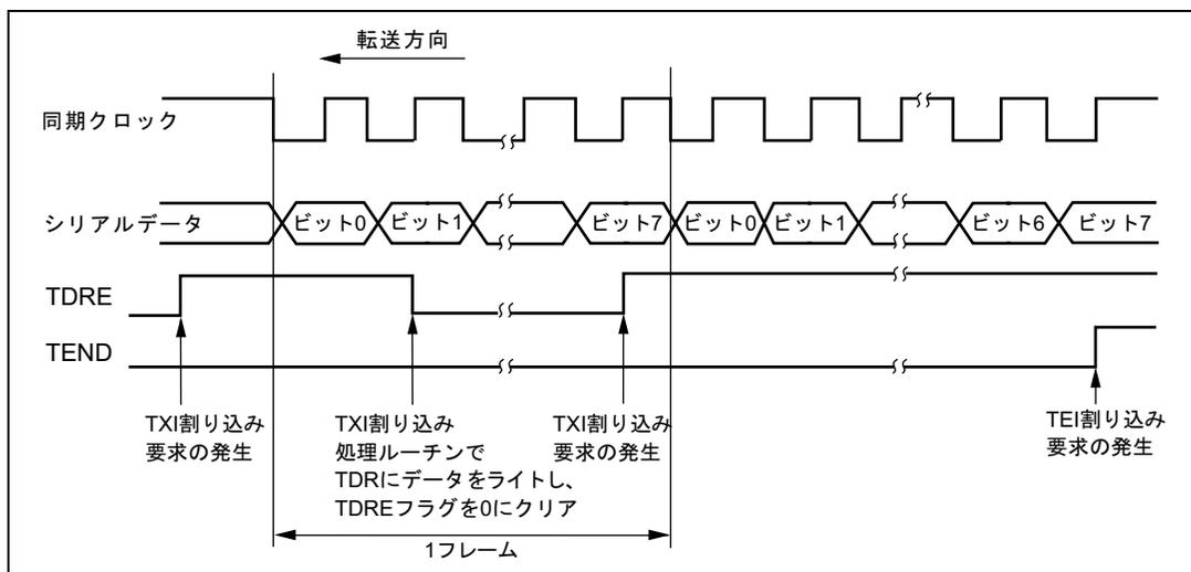
図 13.17 SCI の送信時の動作例
