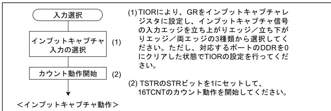
図 9.21 インプットキャプチャ動作の設定手順例
