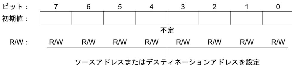
IOAR がソースアドレスレジスタとして機能するか、デスティネーションアドレスレジスタとして機能するかは、起動要因によって自動的に決定されます。起動要因が SCI チャンネル 0 の受信完了割り込み、および A/D 変換器の変換終了割り込みの場合はソースアドレスレジスタとして、それ以外の場合にはデスティネーションアドレスレジスタとして機能します。
