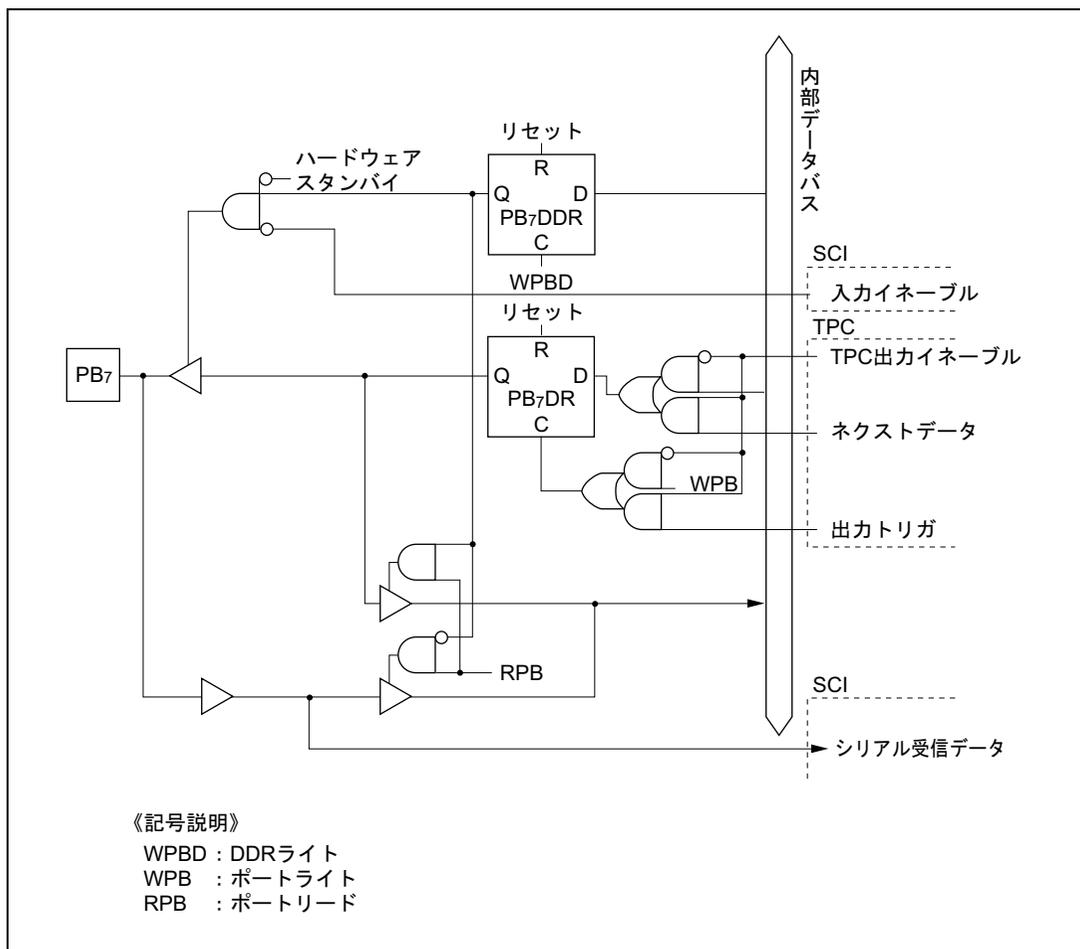
図 C.11 (h) ポート B ブロック図 (PB<sub>7</sub> 端子)
