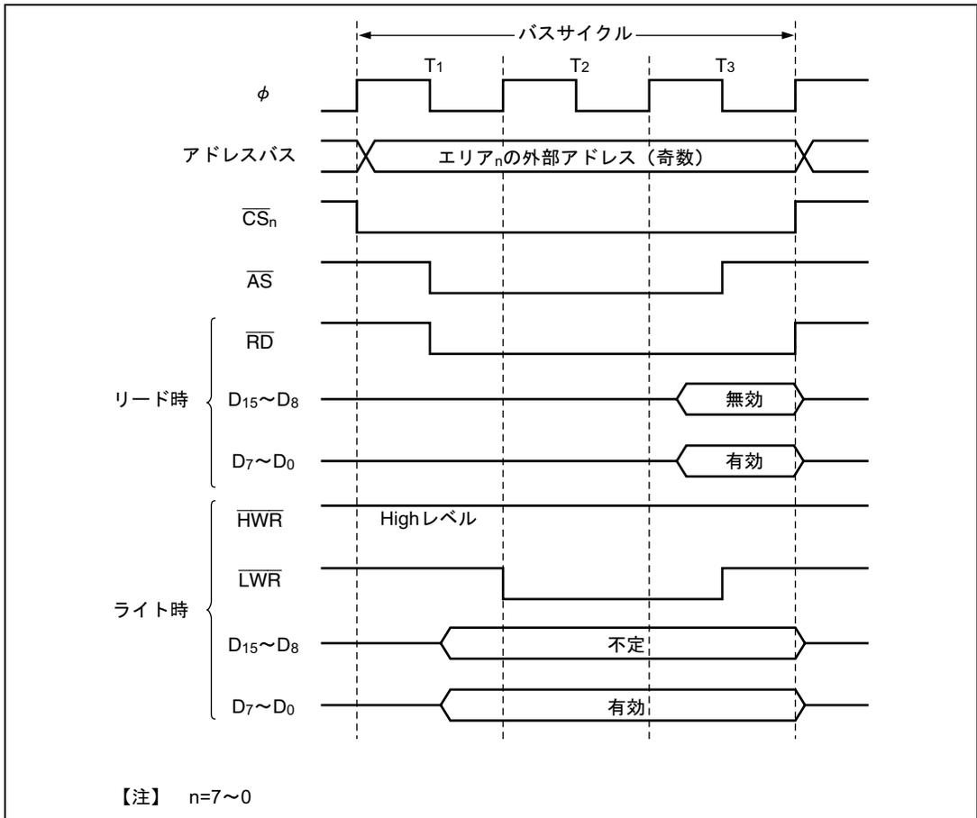
図 6.12 16 ビット 3 ステートアクセス空間のバス制御信号タイミング
