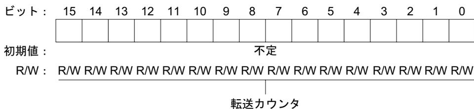
I/O モードとアイドルモードでは、ETCR は 16 ビットの転送カウンタとして機能します。1 回の転送を行うたびに、1 だけデクリメントされカウンタ値が H'0000 になると転送を終了します。
