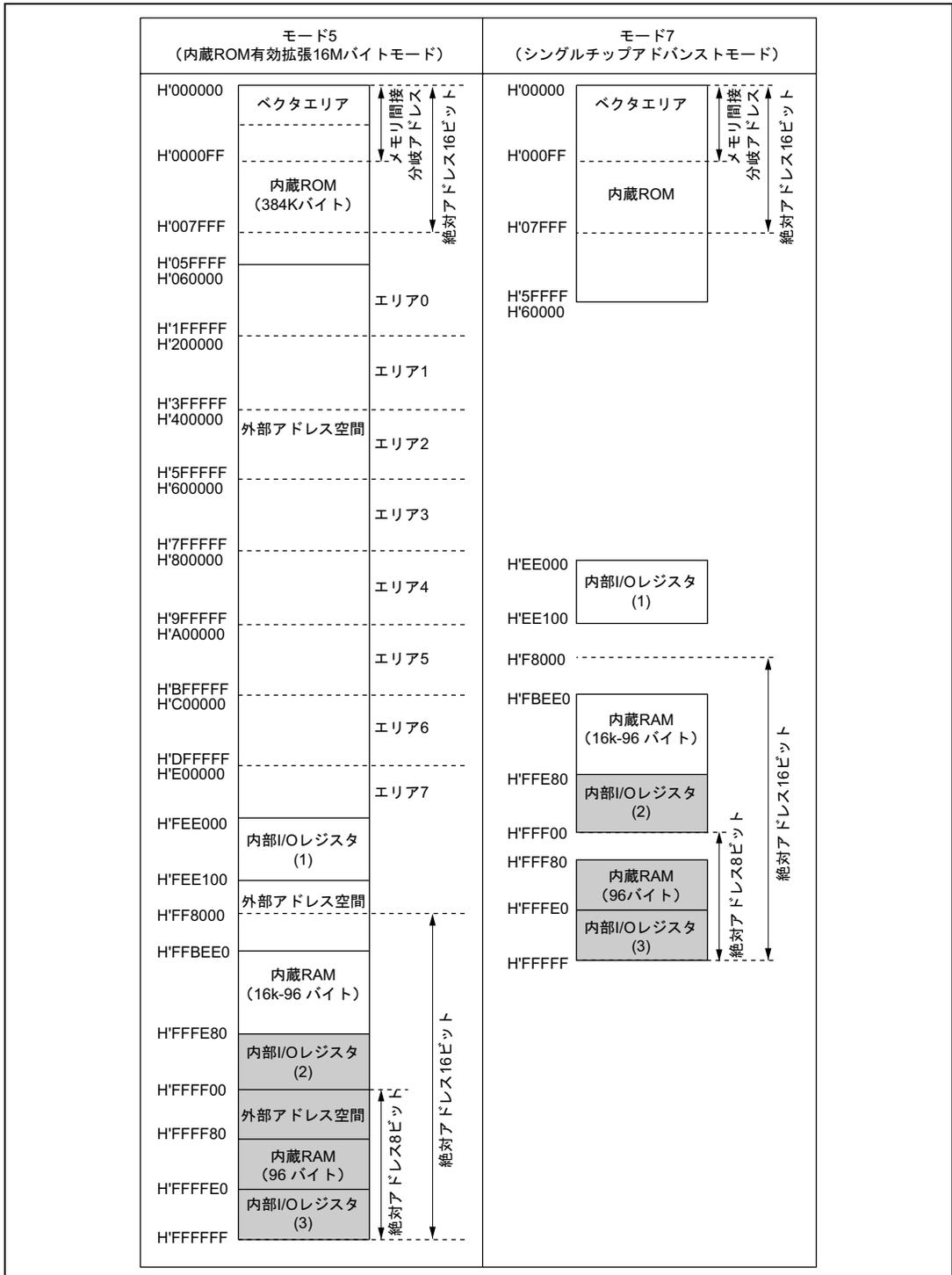
図 3.2 H8/3028 グループの各動作モードにおけるメモリーマップ (EMC ビット=0 のとき) (2)
