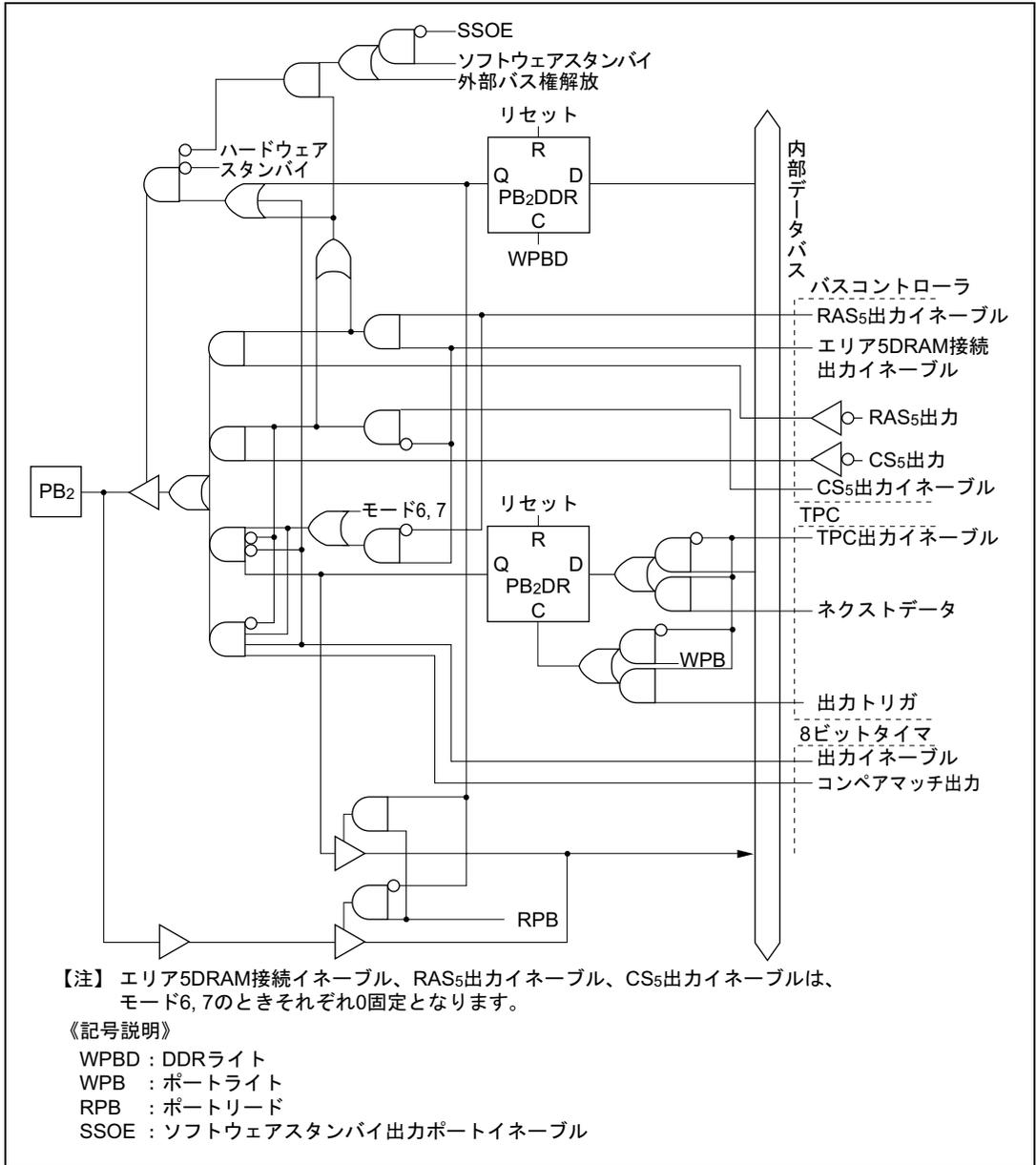
図 C.11 (c) ポート B ブロック図 (PB<sub>2</sub> 端子)
