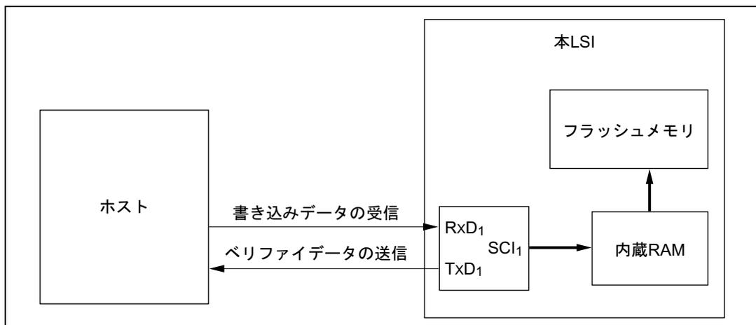
図 18.5 ブートモード時のシステム構成図
