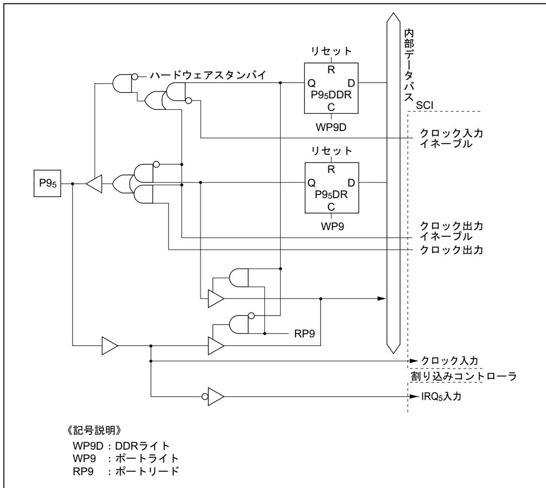
図 C.9 (f) ポート 9 ブロック図 (P9<sub>5</sub> 端子)
