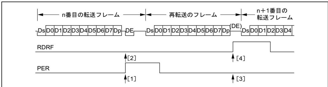
図 14.12 SCI 受信モードの場合の再転送動作
