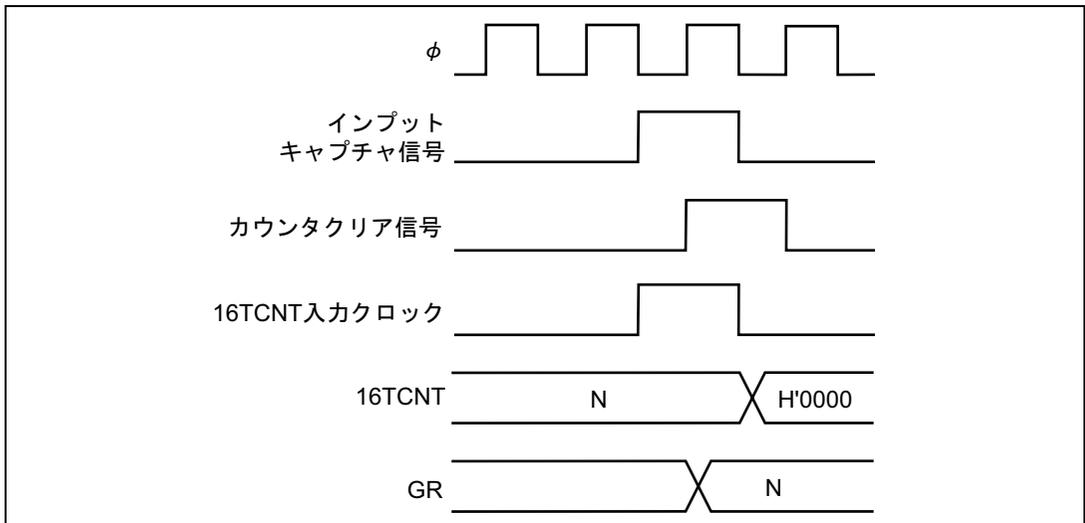
図 9.43 入力キャプチャによるカウンタクリアとカウントアップの競合
