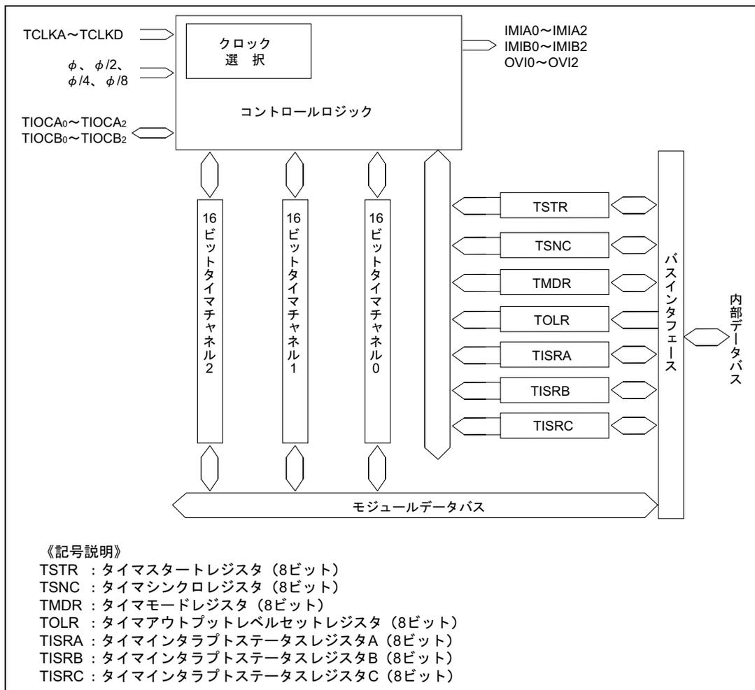
図 9.1 16ビットタイマのブロック図 (全体図)
