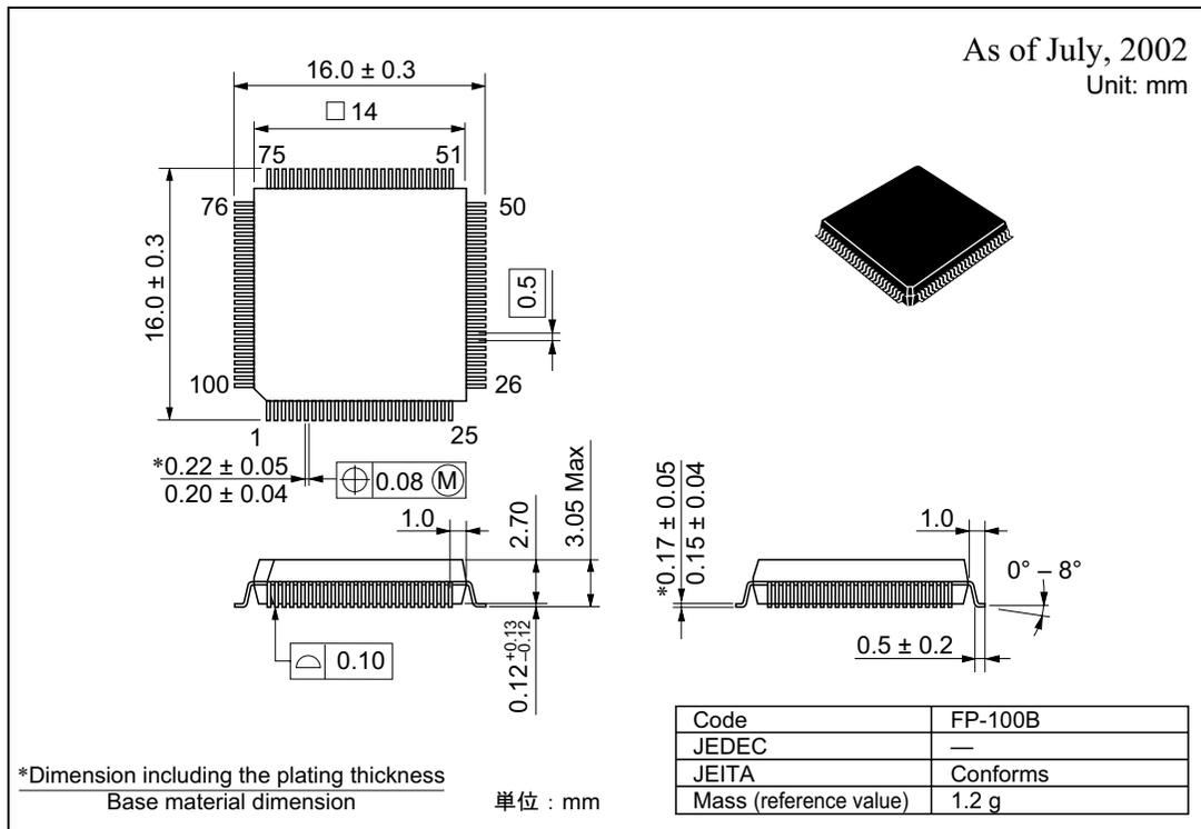
図 G.1 外形寸法図 (FP-100B)
