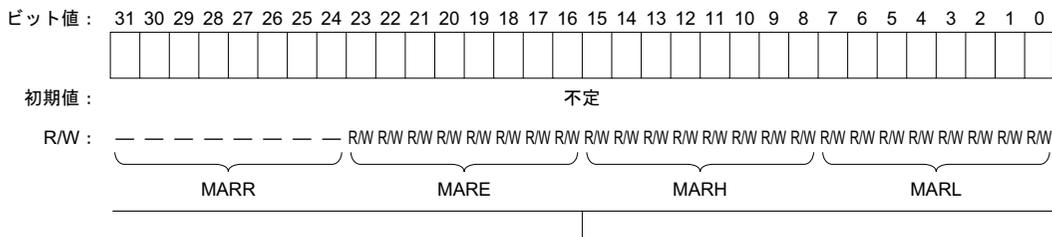
MAR がソースアドレスレジスタとして機能するか、デスティネーションアドレスレジスタとして機能するかは、起動要因によって自動的に決定されます。起動要因が SCI チャンネル 0 の受信完了割り込み、および A/D 変換器の変換終了割り込みの場合はデスティネーションアドレスレジスタとして、それ以外の場合にはソースアドレスレジスタとして機能します。
