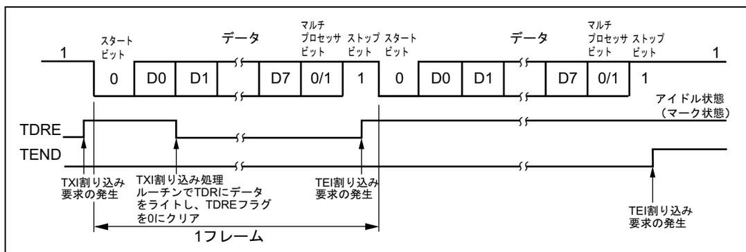
図 13.11 SCI の送信時の動作例
