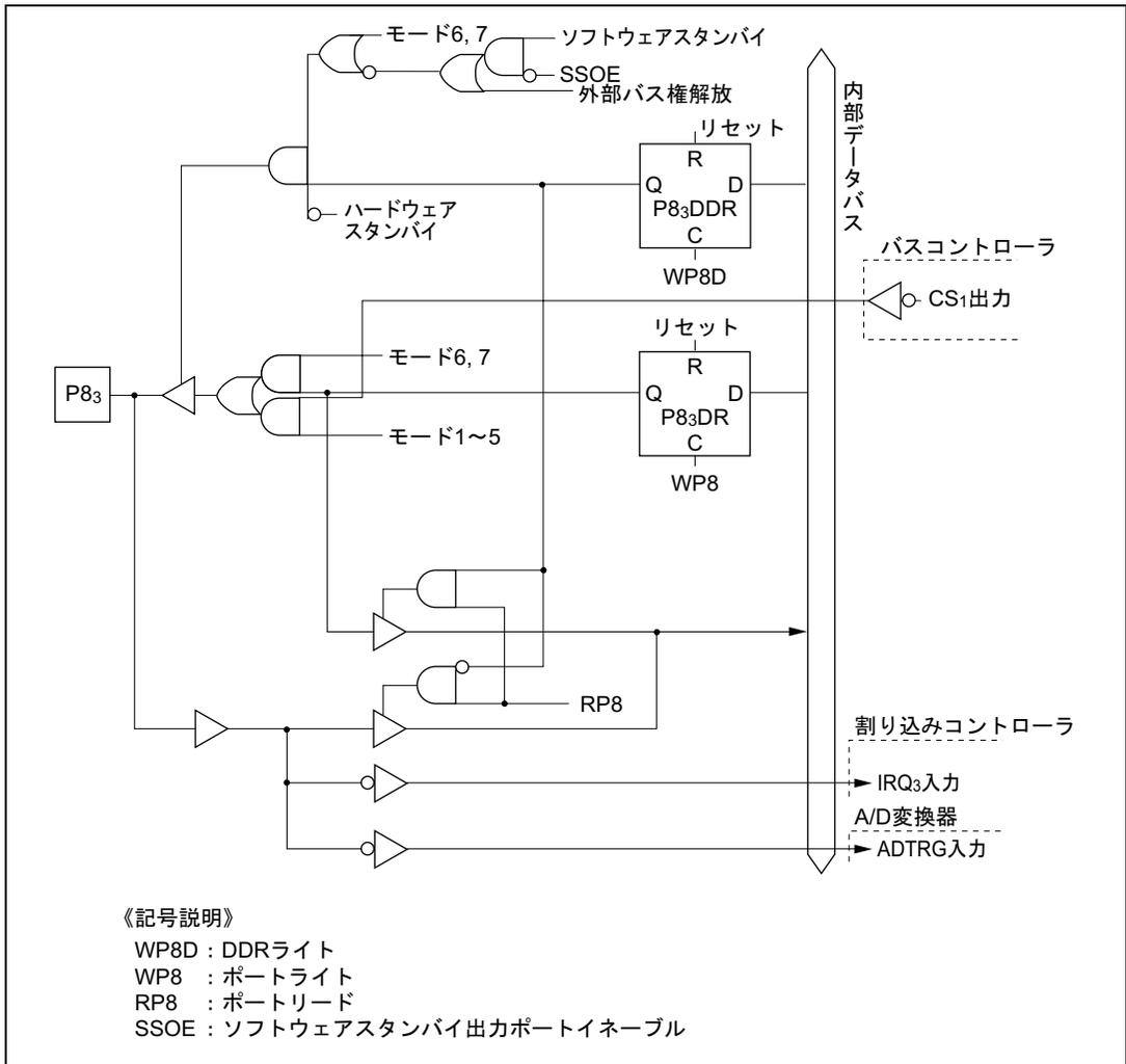
図 C.8 (d) ポート 8 ブロック図 (P8<sub>3</sub> 端子)
