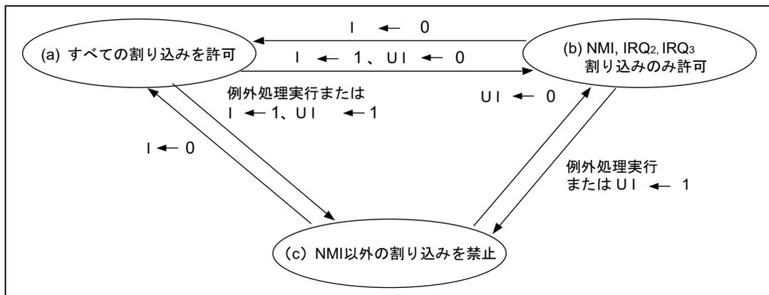
図 5.5 割り込み許可／禁止状態の遷移例
