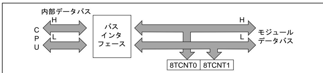
図 10.2 8TCNT のアクセス動作 [CPU→8TCNT (ワード)]
