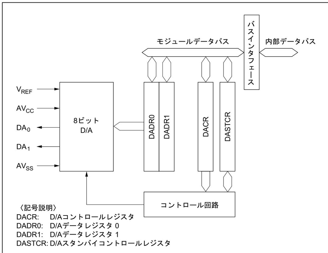
図 16.1 D/A 変換器のブロック図
