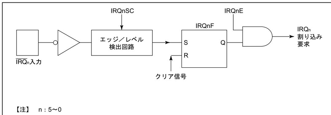
図 5.2 IRQ<sub>0</sub>~IRQ<sub>5</sub>割り込みのブロック図
