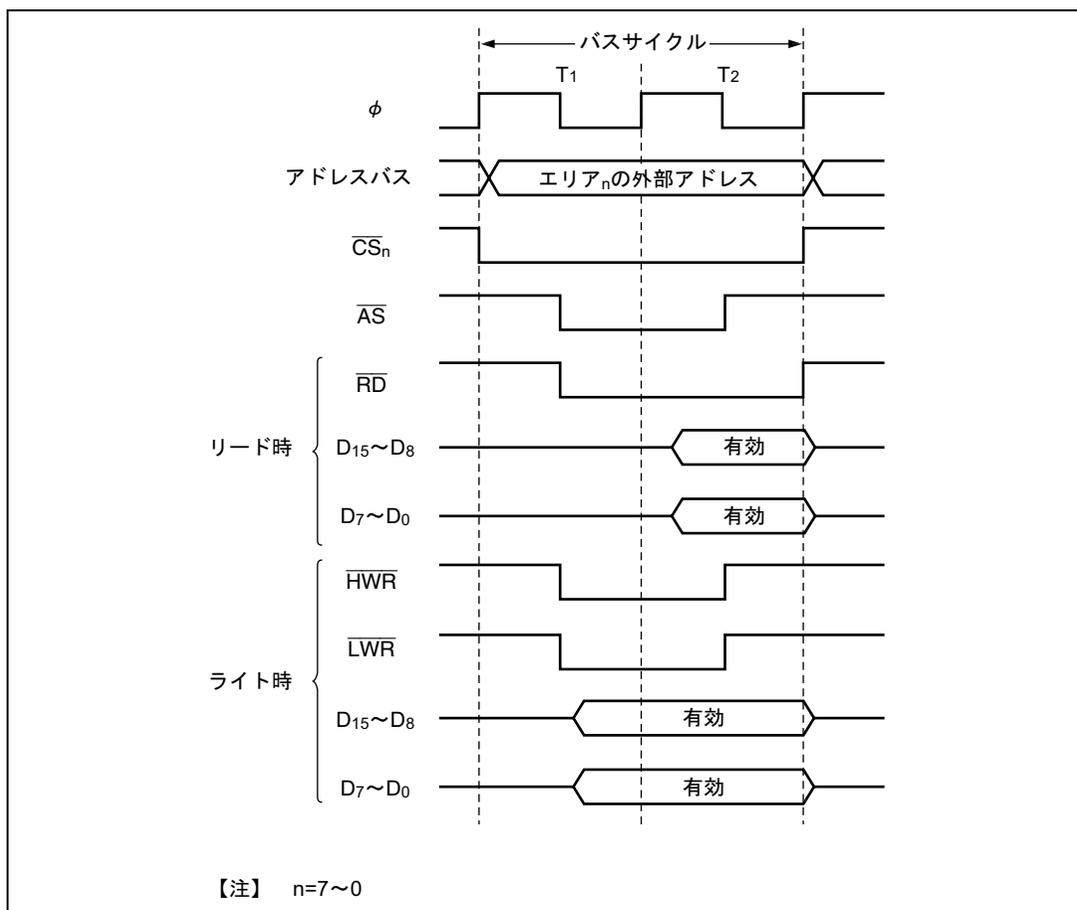
図 6.16 16 ビット 2 ステートアクセス空間のバス制御信号タイミング
