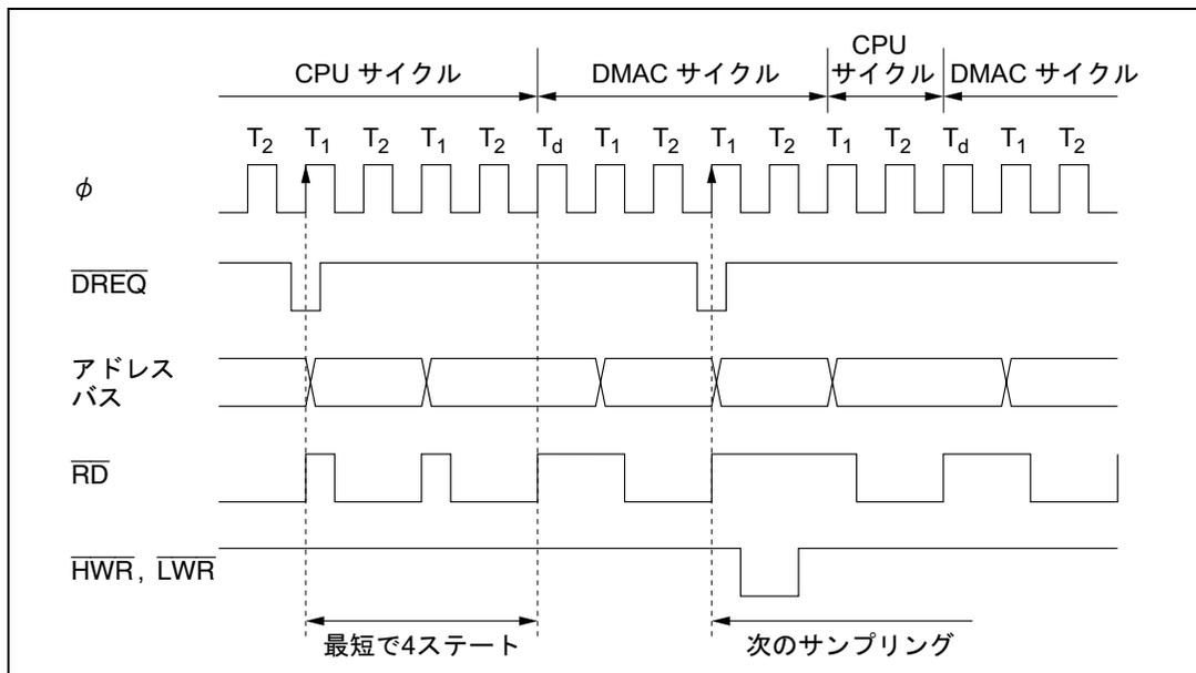
図 7.16 ノーマルモード時の  $\overline{\text{DREQ}}$  端子の立ち下がりエッジで DMAC 起動タイミング
