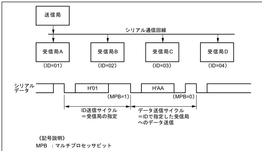
図 13.9 マルチプロセッサフォーマットを使用したプロセッサ間通信の例
