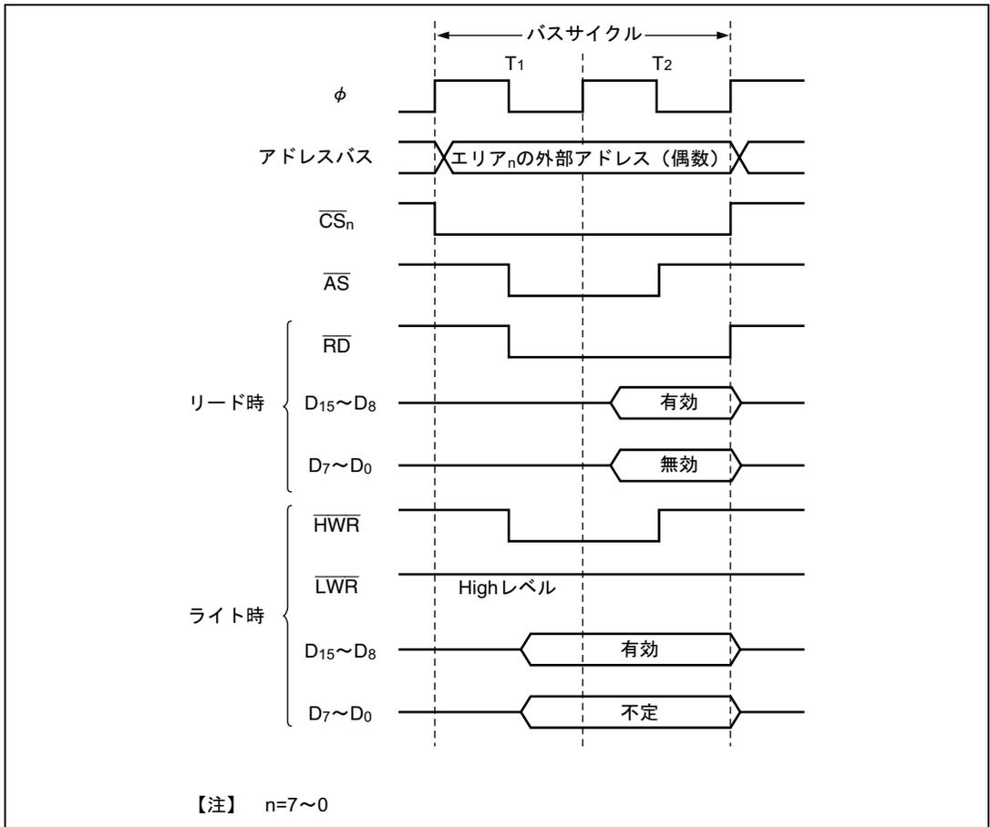
図 6.14 16 ビット 2 ステートアクセス空間のバス制御信号タイミング
