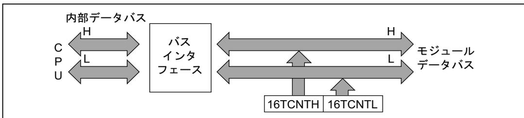
図 9.5 16TCNT のアクセス動作 [16TCNT→CPU (ワード)]
