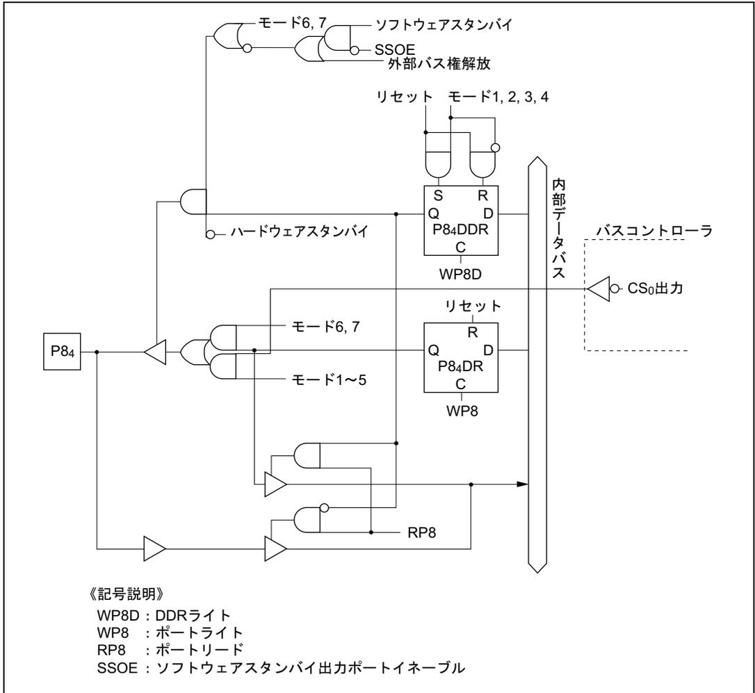
図 C.8 (e) ポート 8 ブロック図 (P8<sub>4</sub> 端子)
