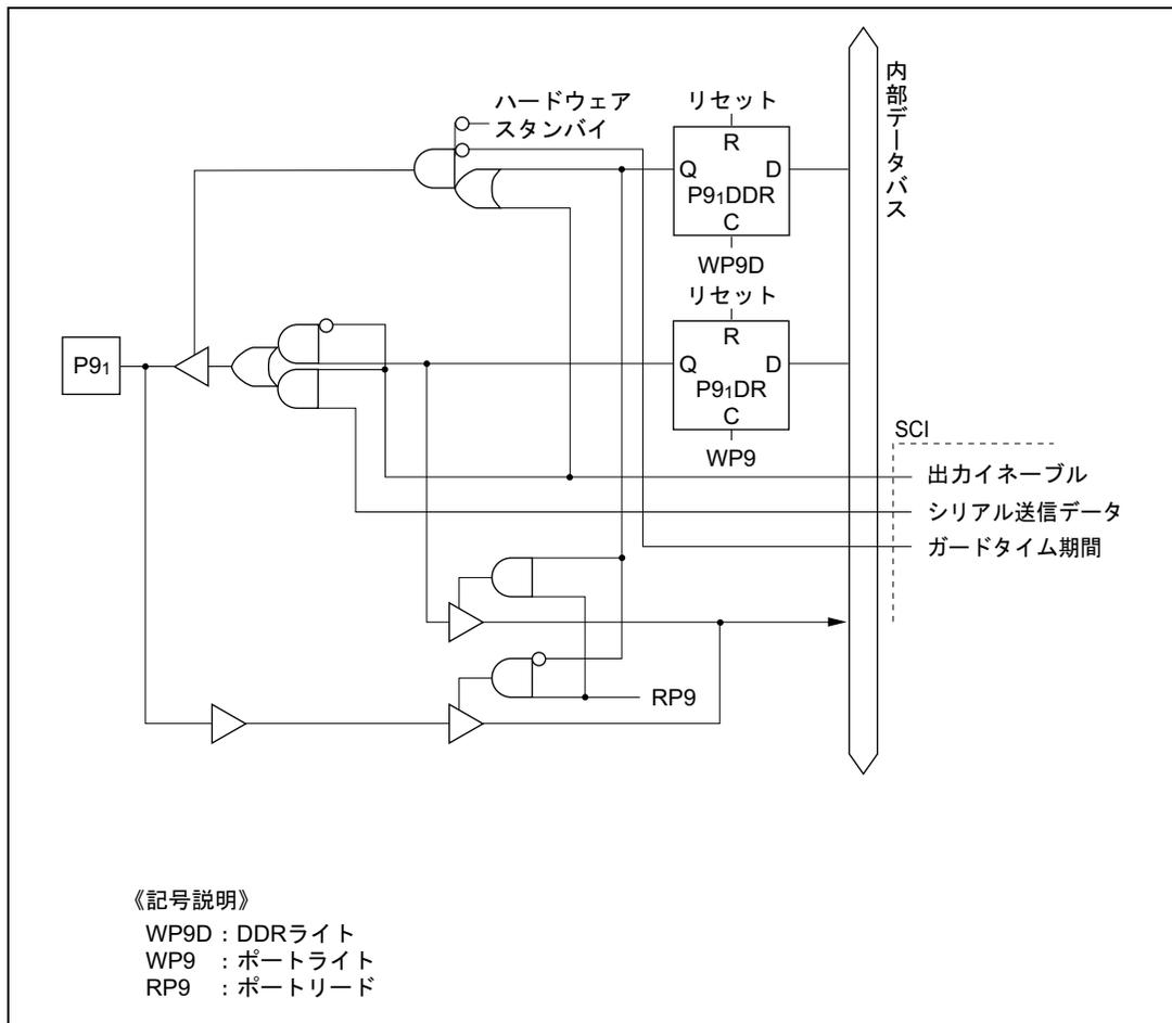
図 C.9 (b) ポート 9 ブロック図 (P9<sub>1</sub> 端子)
