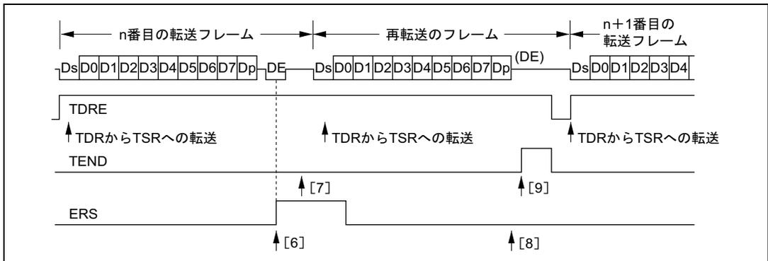
図 14.13 SCI 送信モードの場合の再転送動作
