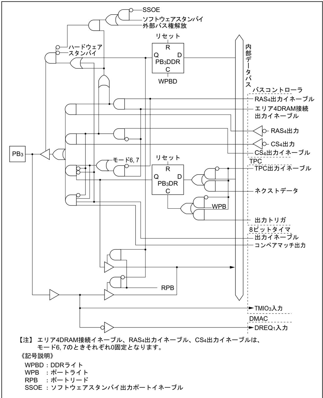
図 C.11 (d) ポート B ブロック図 (PB<sub>3</sub> 端子)
