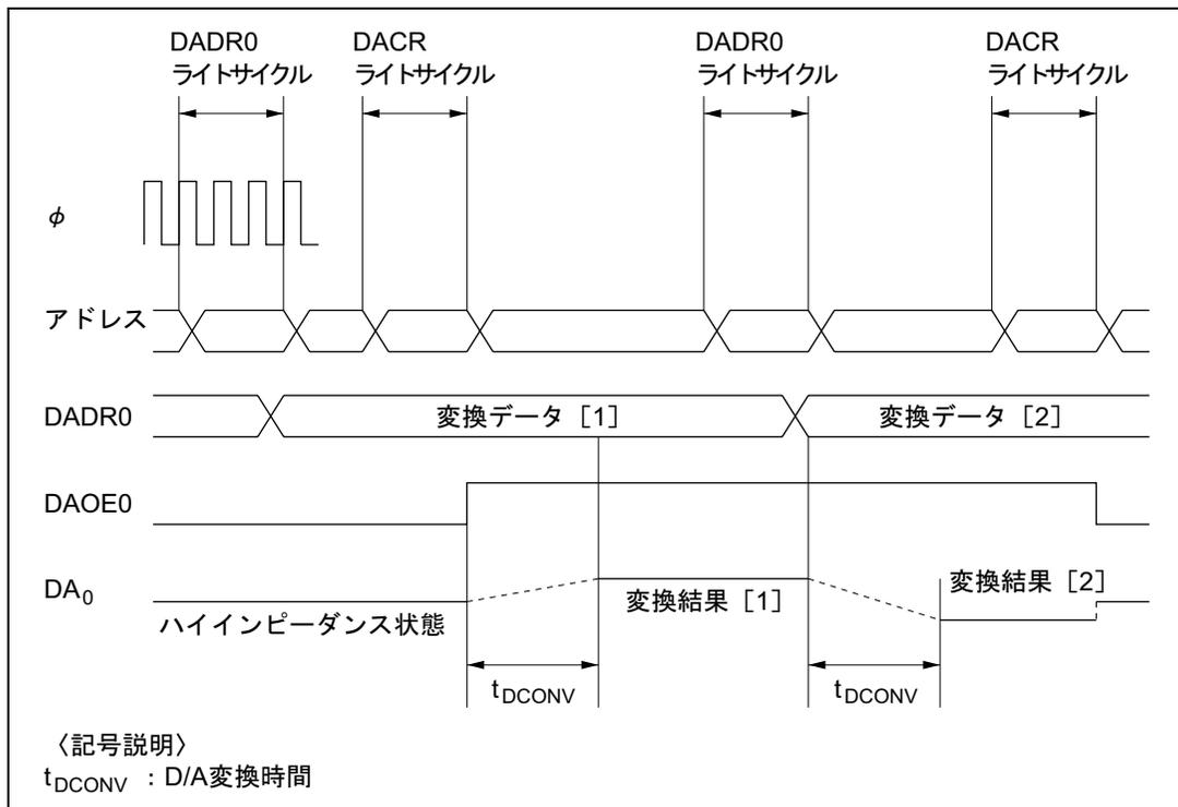
図 16.2 D/A 変換器の動作例
