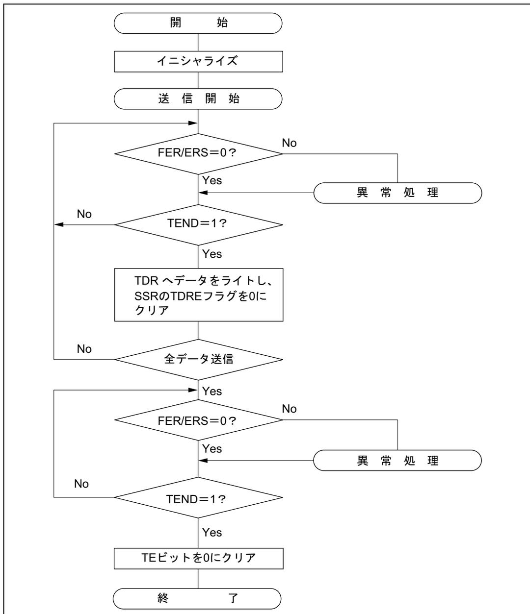
図 14.5 送信処理フローの例
