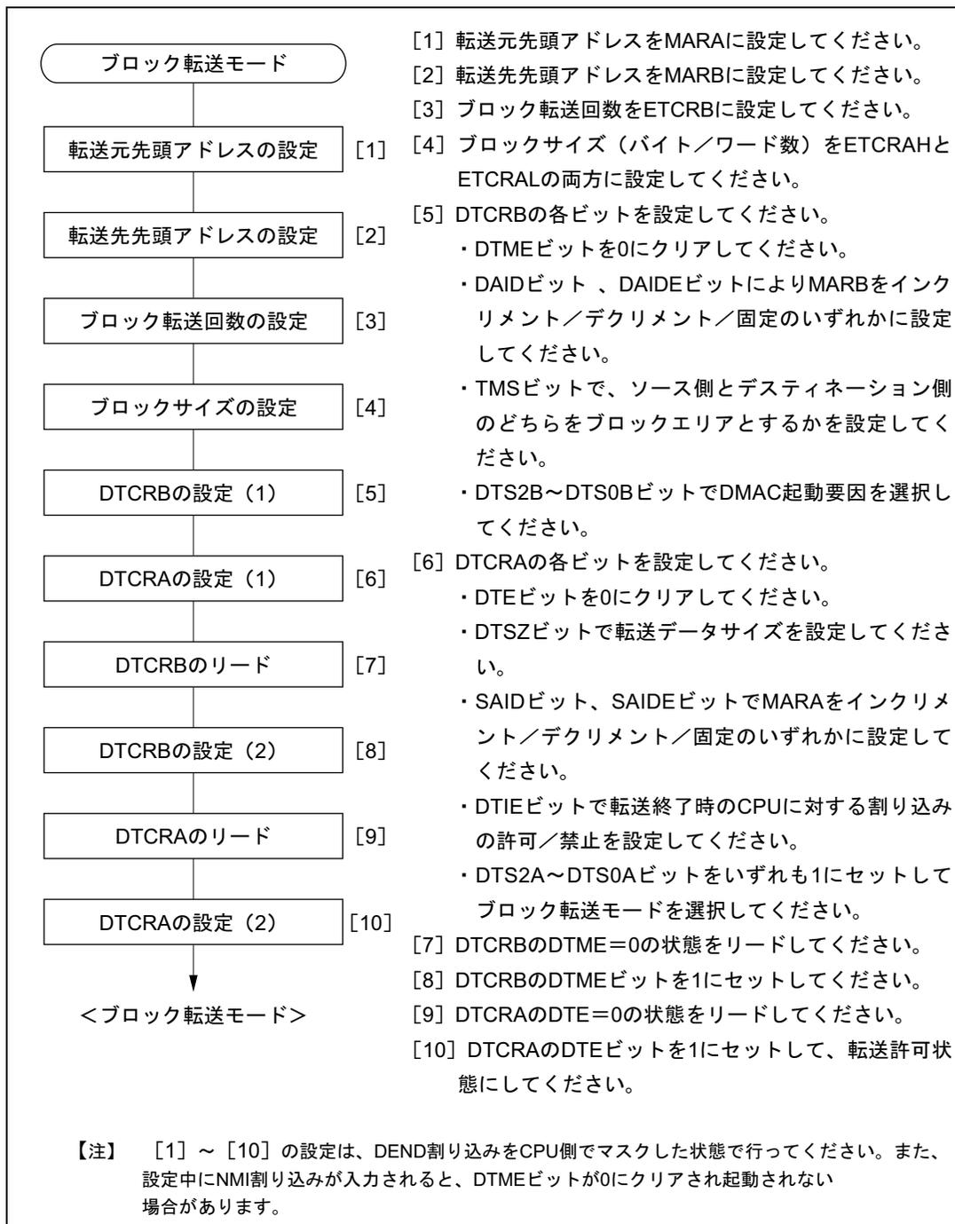
図 7.12 ブロック転送モードの設定手順例
