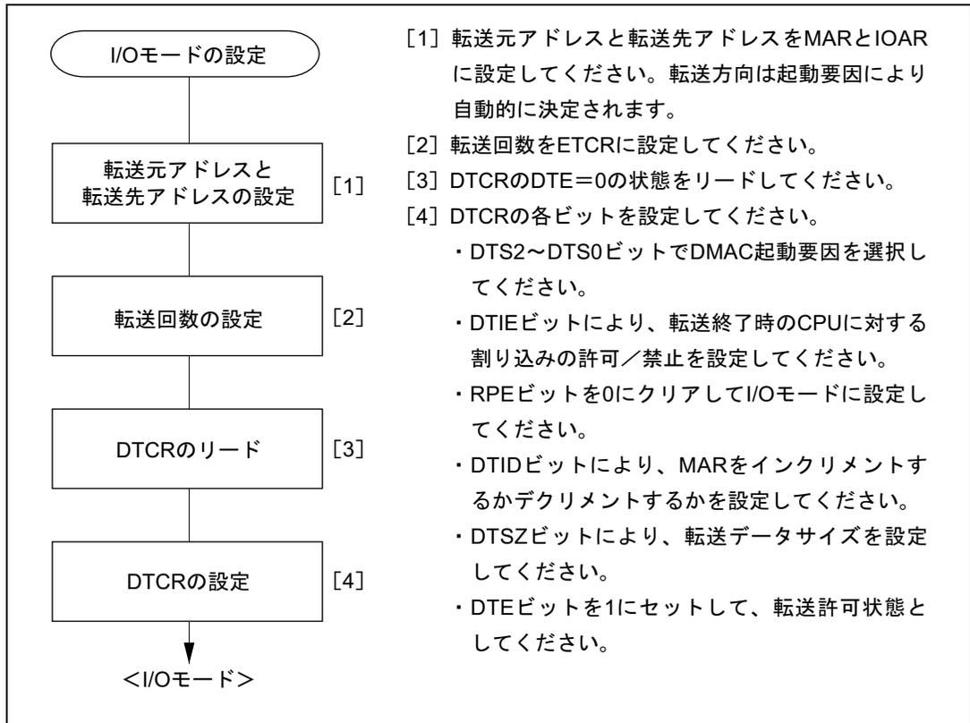
図 7.3 I/O モードの設定手順例
