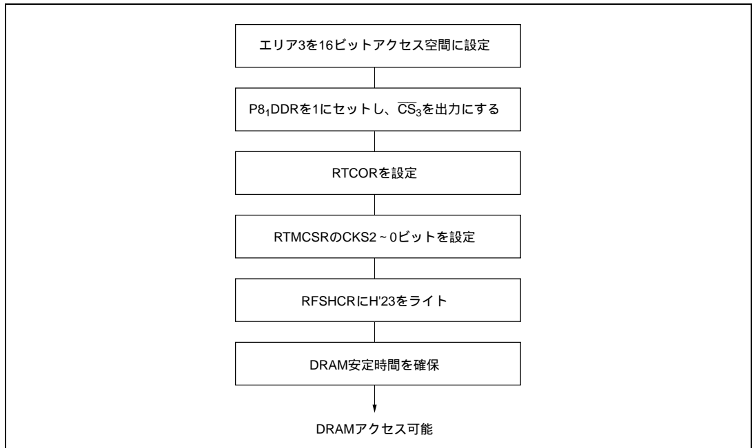
図 7.8 2WE 方式 1M ビット DRAM の設定順序 (1M バイトモード)
