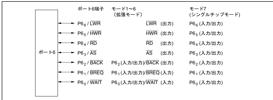
図 9.6 ポート 6 の端子構成
