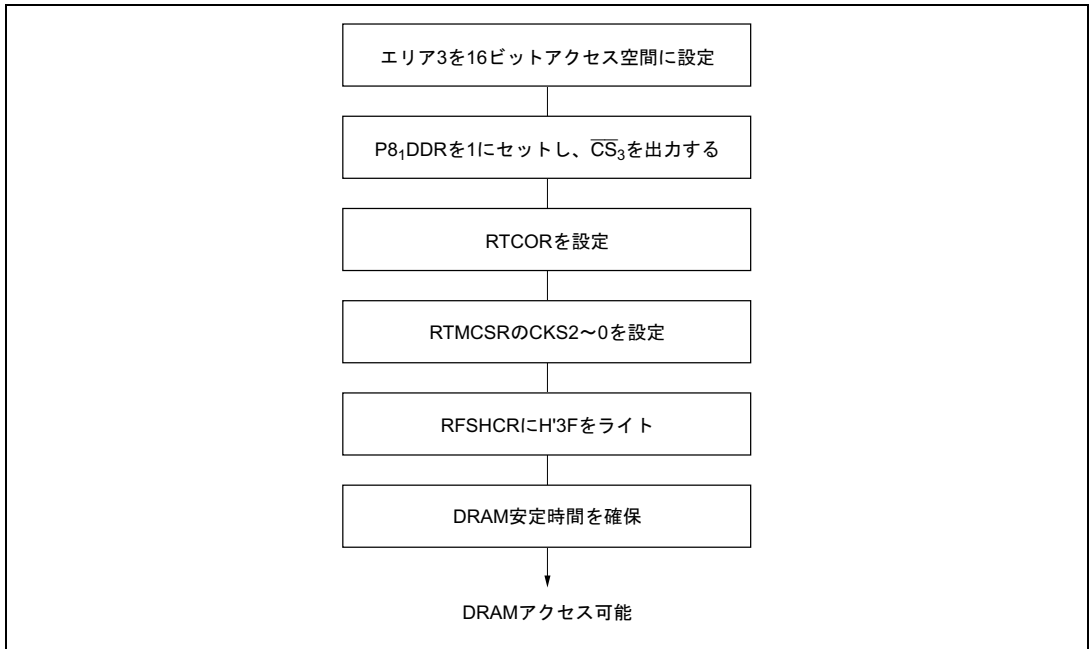
図 7.14 複数チップの 2CAS 方式 4M ビット DRAM (9 ビットロウアドレス×9 ビットコラムアドレスの場合) の設定順序 (16M バイトモード)
