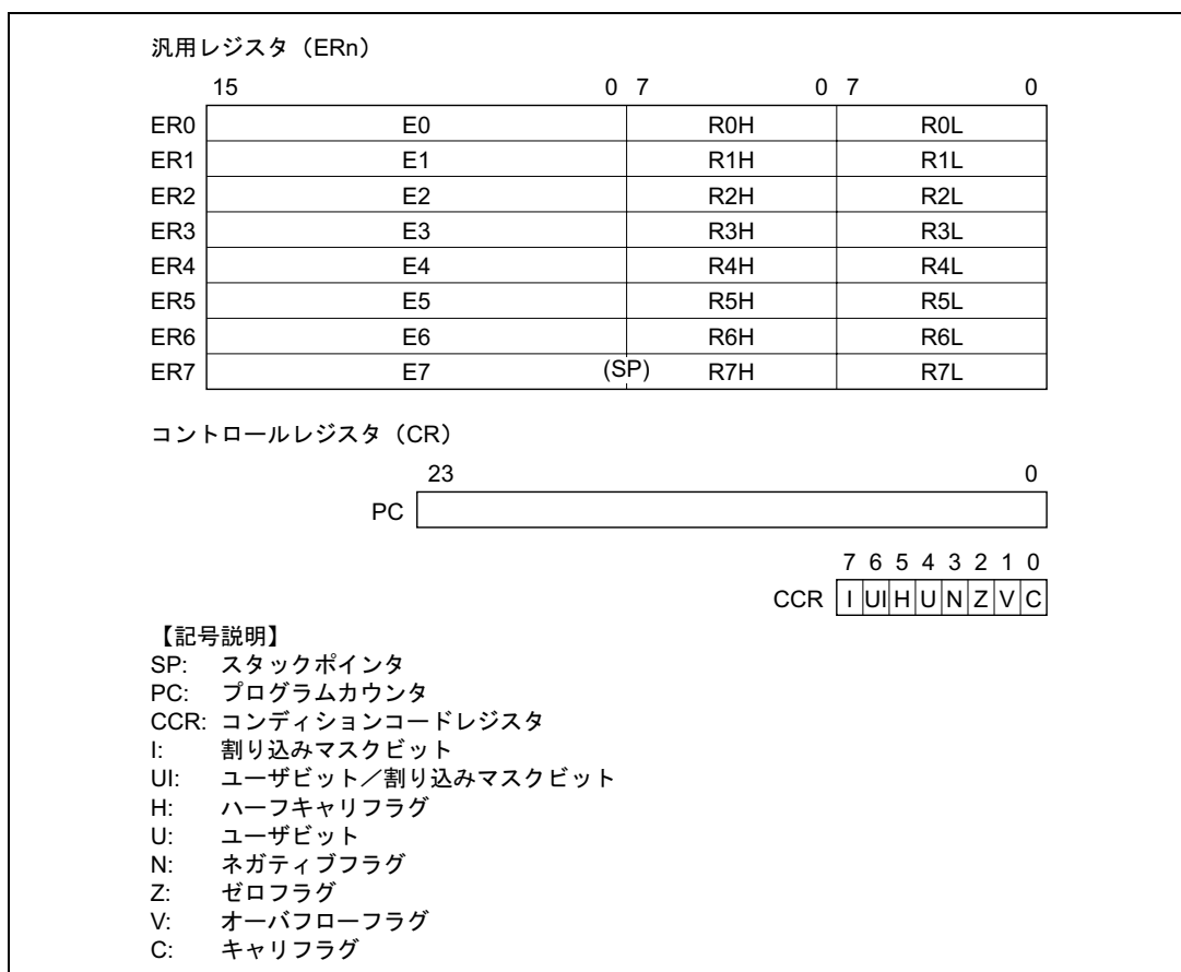
図 2.3 CPU 内部レジスタ構成
