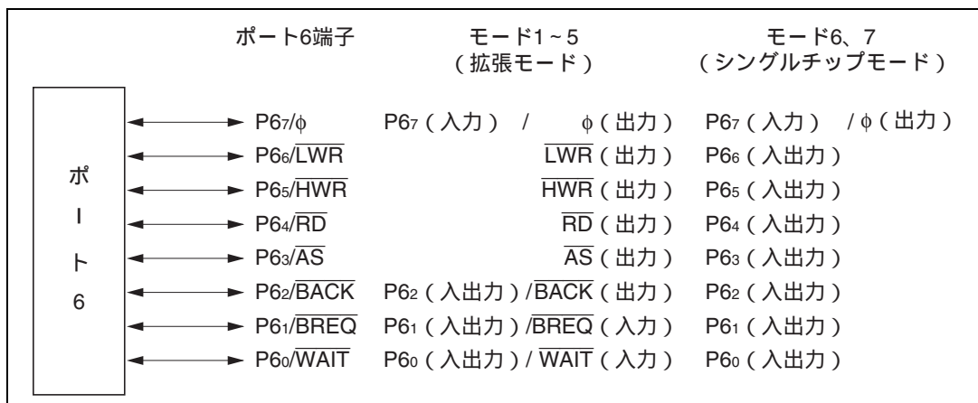
図 8.6 ポート6の端子構成
