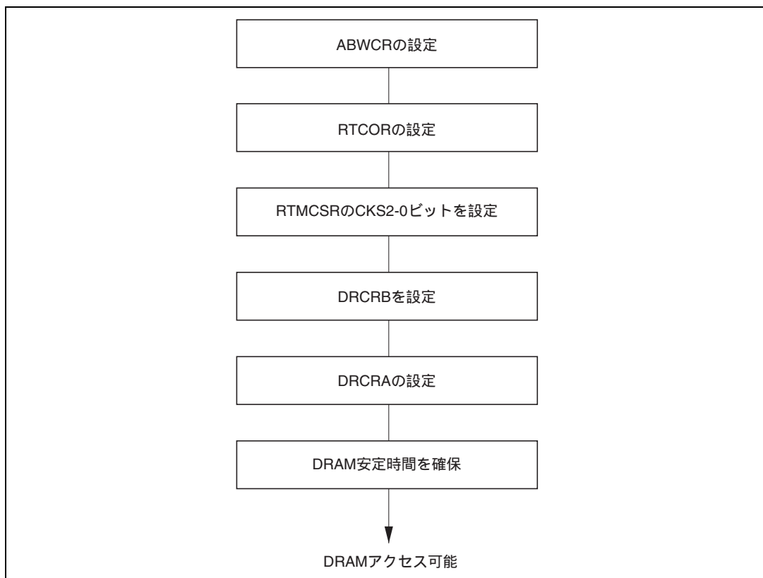
図 6.34 DRAM インタフェースの使用時の設定手順例
