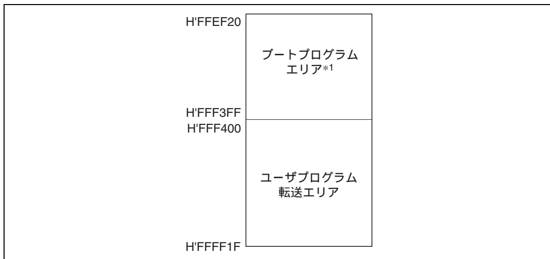
図 18.8 ブートモード時の RAM エリア
