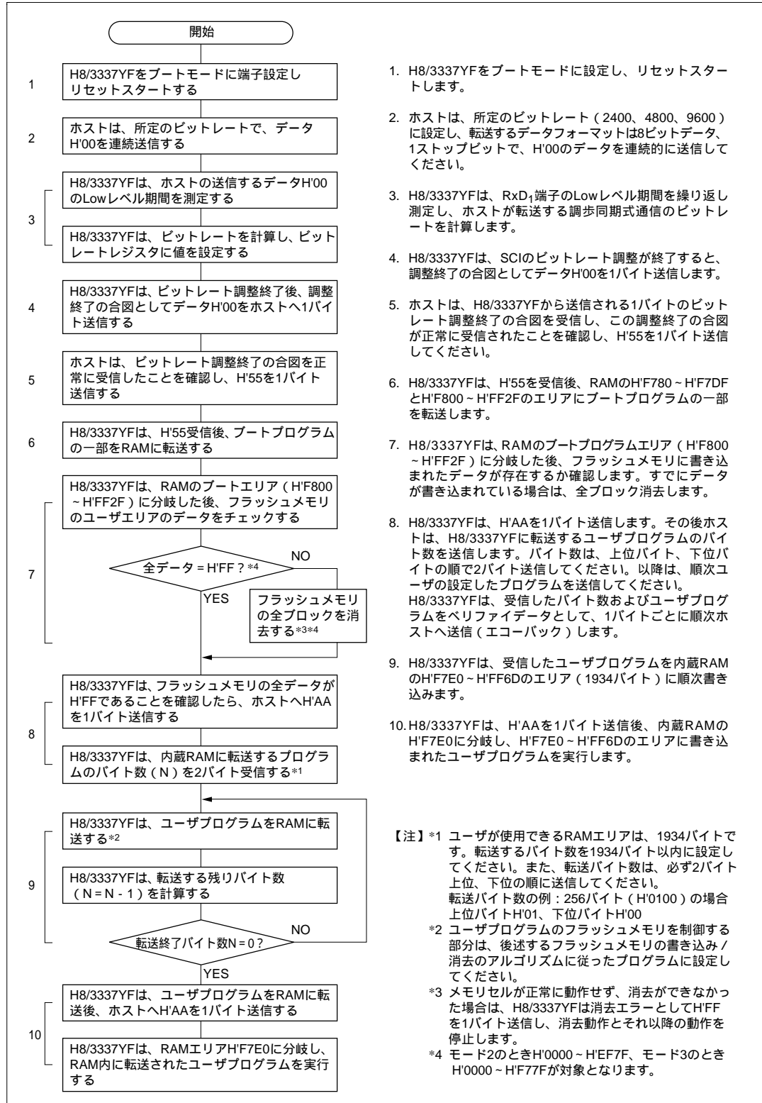
図 20.4 ブートモードの動作フローチャート
