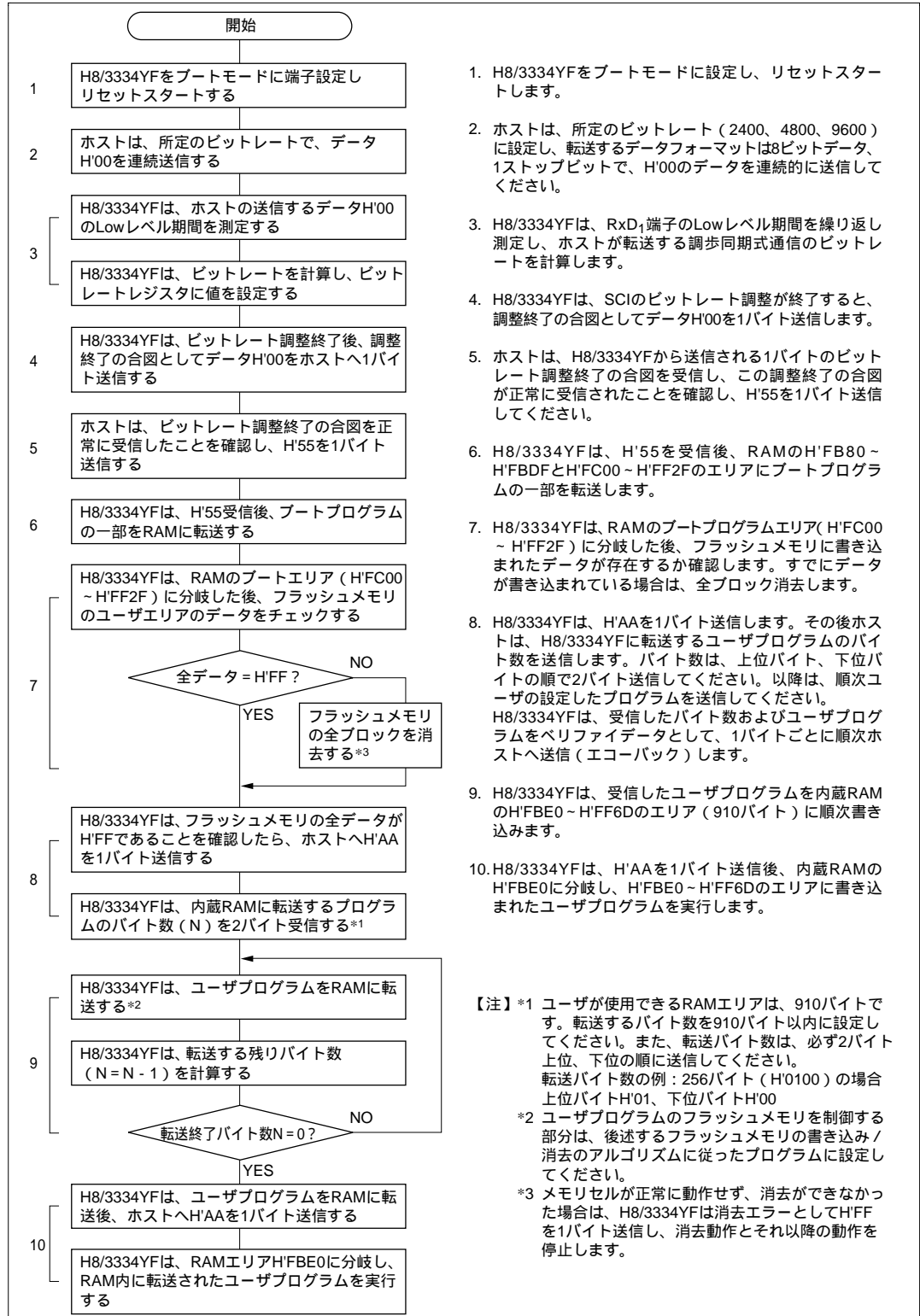
図 19.4 ブートモードの動作フローチャート
