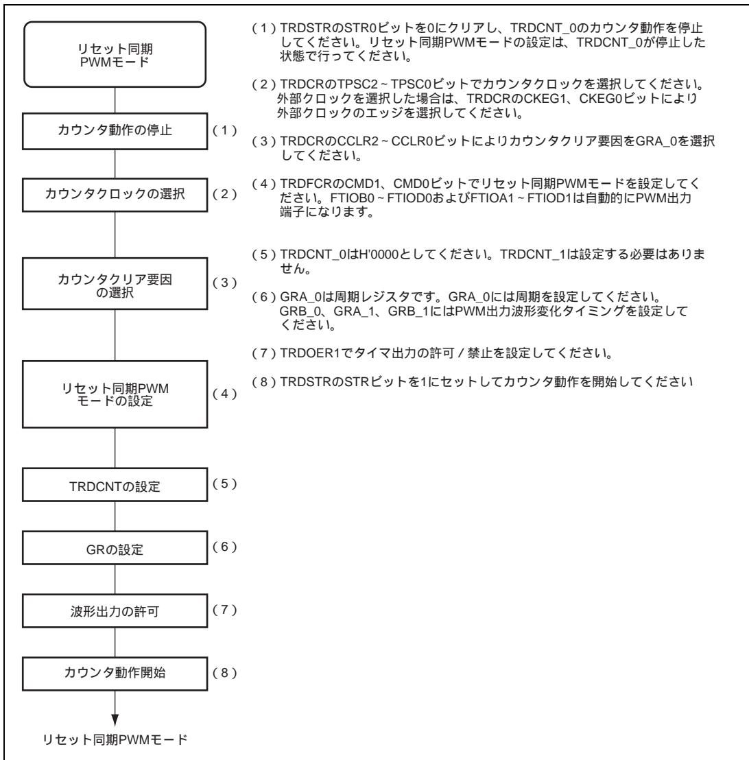
図 14.29 リセット PWM モードの設定手順例
