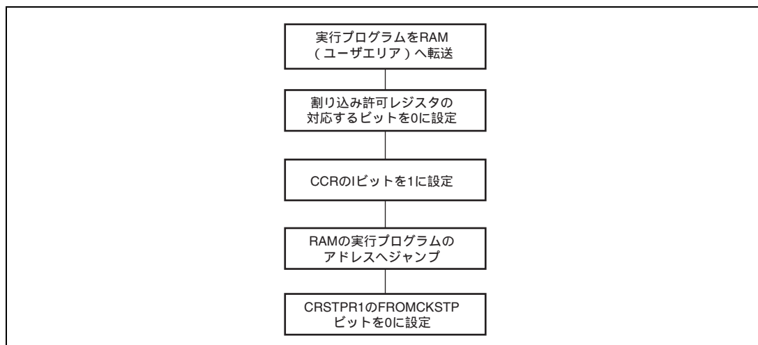
図 7.5 モジュールスタンバイモードの設定方法
