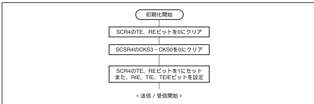
図 16.3 SCI4 を初期化するときのフローチャートの例
