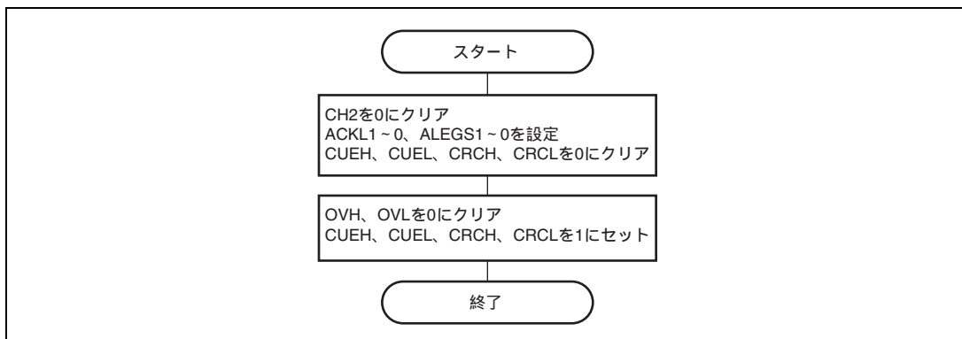
図 13.2 16 ビットカウンタとして使用する場合のソフトウェア手順
