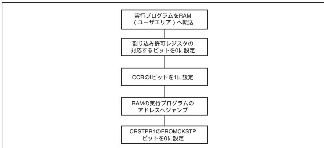
図 7.6 モジュールスタンバイモードの設定方法（RAMエミュレーションを使用しない場合）
