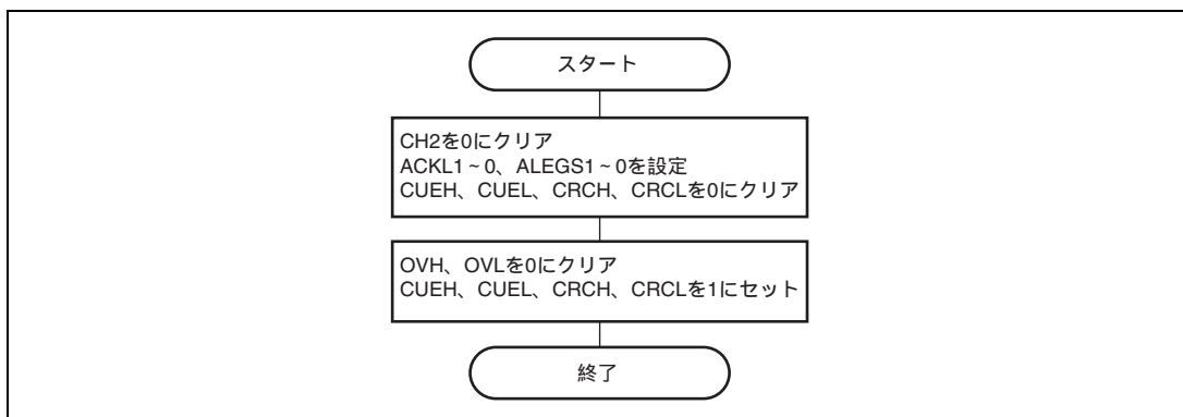
図 15.2 16 ビットカウンタとして使用する場合のソフトウェア手順
