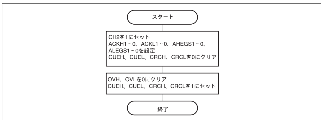
図 15.3 8 ビットカウンタとして使用する場合のソフトウェア手順
