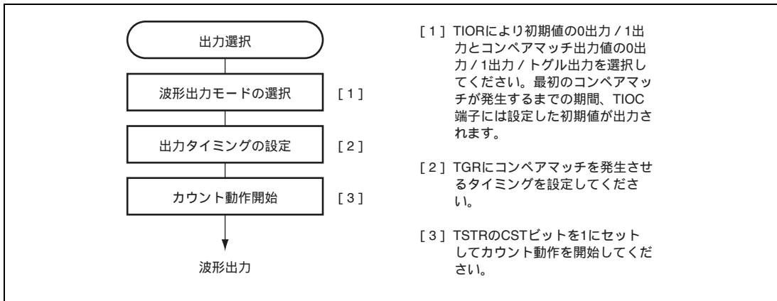
図 14.8 コンペアマッチによる波形出力動作例
