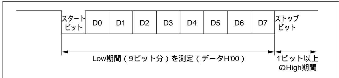
図 19.9 SCI ビットレート自動合わせ込み時の RxD0 入力信号
