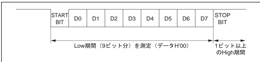
図 17.42 SCI ビットレートの自動合わせ込み動作
