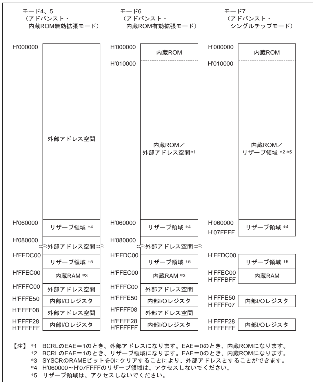
図 3.7 H8S/2314 の各動作モードのアドレスマップ (1)
