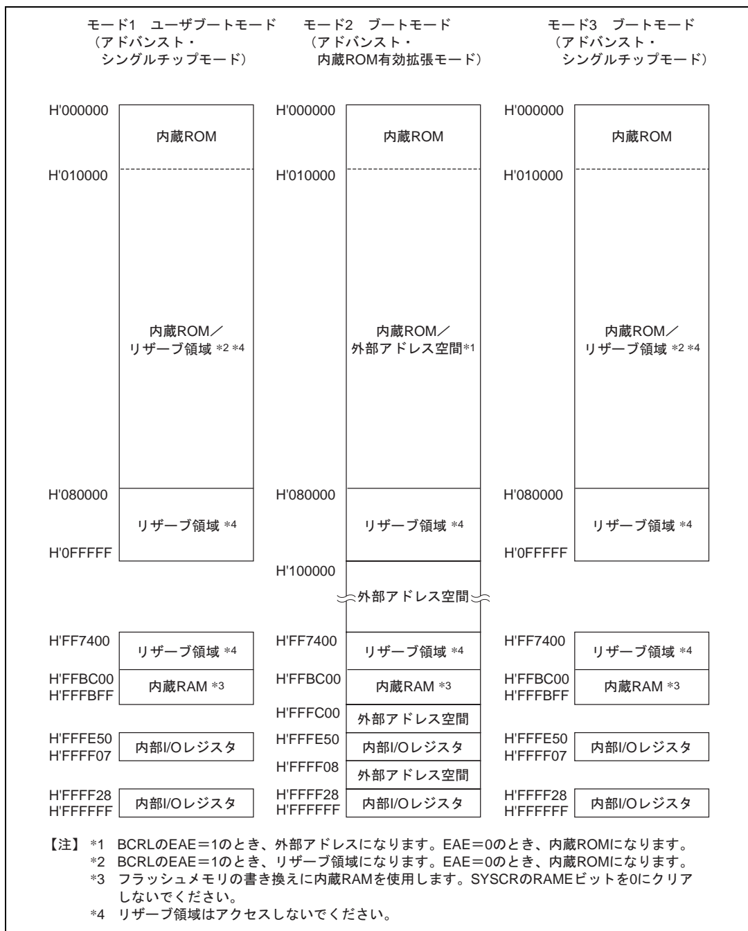
図 3.2 H8S/2319C F-ZTAT の各動作モードのアドレスマップ (1)
