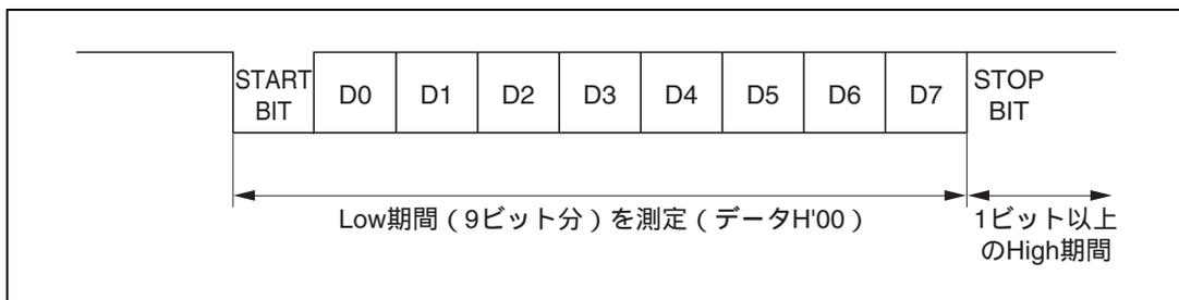
図 22.9 SCI ビットレートの合わせ込み動作
