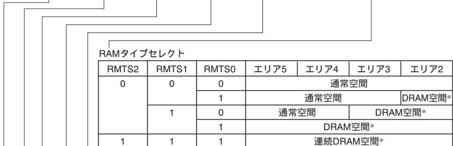
【注】 DRAM空間に選択したエリアが全エリア8ビット空間のとき、PF2端子は入力ポート、BREQQ、WAITとして使用可能です。また、連続DRAM空間を選択したときは、エリア2からエリア5に相当するバス幅、アクセスステート数（プログラマブルウェイト数）は同じ値に設定してください。上記以外の組み合わせは設定しないでください。
