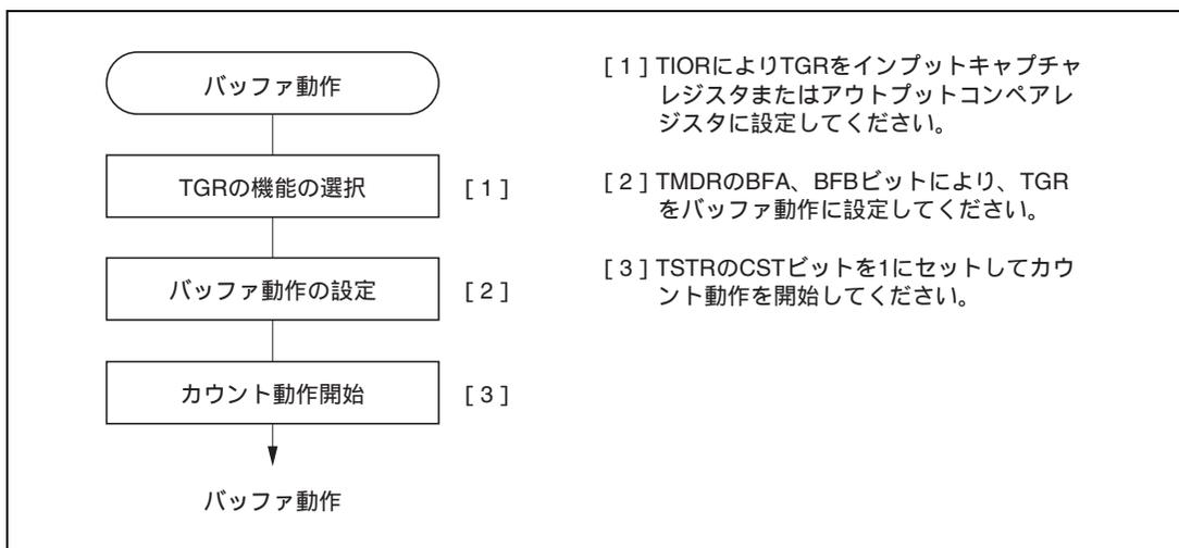
図 11.18 バッファ動作の設定手順例
