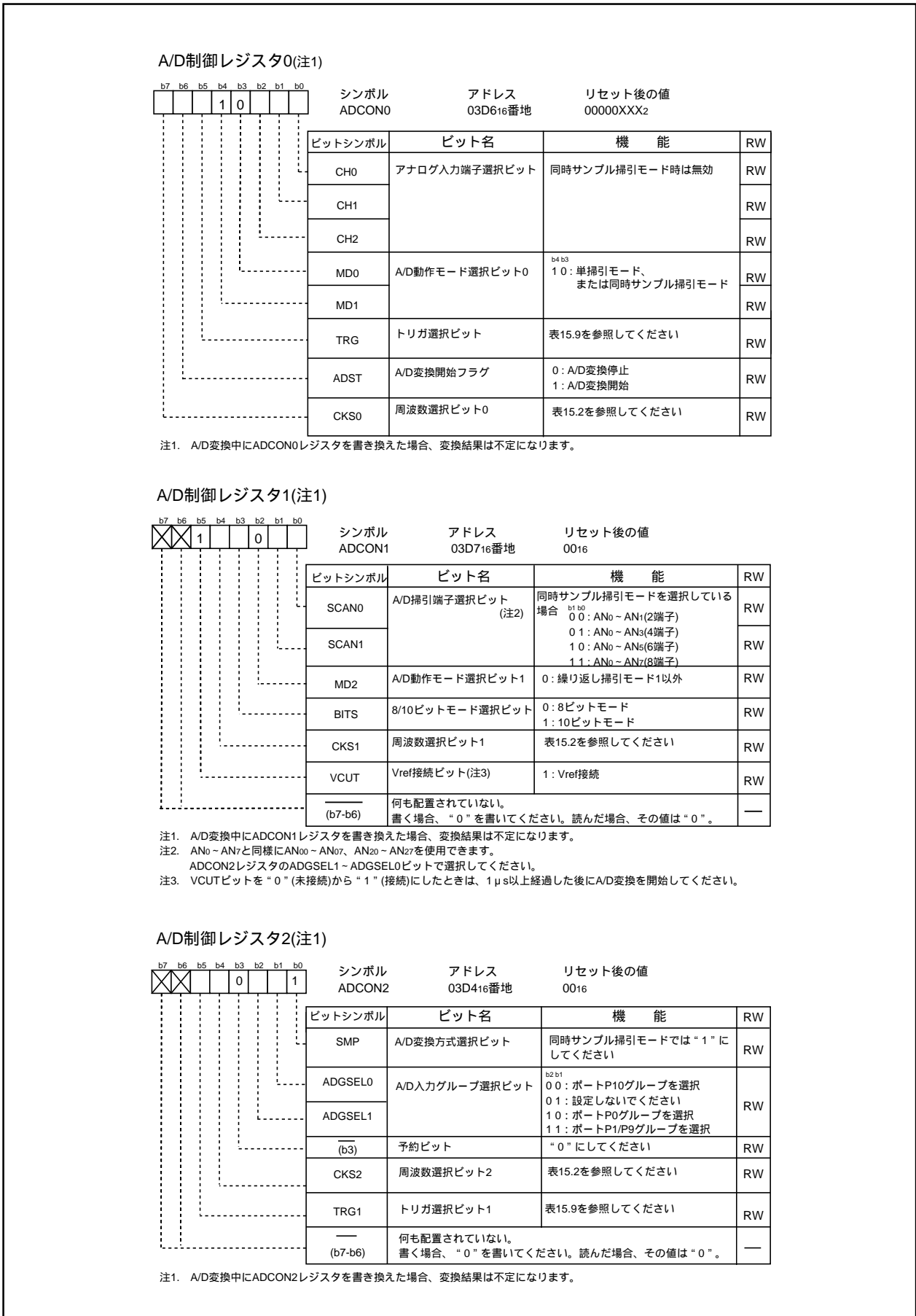
図15.17 同時サンプル掃引モード時のADCON0~ADCON2レジスタ
