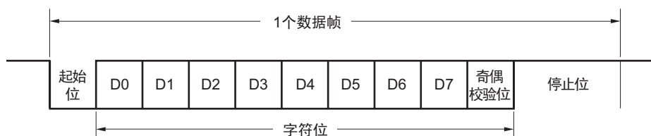
图 13-6 正常 UART 发送 / 接收数据的格式
