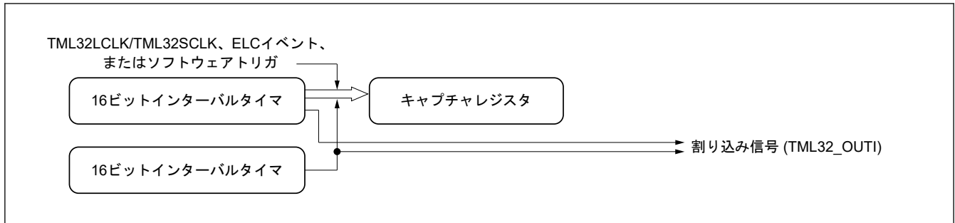
図 19.3 16 ビットインターバルタイマと 16 ビットキャプチャの機能イメージ
