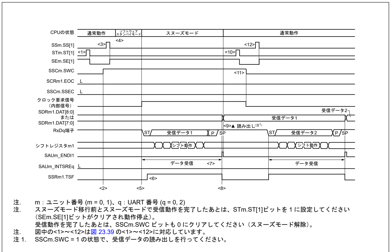
図 23.37 スヌーズモード動作のタイミング (SCRm1.EOC = 0, SSCm.SSEC = 0/1)
