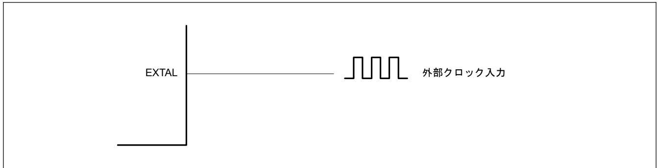
図 8.5 外部クロックの等価回路
