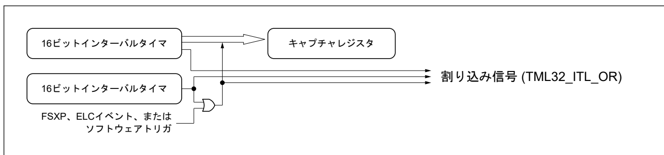
図 18.3 16 ビットインターバルタイマと 16 ビットキャプチャの機能イメージ
