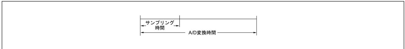
図 25.35 A/D 変換時間のサンプリング時間
