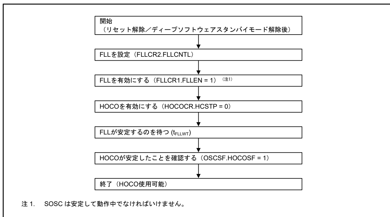
図 9.4 FLL 設定フロー (リセット解除後/ディープソフトウェアスタンバイモード解除後)
