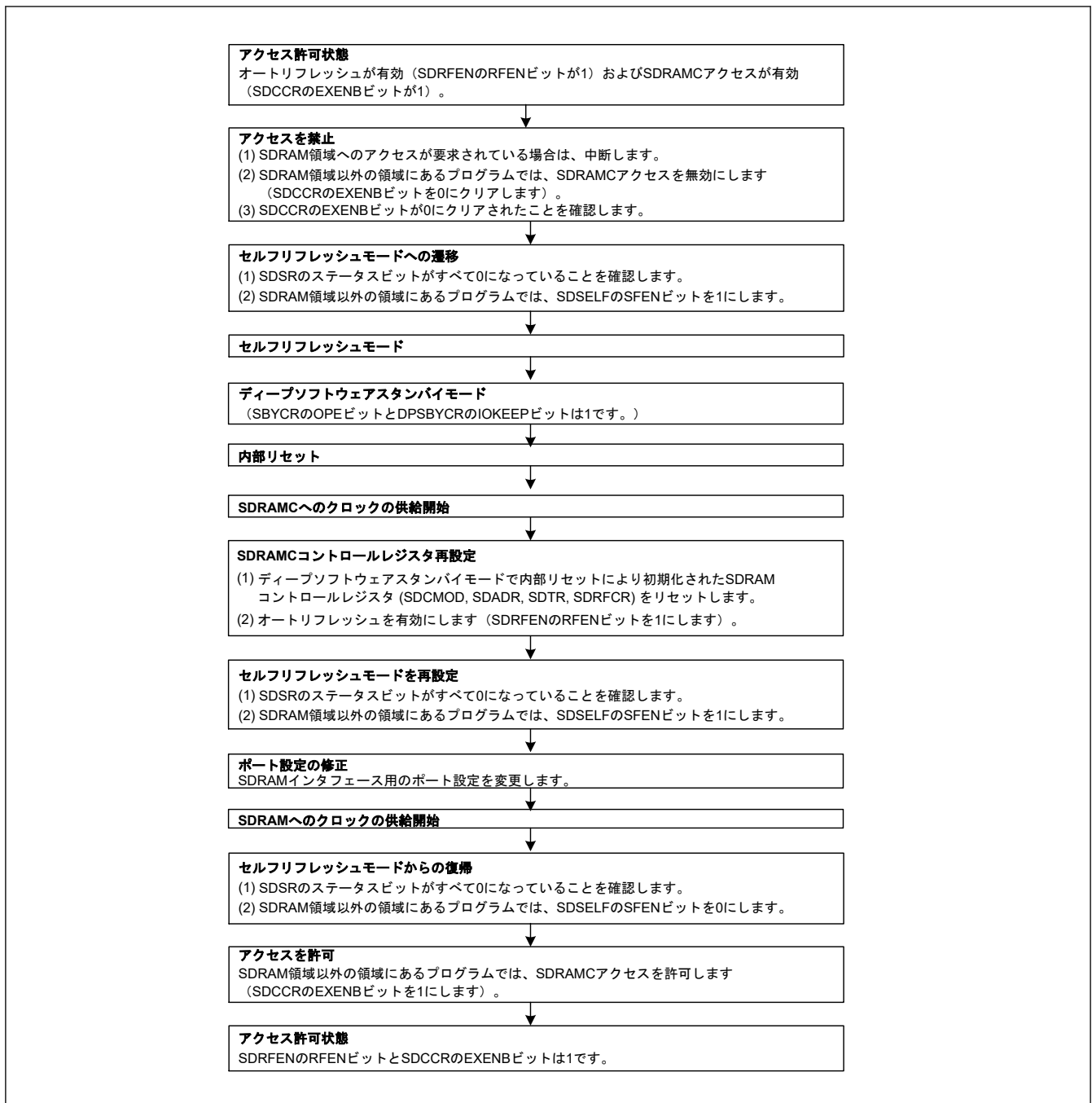
図 14.51 ディープソフトウェアスタンバイモードでのセルフリフレッシュモード遷移/復帰手順
