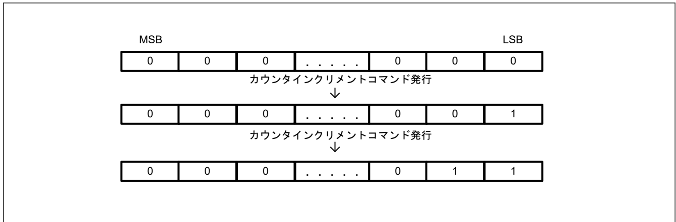
図 49.43 アンチロールバックカウンタのインクリメントのイメージ
