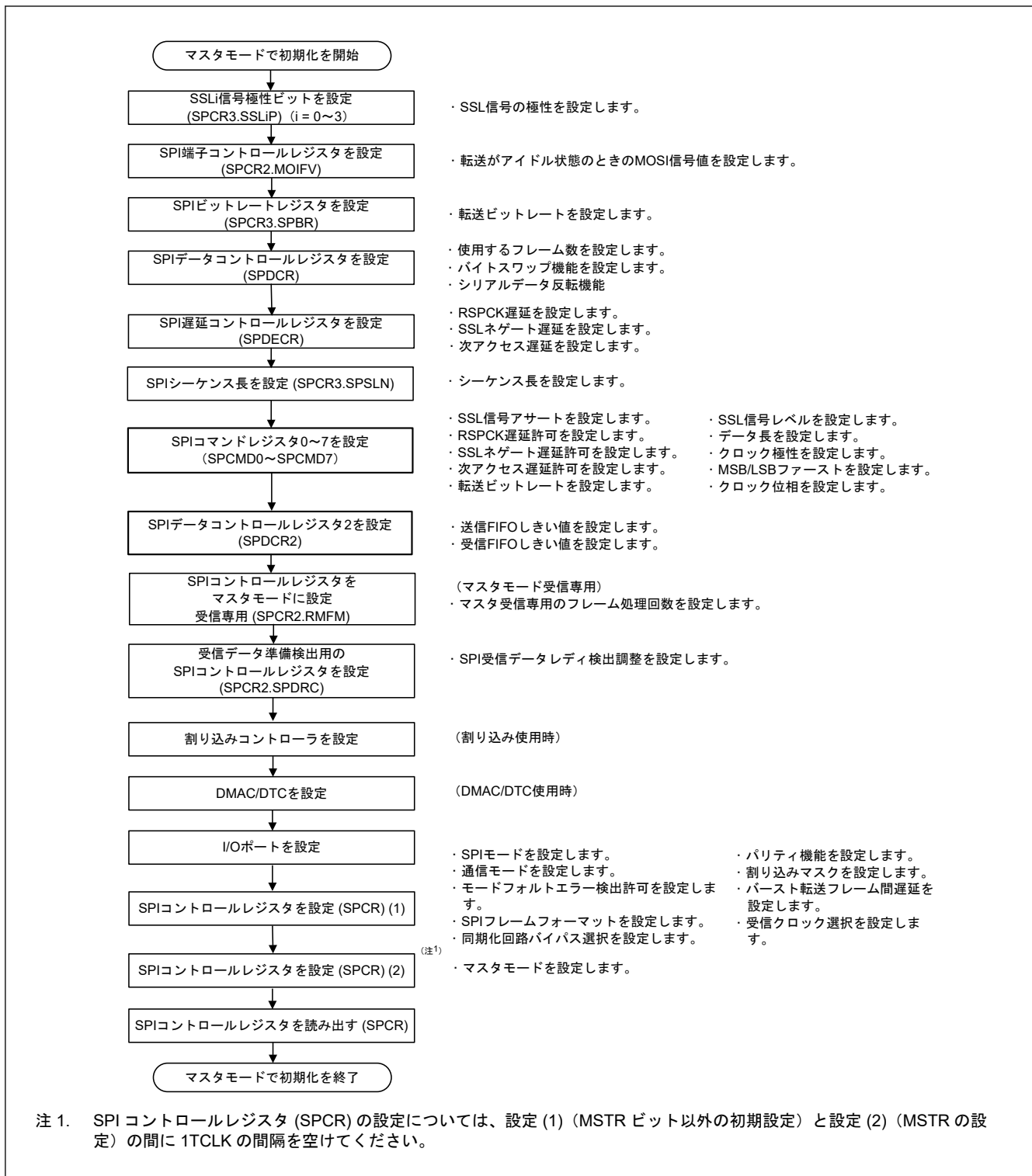
図 34.63 マスターモード時の SPI 動作の初期化フロー例
