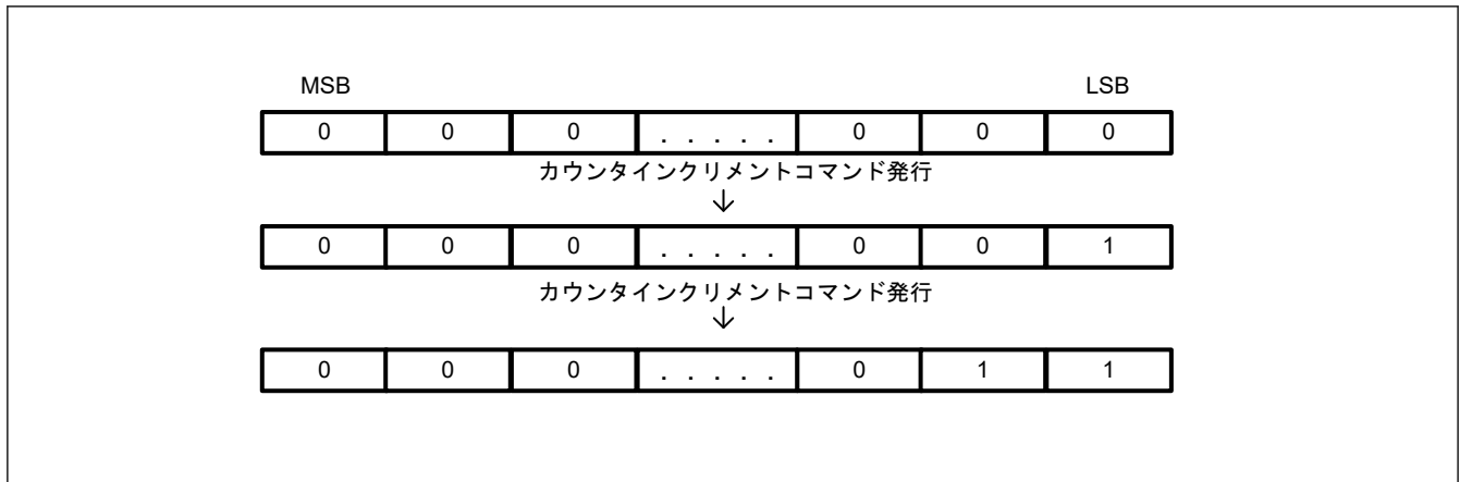
図 47.43 アンチロールバックカウンタのインクリメントのイメージ
