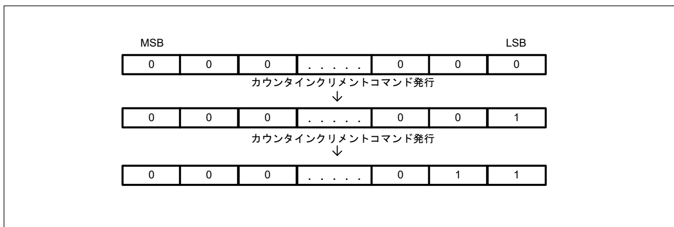
図 52.43 アンチロールバックカウンタのインクリメントのイメージ
