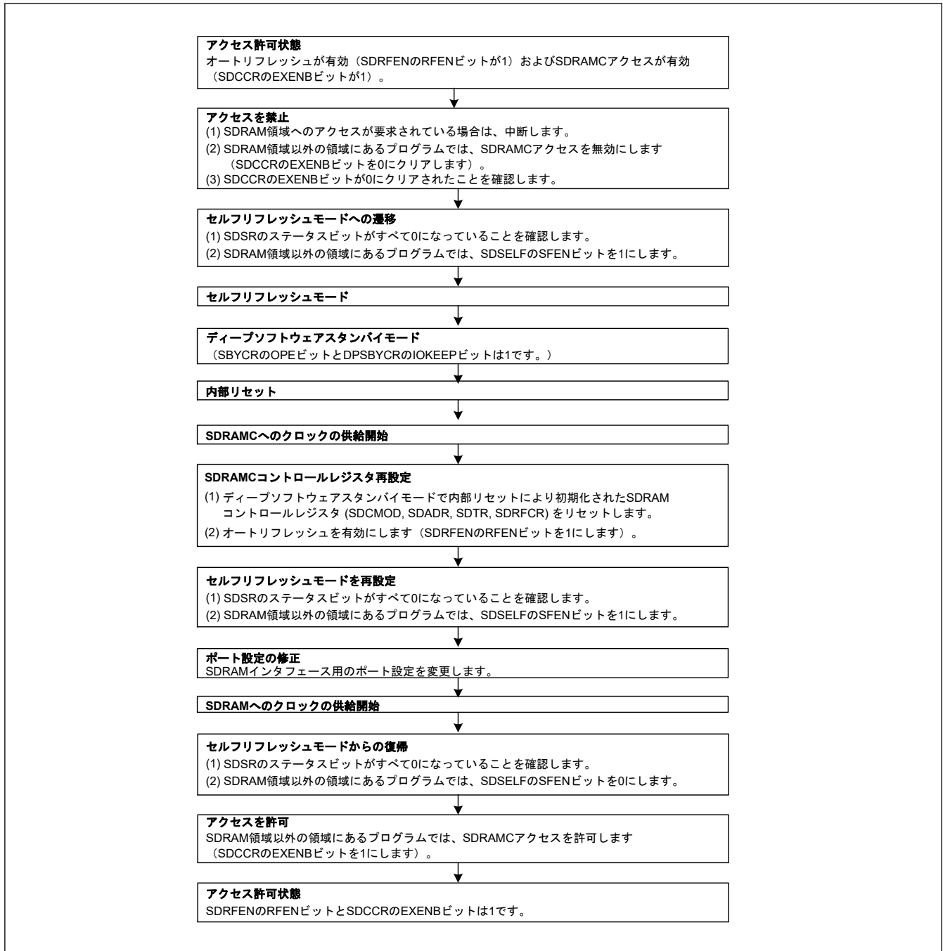
図 13.51 ディープソフトウェアスタンバイモードでのセルフリフレッシュモード遷移/復帰手順
