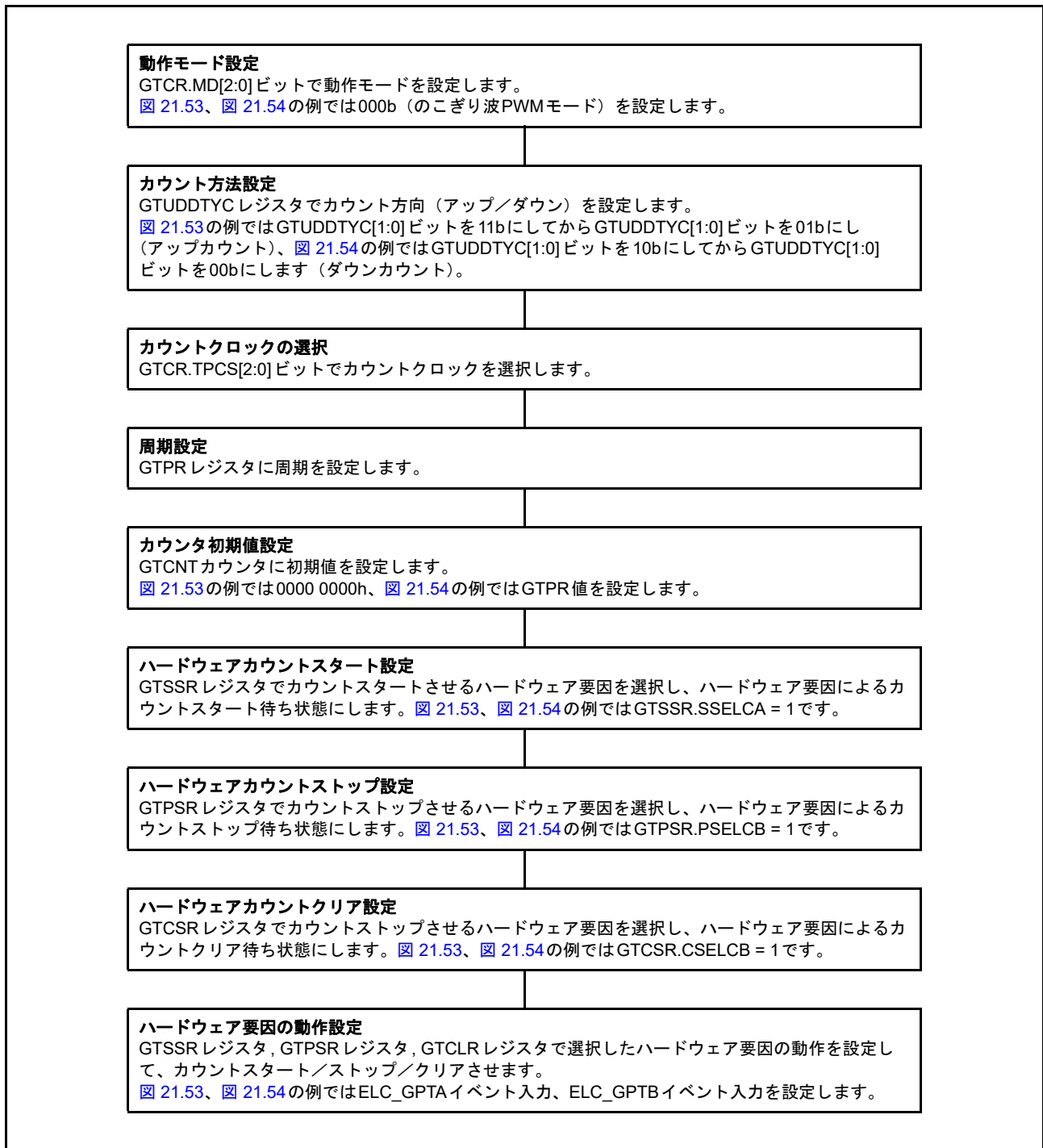
図 21.55 ハードウェア要因によるカウンタクリア動作設定例
