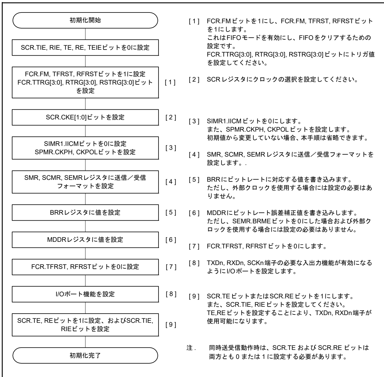
図 27.33 クロック同期式モードにおける SCI の初期化フローチャート例 (FIFO 選択時)
