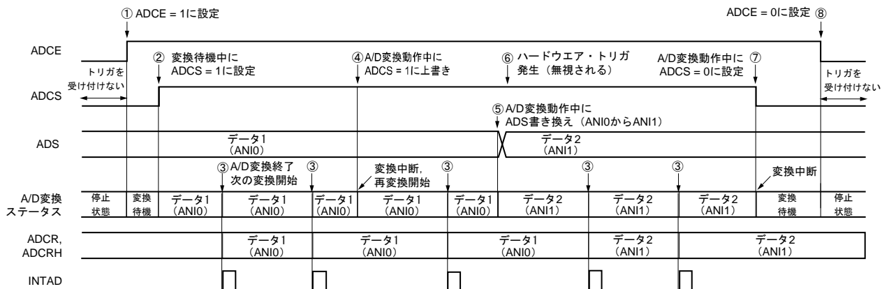
図12-22 ソフトウェア・トリガ・モード（セレクト・モード，連続変換モード）動作タイミング例
