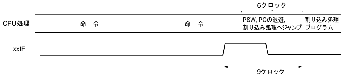
図21-12 割り込み要求の受け付けタイミング (最小時間)
