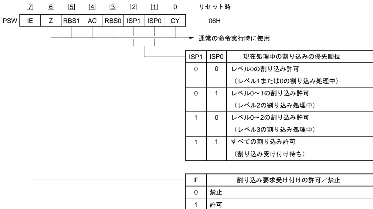
図21-10 プログラム・ステータス・ワードの構成
