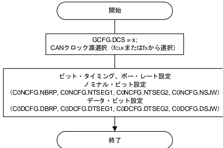
図 18-52 CAN クロック, ビット・タイミング, ポー・レート設定手順
