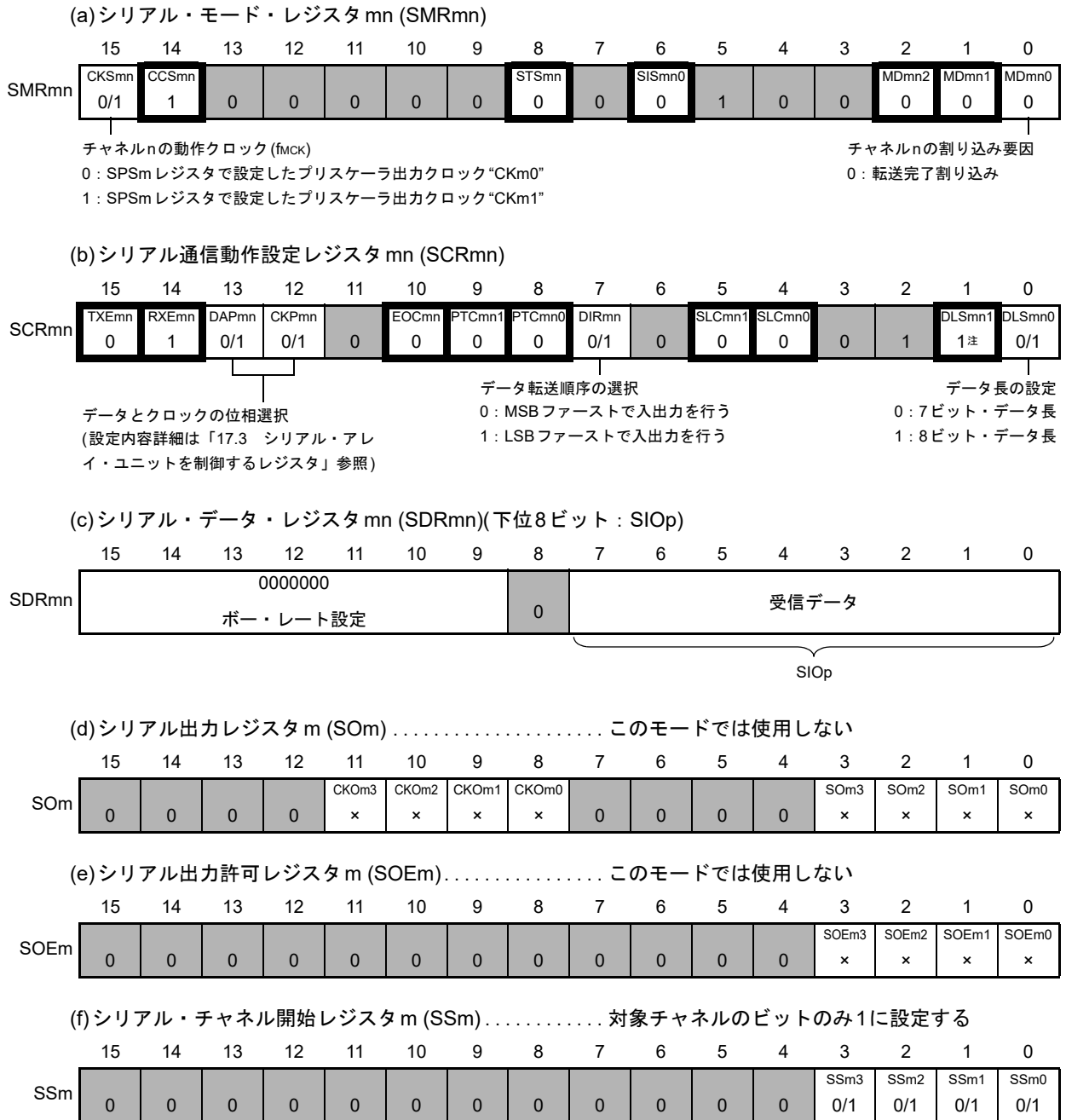
図 17 - 60 簡易SPI (CSI00, CSI01, CSI10, CSI11, CSI20, CSI21, CSI30, CSI31)のスレーブ受信時のレジスタ設定内容例
