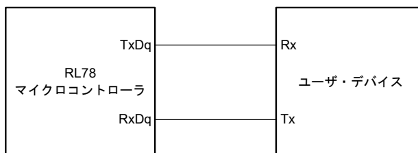
UARTモード接続図(同電位通信時)
