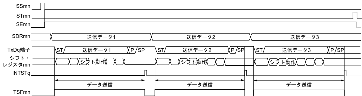
図17 - 112 UART 送信(シングル送信モード時)のタイミング・チャート
