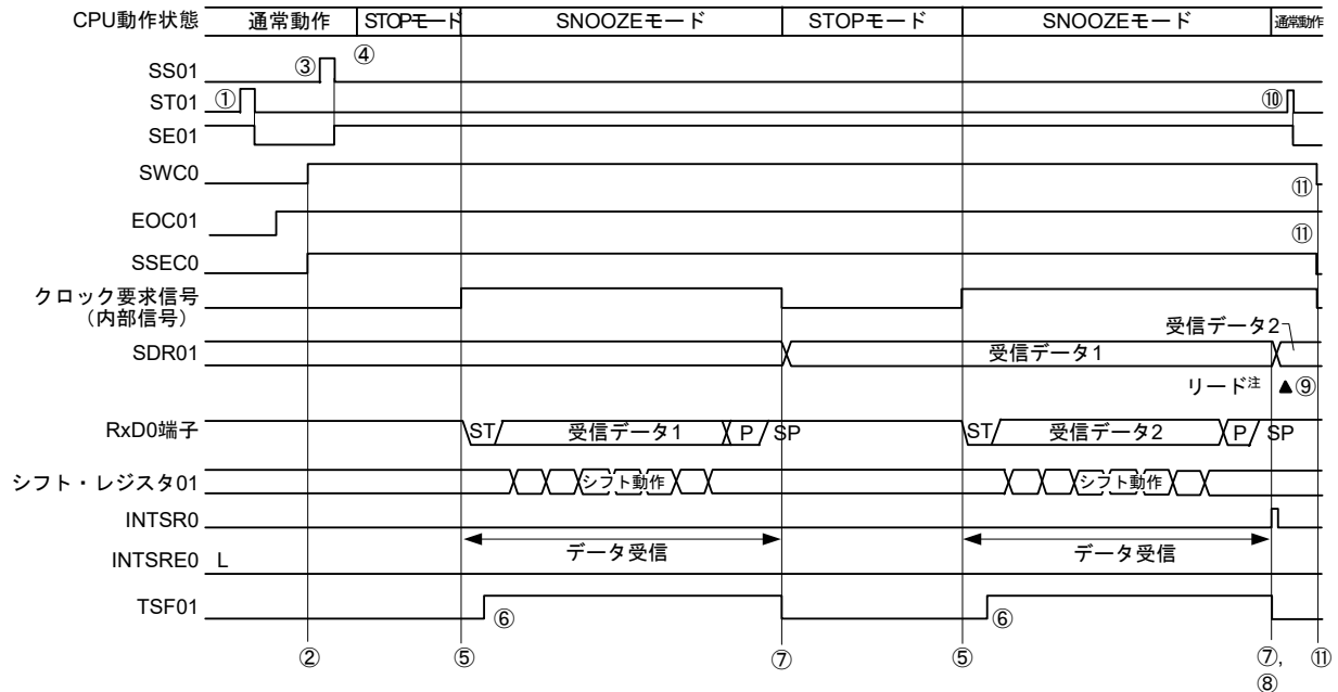
図 17 - 126 SNOOZEモード動作(EOCm1 = 1, SSECm = 1)時のタイミング・チャート
