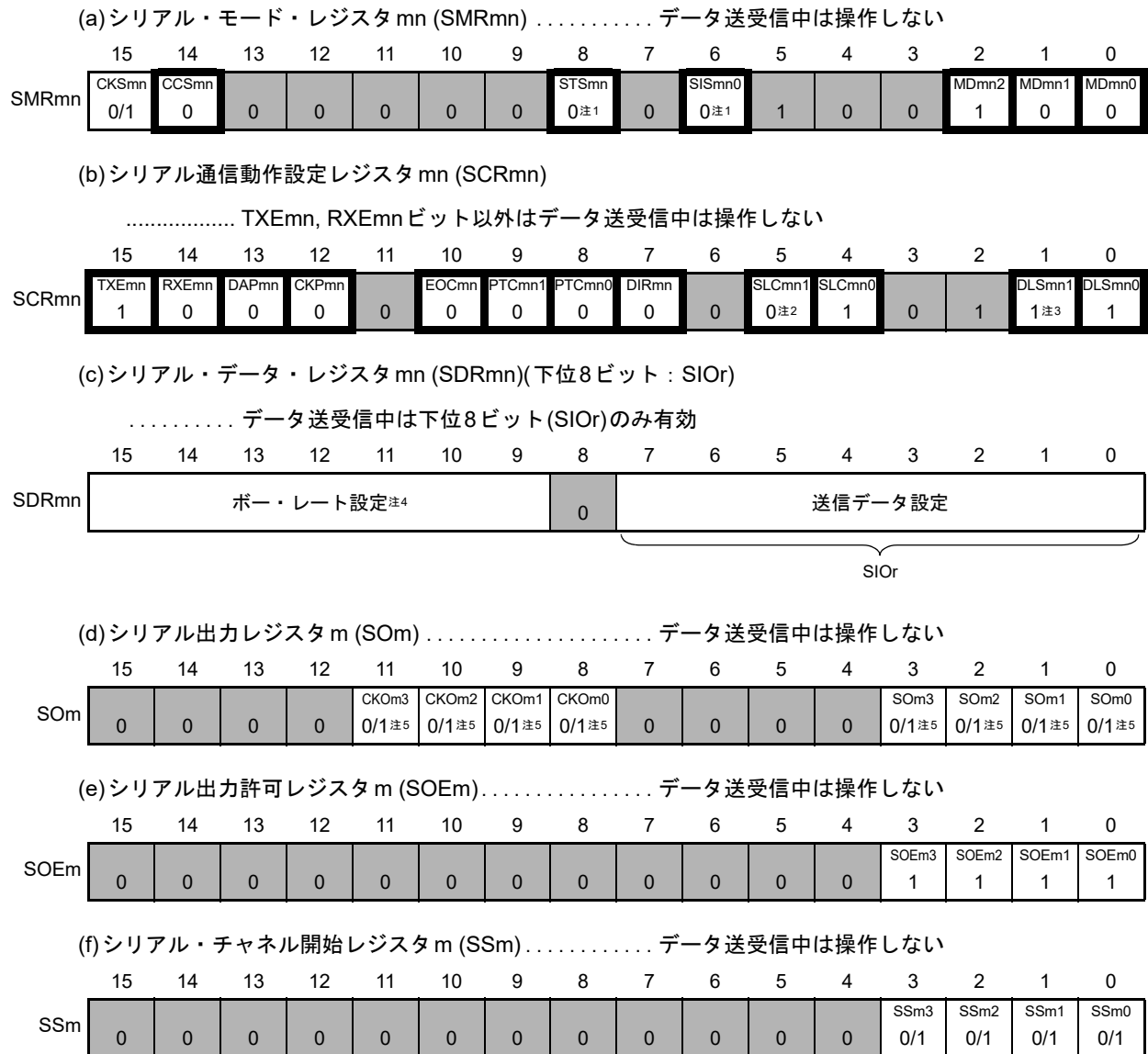
図 17 - 140 簡易 I 2 C (IIC00, IIC01, IIC10, IIC11, IIC20, IIC21, IIC30, IIC31) のデータ送信時のレジスタ設定内容例
