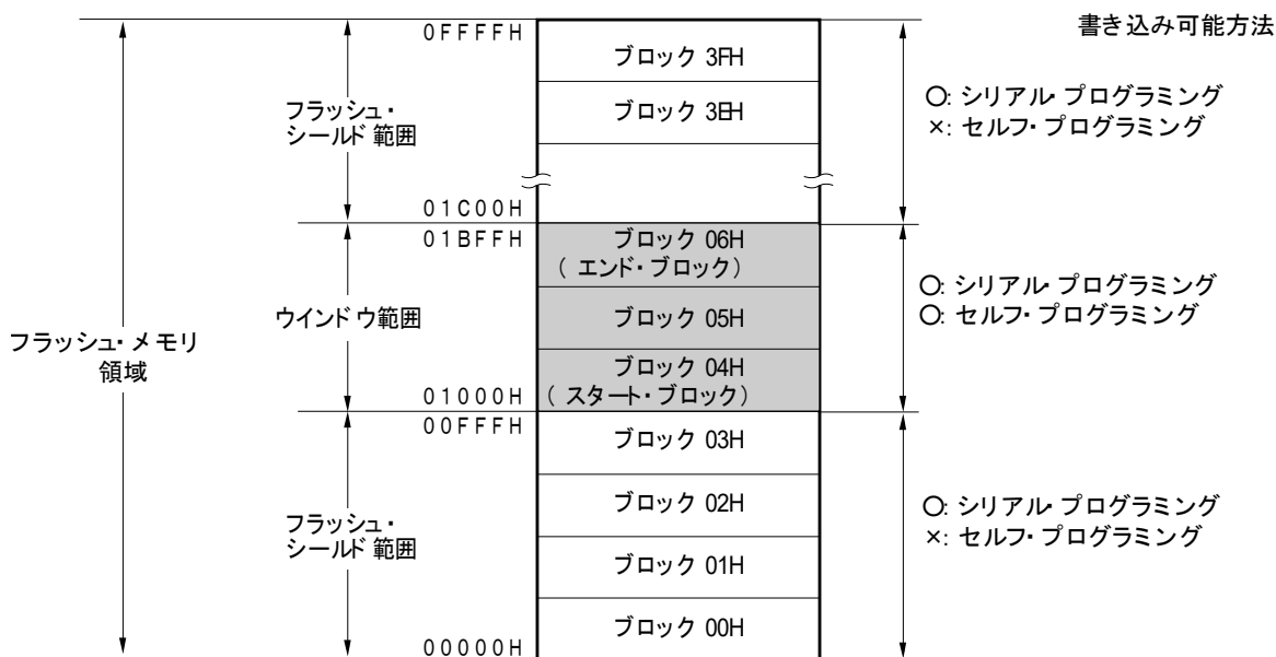
図25-11 フラッシュ・シールド・ウインドウの設定例 (対象デバイス：R5F10ELE, スタート・ブロック：04H, エンド・ブロック：06Hの場合)
