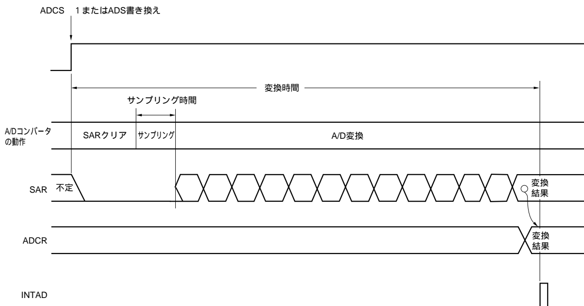
図11-15 A/Dコンバータの変換動作（ソフトウェア・トリガ・モードの場合）
