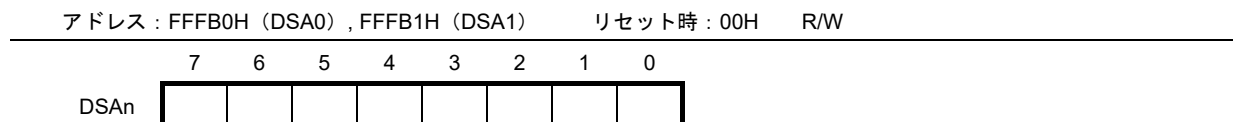
図16-1 DMA SFRアドレス・レジスタn (DSAn) のフォーマット
