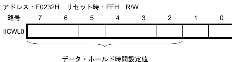
図13-10 IICAロウ・レベル幅設定レジスタ0 (IICWL0) のフォーマット
