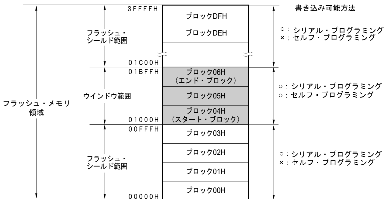
図3-11 フラッシュ・シールド・ウインドウの設定例 (スタート・ブロック : 04H、エンド・ブロック : 06Hの場合)
