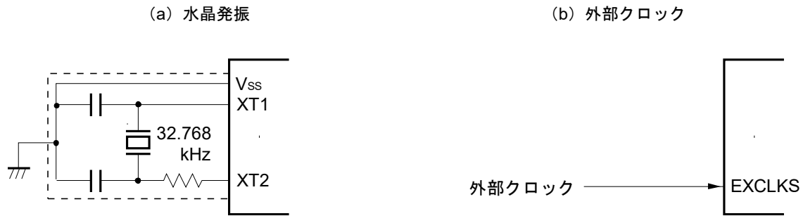
図6-12 XT1発振回路の外付け回路例
