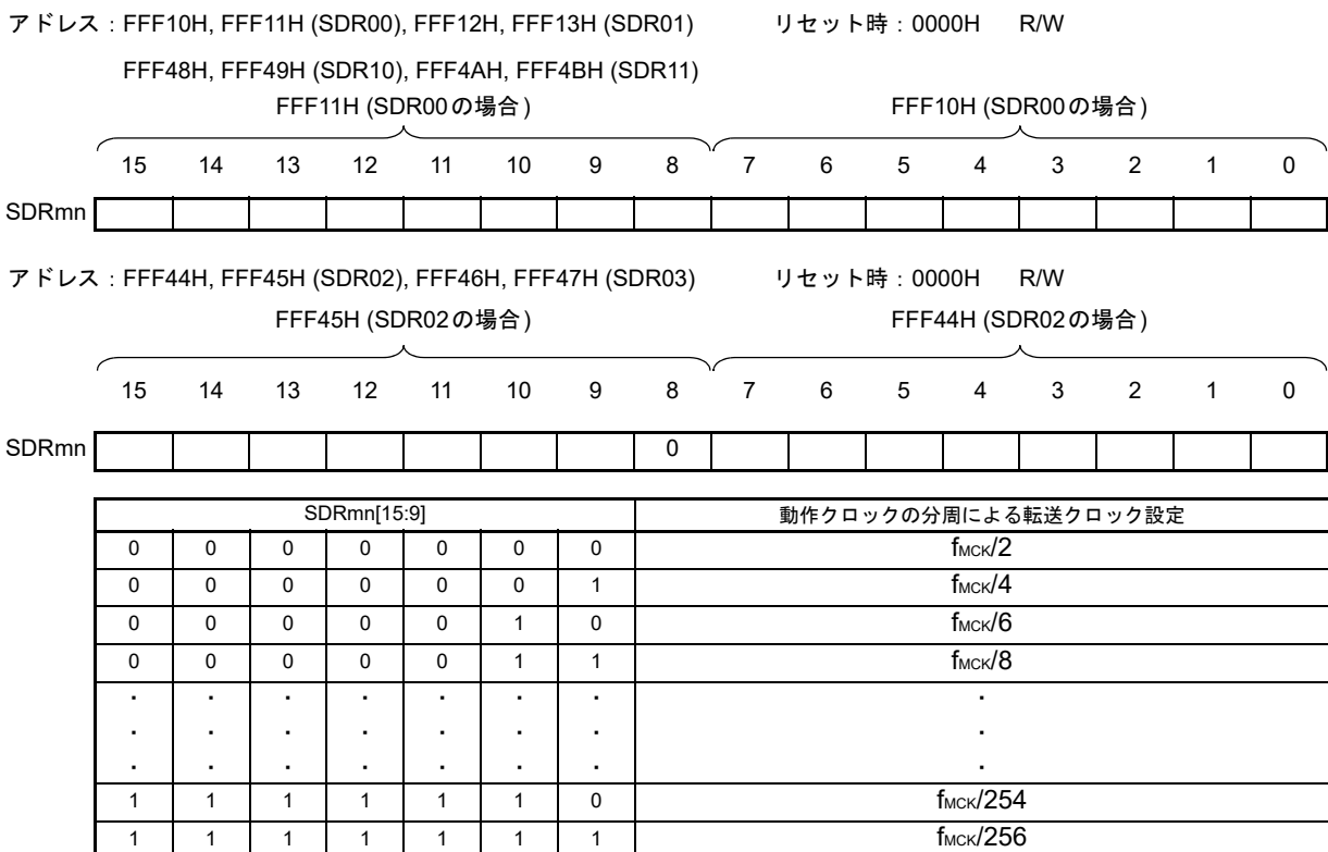
図 19 - 11 シリアル・データ・レジスタ mn (SDRmn)のフォーマット
