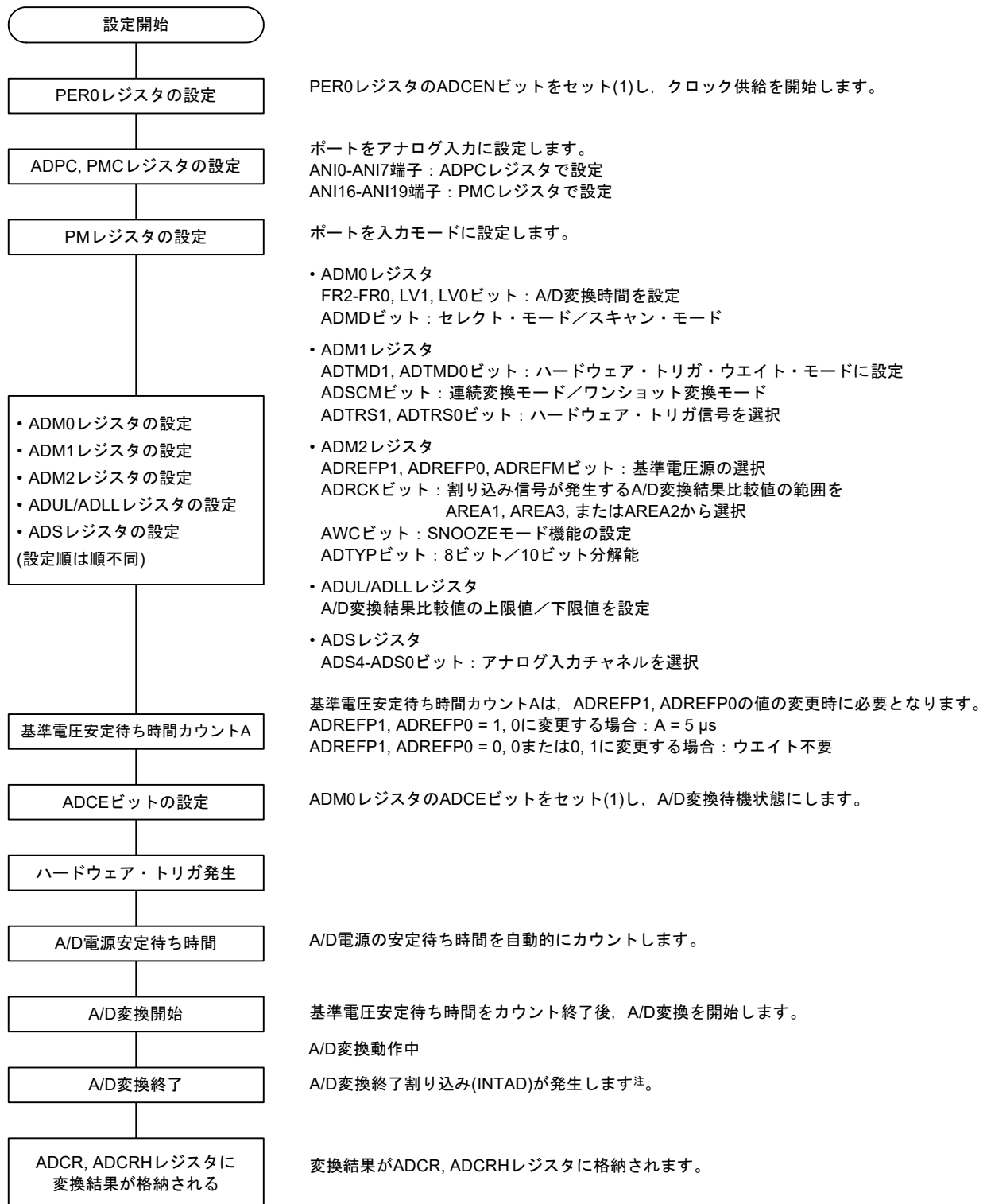
図12-33 ハードウェア・トリガ・ウェイト・モード設定
