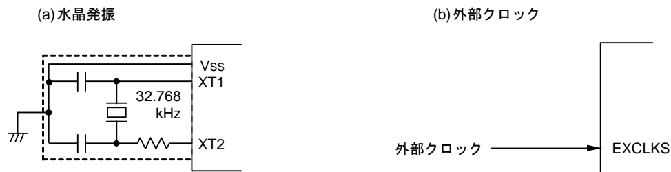
図5-15 XT1発振回路の外付け回路例
