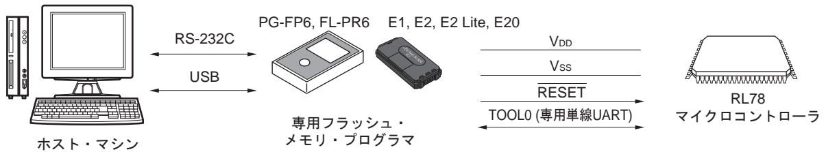
図34-1 フラッシュ・メモリにプログラムを書き込むための環境
