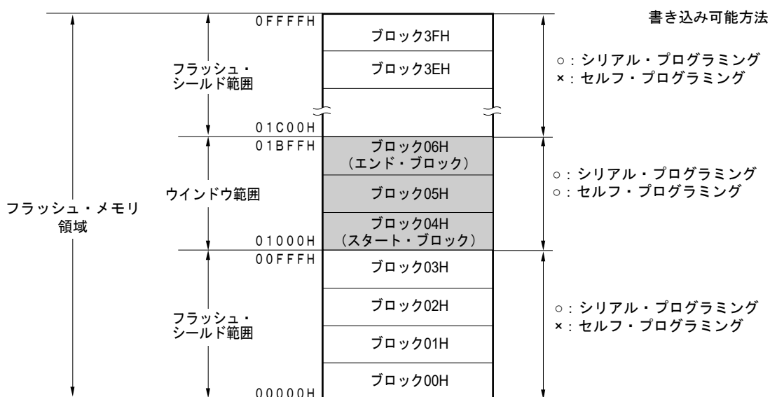
図28-9 フラッシュ・シールド・ウインドウの設定例 (対象デバイス：R5F107AE, スタート・ブロック：04H, エンド・ブロック：06Hの場合)
