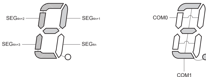
図21-28 2時分割LCD表示パターンと電極結線
