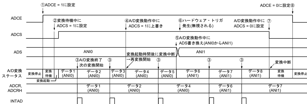
図 16 - 19 ソフトウェア・トリガ・モード(セレクト・モード, 連続変換モード)動作タイミング例
