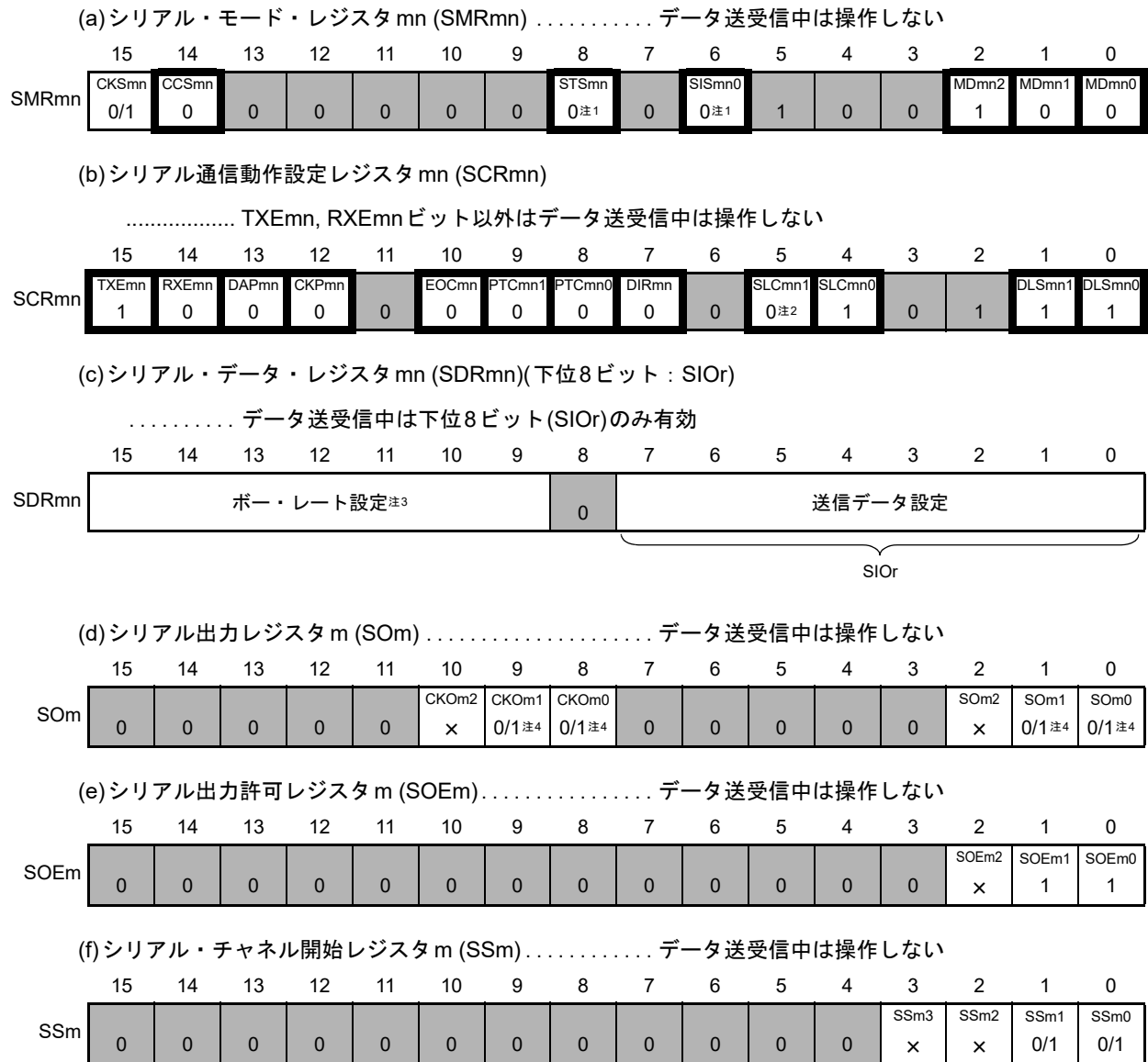
図 19 - 138 簡易 I 2 C (IIC00, IIC01) のデータ送信時のレジスタ設定内容例
