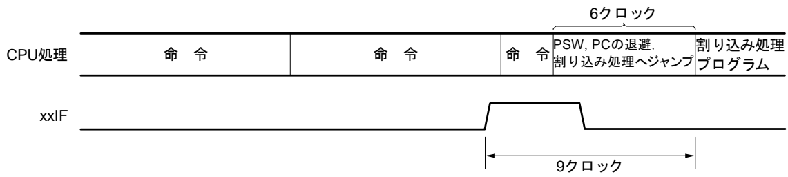
図17-8 割り込み要求の受け付けタイミング（最小時間）
