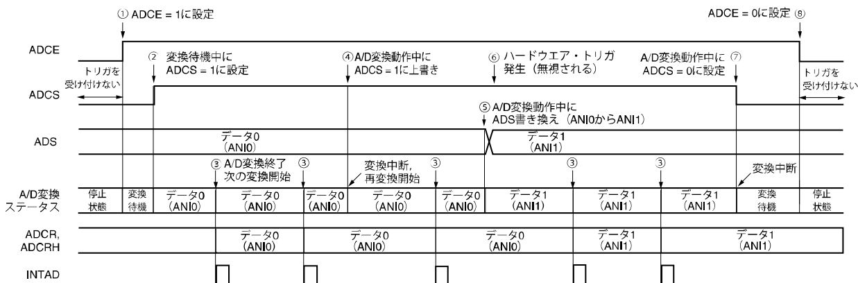
図11-17 ソフトウェア・トリガ・モード（連続変換モード）動作タイミング例
