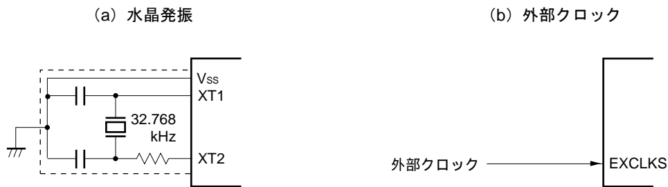
図5-12 XT1発振回路の外付け回路例
