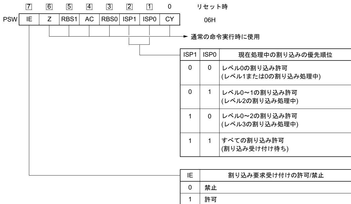
図22-9 プログラム・ステータス・ワードの構成
