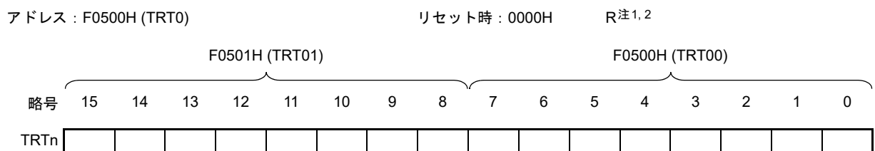
図7-3 8ビット・インターバル・タイマ・カウンタ・レジスタ n (TRT n )のフォーマット
