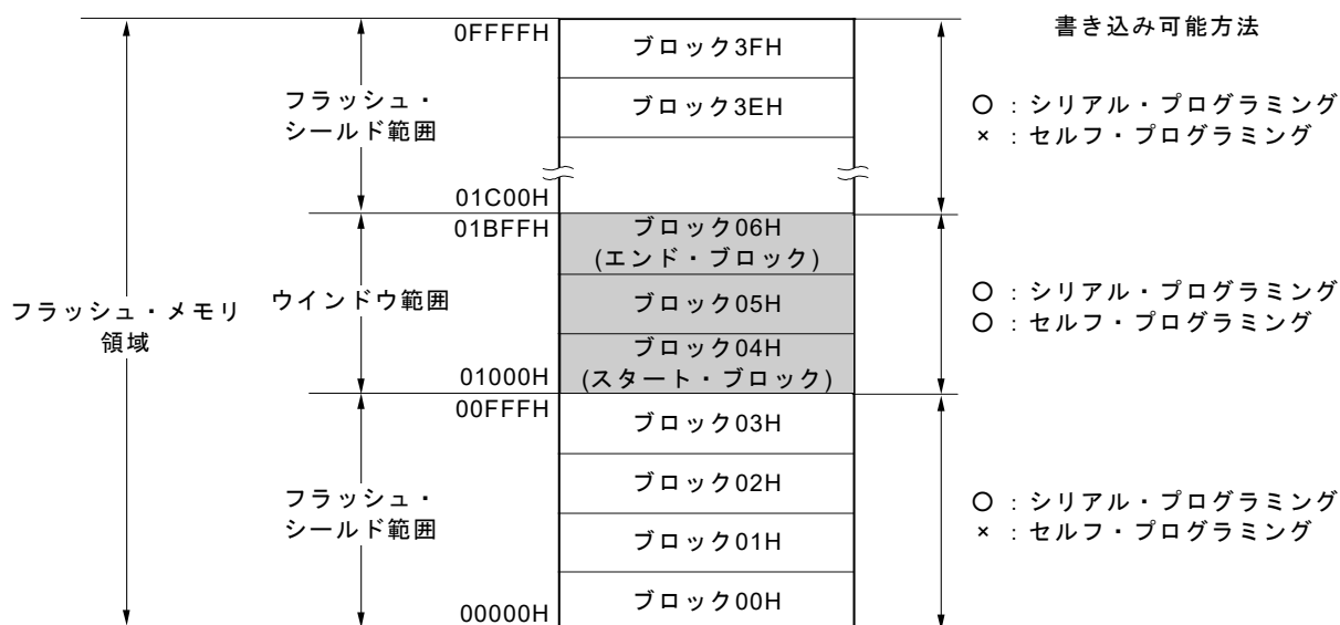
図31-11 フラッシュ・シールド・ウインドウの設定例 (対象デバイス：R5F11MME, スタート・ブロック：04H, エンド・ブロック：06Hの場合)
