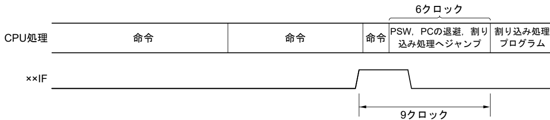
図22 - 11 割り込み要求の受け付けタイミング(最小時間)
