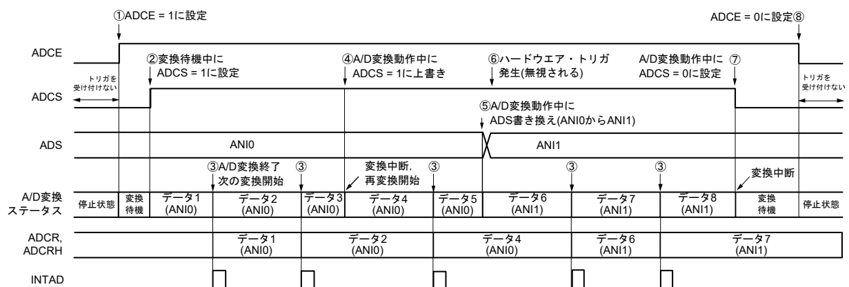
図12-18 ソフトウェア・トリガ・モード(セレクト・モード, 連続変換モード)動作タイミング例
