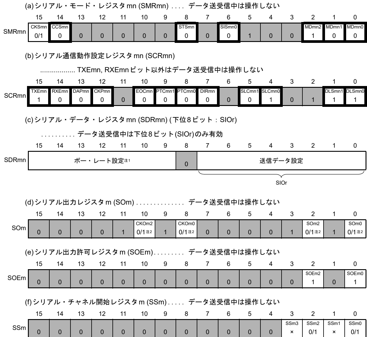
図15-112 簡易I 2 C (IIC00, IIC10, IIC20, IIC30)のデータ送信時のレジスタ設定内容例
