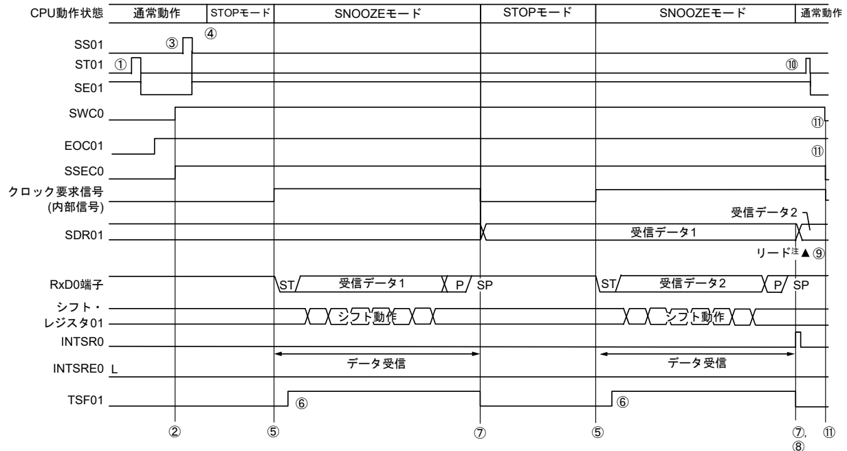
図15 - 98 SNOOZEモード動作(EOCm1 = 1, SSECm = 1)時のタイミング・チャート
