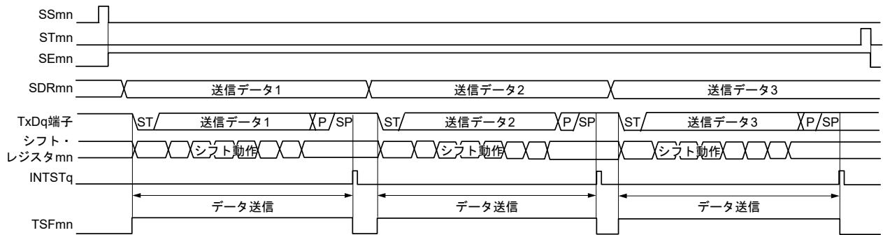
図 15 - 84 UART 送信 (シングル送信モード時) のタイミング・チャート
