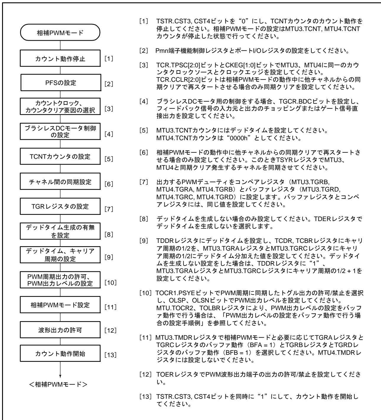
図 20.38 相補 PWM モードの設定手順例
