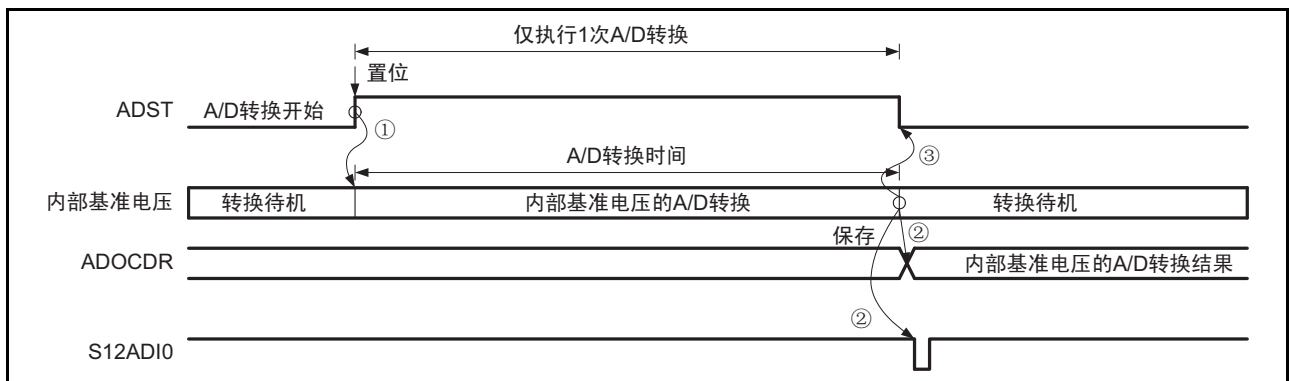
图 32.8 单次扫描模式的运行例子 (选择内部基准电压)
