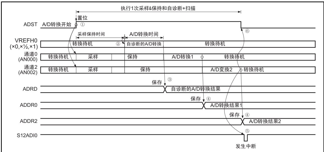
图 32.6 单次扫描模式的运行例子 (有通道专用采样 & 保持电路和自诊断)
