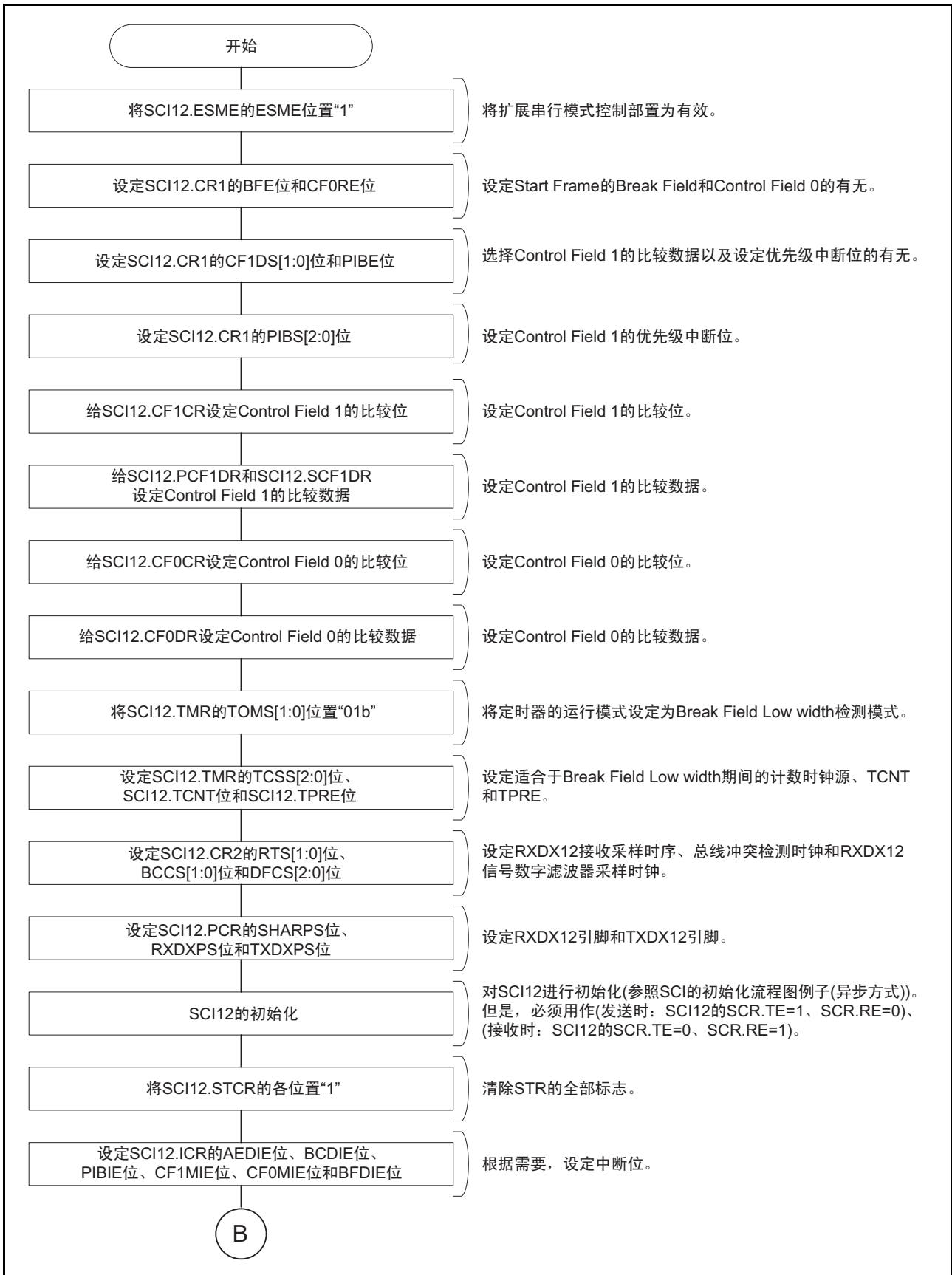
图 28.58 Start Frame 的接收流程图例子 (1)
