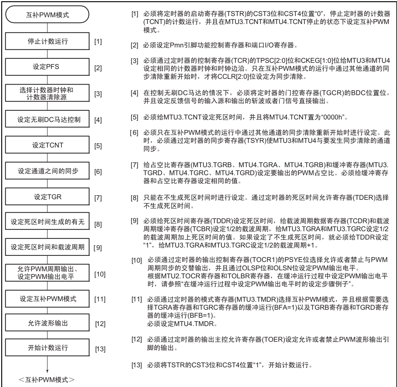
图 21.38 互补 PWM 模式的设定步骤例子
