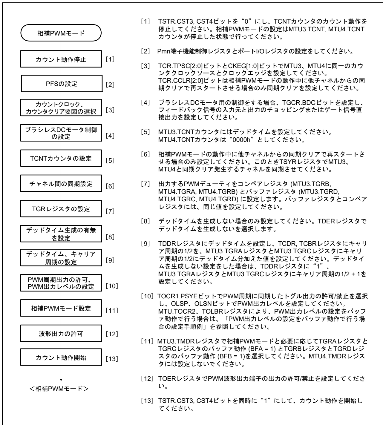
図 22.38 相補 PWM モードの設定手順例
