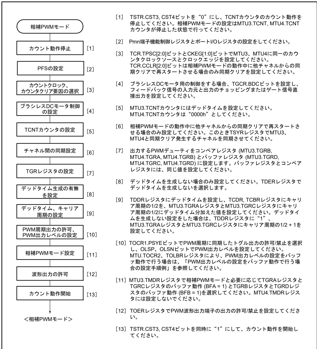
図 23.38 相補 PWM モードの設定手順例
