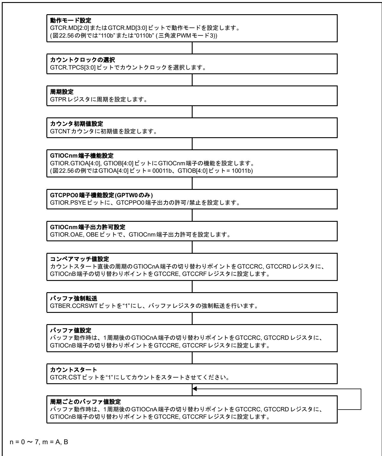
図 22.57 三角波 PWM モード 3 設定例
