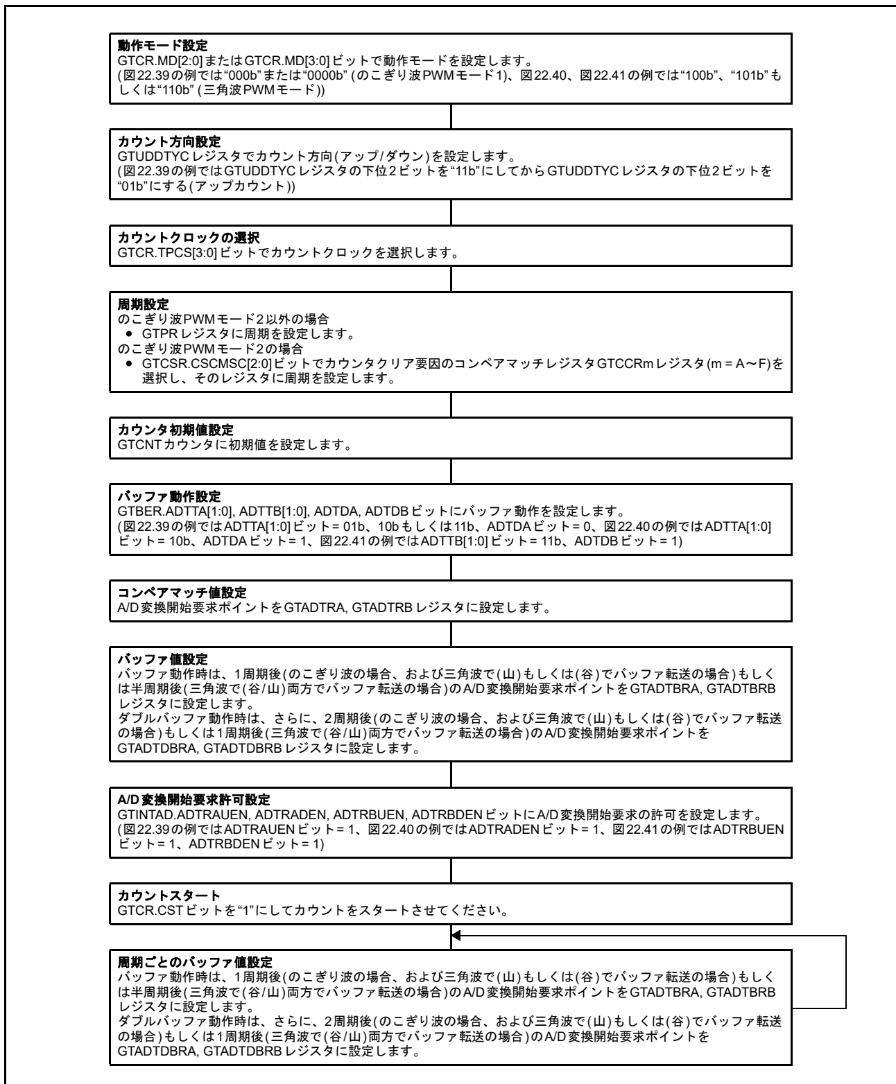
図 22.43 GTADTRA, GTADTRB レジスタのバッファ動作設定例
