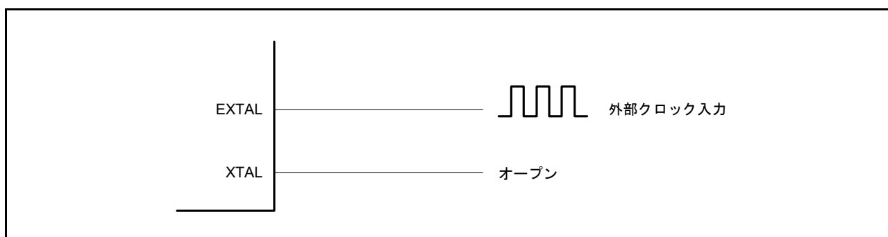
図 9.4 外部クロックの接続例
