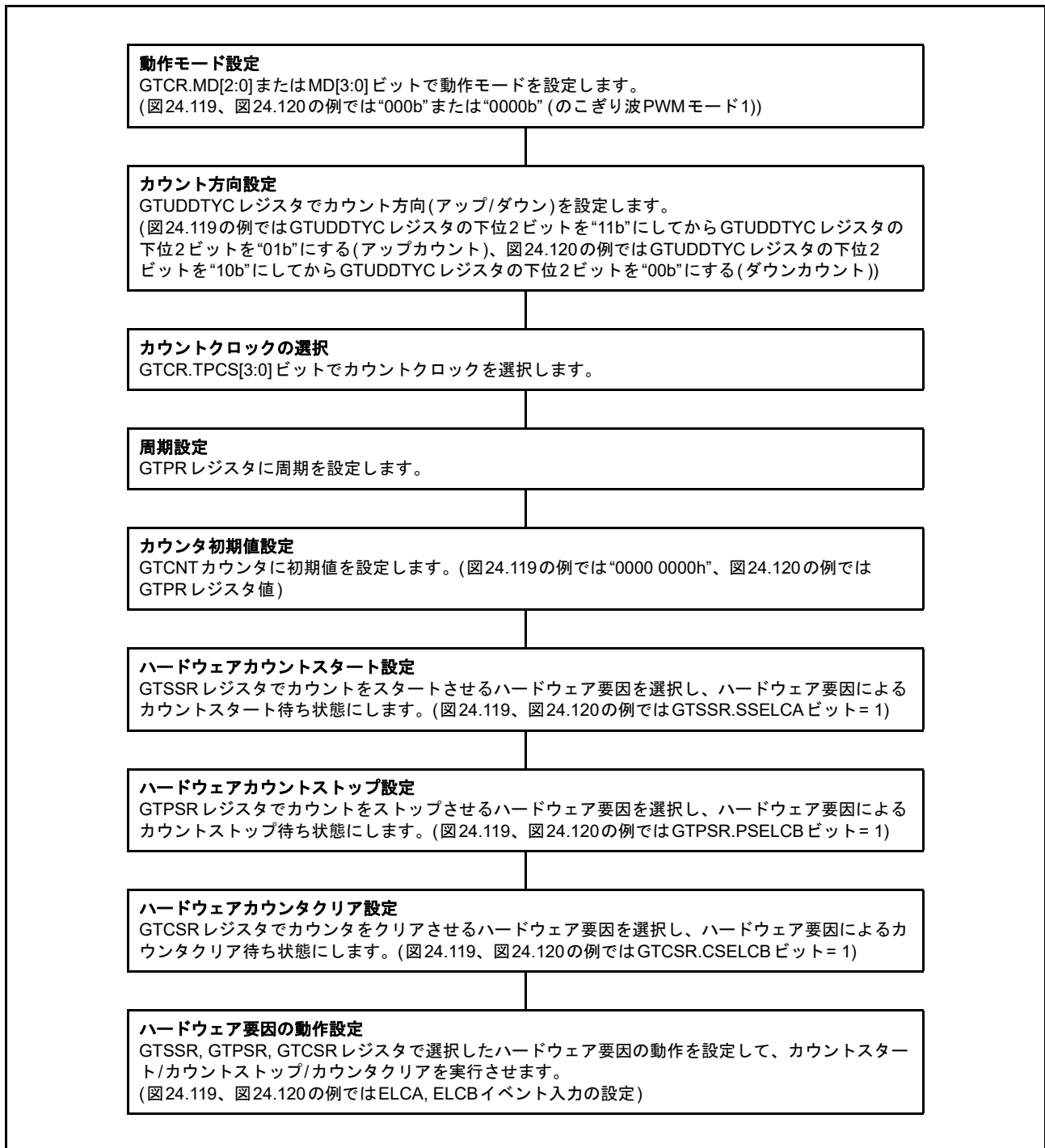
図 24.121 ハードウェア要因によるカウンタクリア動作設定例
