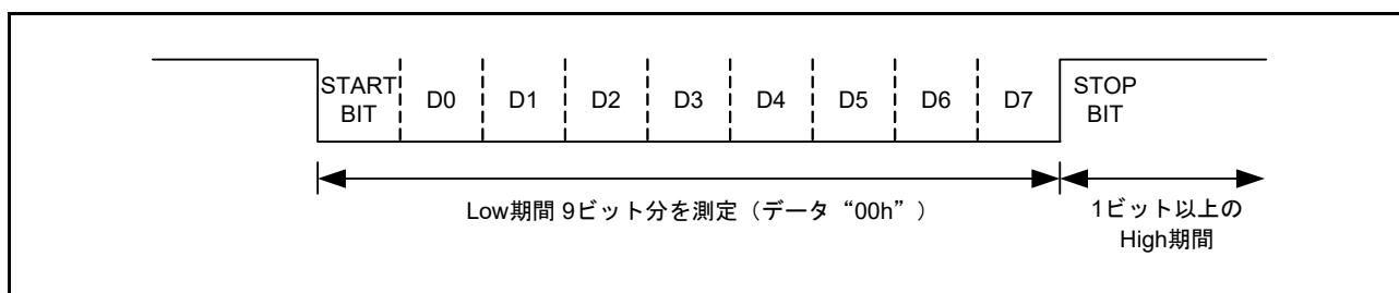
図 48.38 ビットレート自動調整時の SCI 送受信フォーマット
