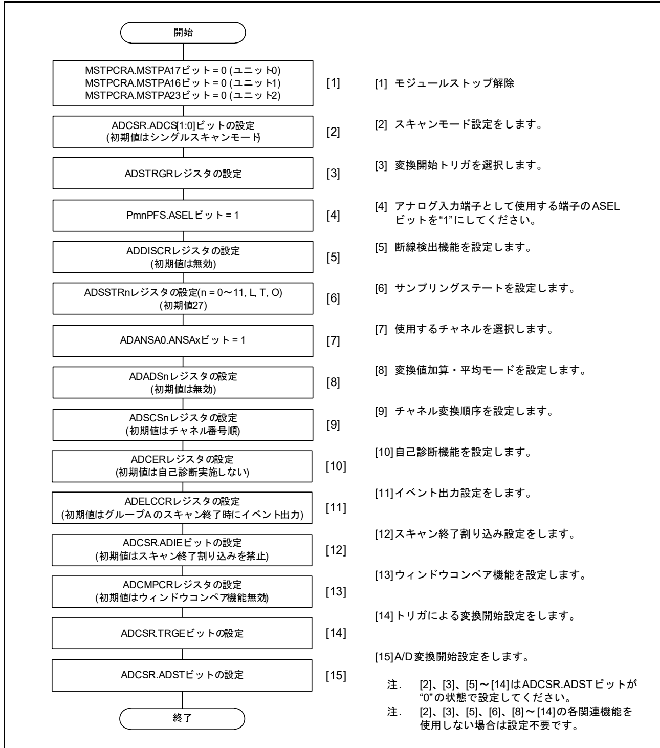
図 42.8 A/Dコンバータの初期設定フロー
