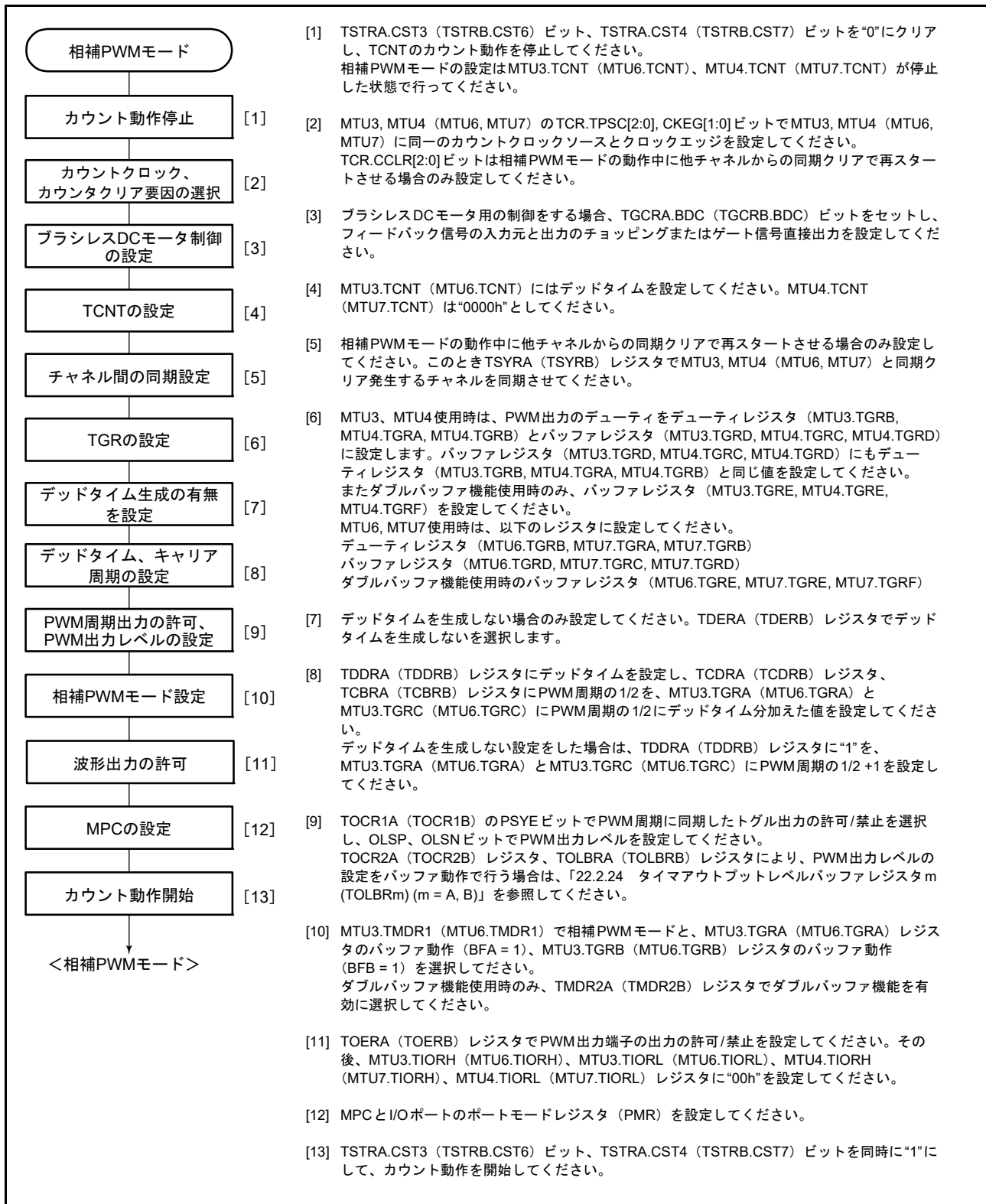
図 22.47 相補 PWM モードの設定手順例
