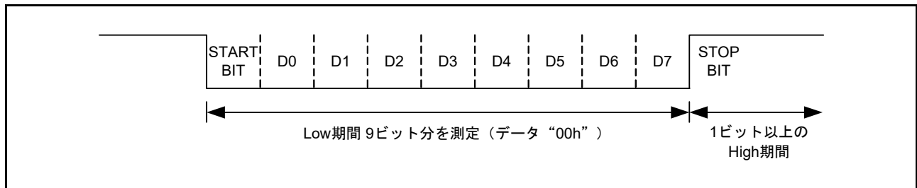
図 44.35 ビットレート自動調整時の SCI 送受信フォーマット
