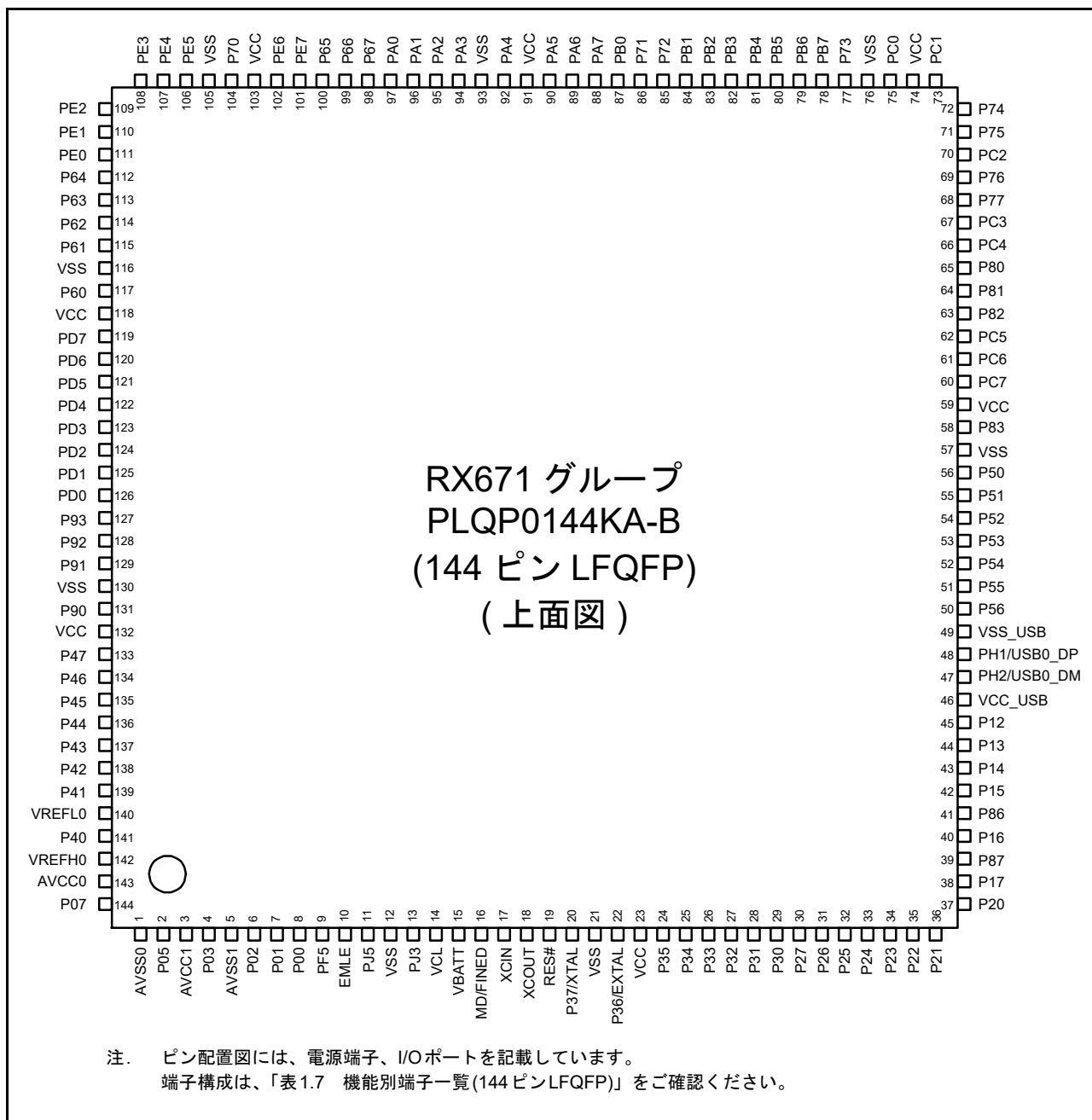
図 1.5 ピン配置図(144ピン LQFP)
