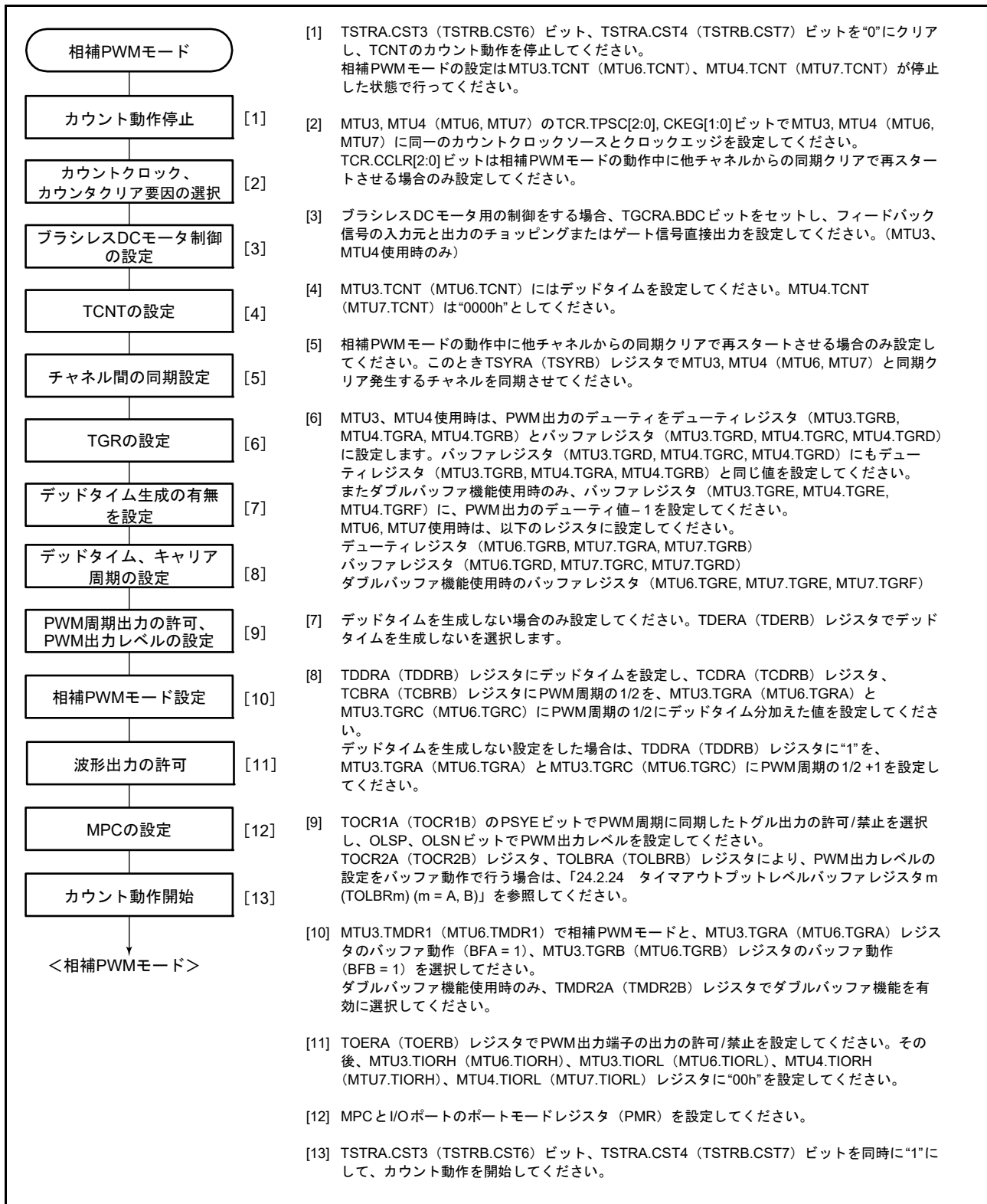
図 24.48 相補 PWM モードの設定手順例
