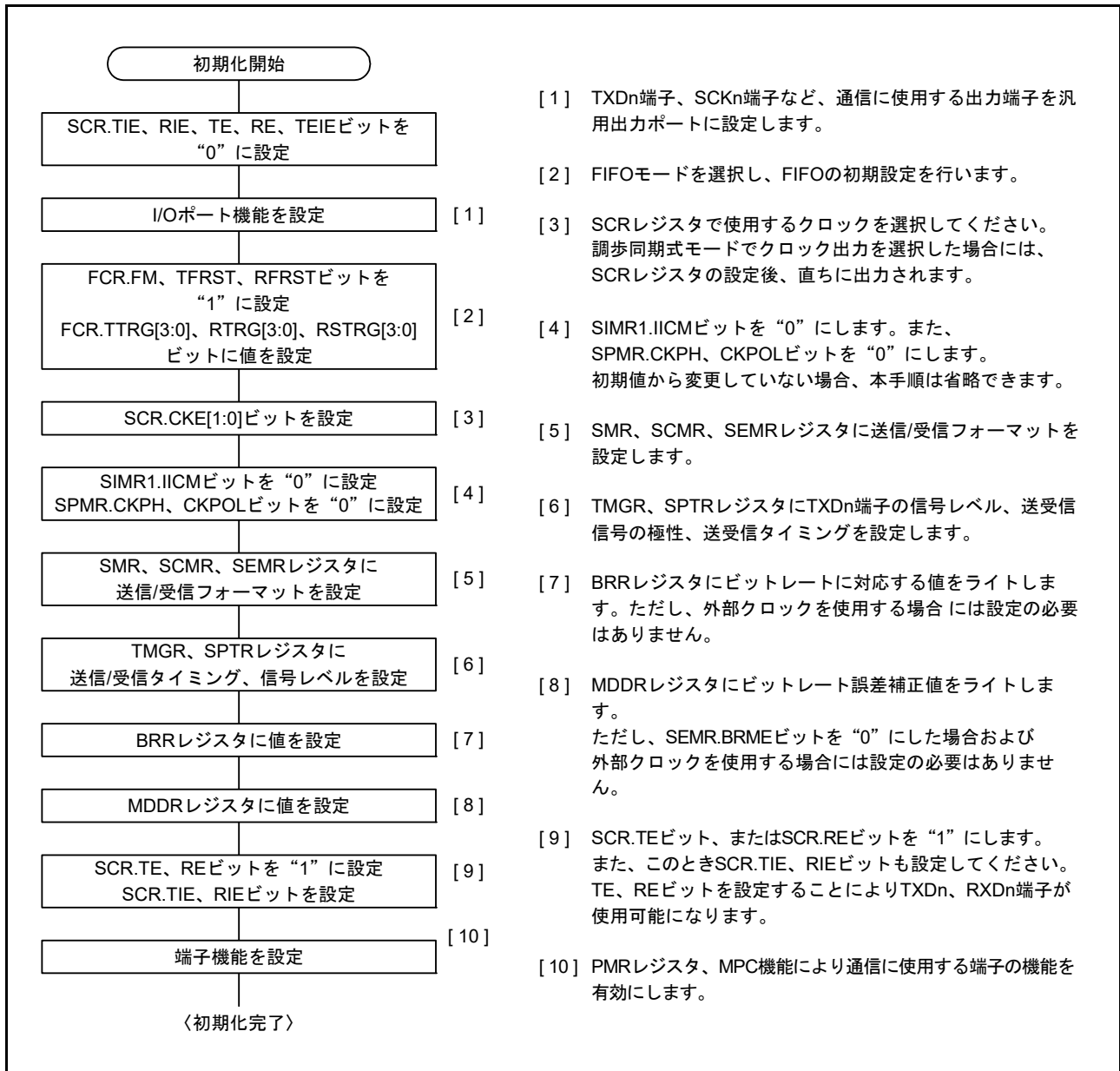
図 35.14 SCI の初期化フローチャートの例 ( 調歩同期式モード、FIFO 使用 ) (SCI10, SCI11)
