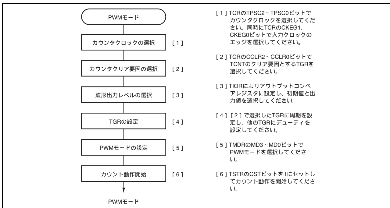
図 10.25 PWMモードの設定手順例
