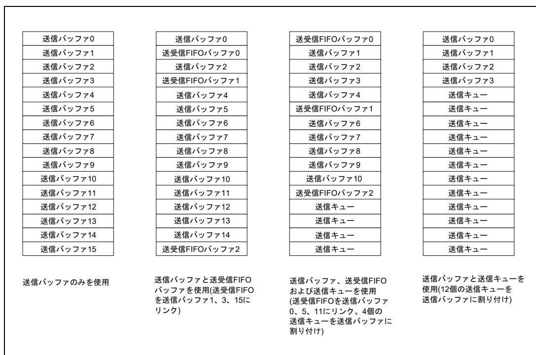
図 21.9 送信キューの割り付けと送受信FIFOバッファのリンク
