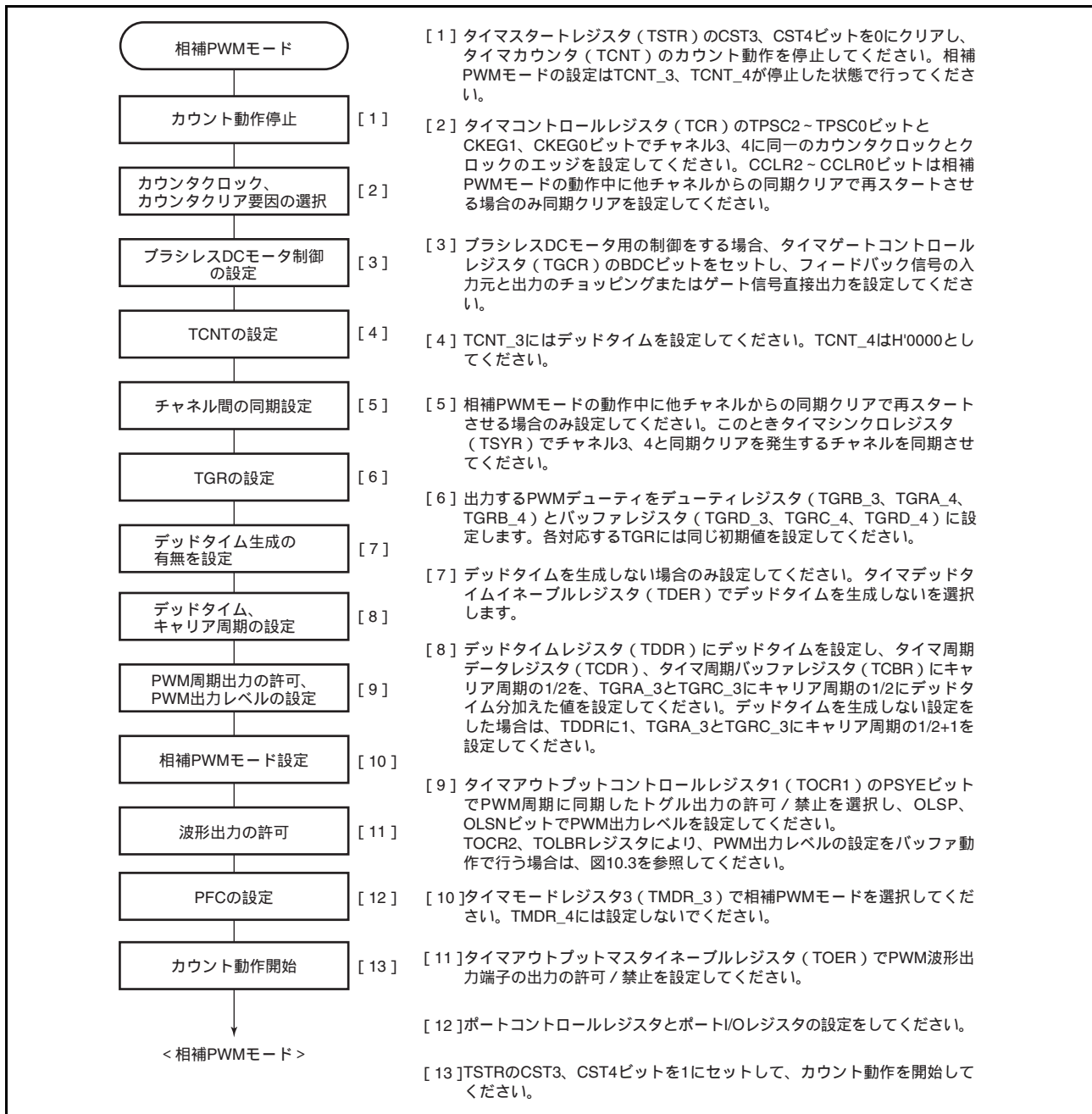
図 10.38 相補 PWM モードの設定手順例
