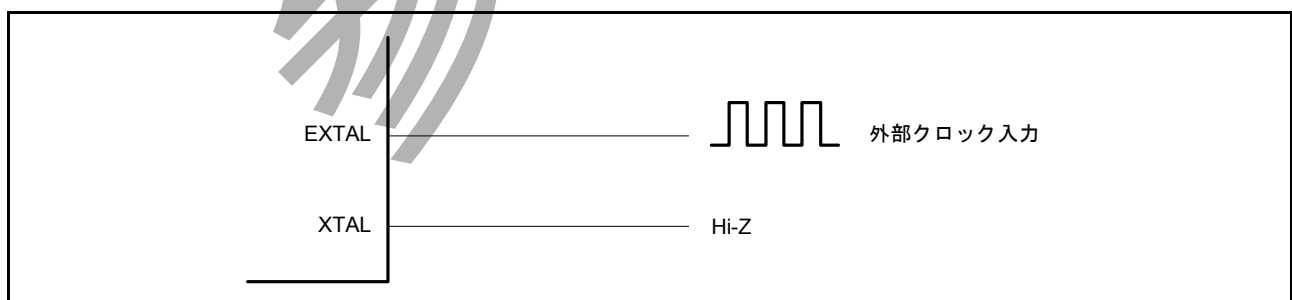
図 8.3 外部クロックの等価回路
