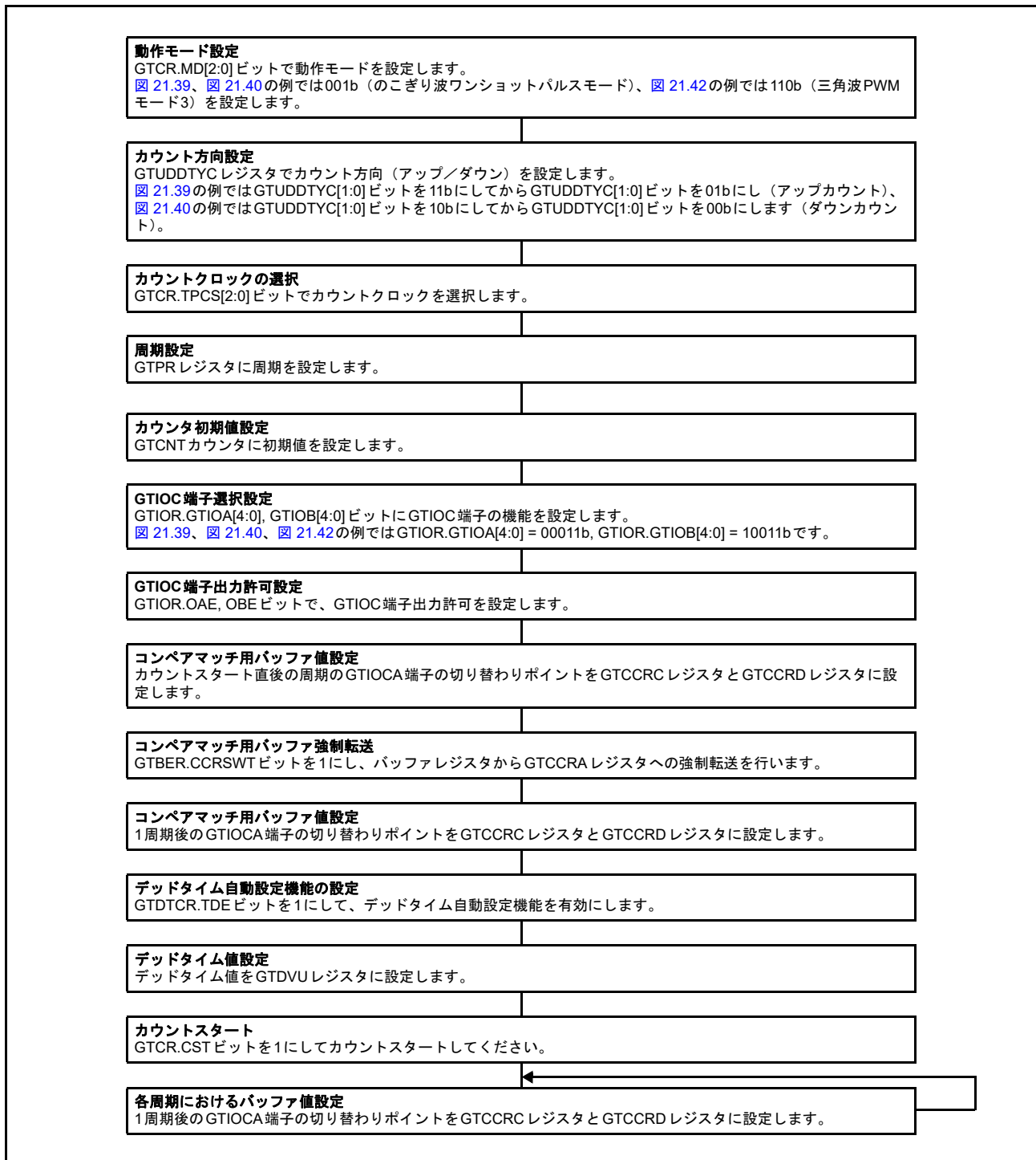
図 21.43 デッドタイム自動設定機能の設定例 (のこぎり波ワンショットパルスモード、三角波 PWM モード 3 の場合)
