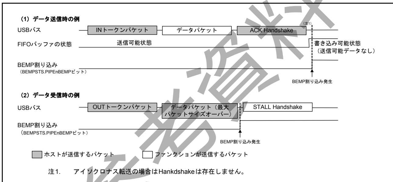
図 28.13 デバイスコントローラモード時の BEMP 割り込みの発生タイミング
