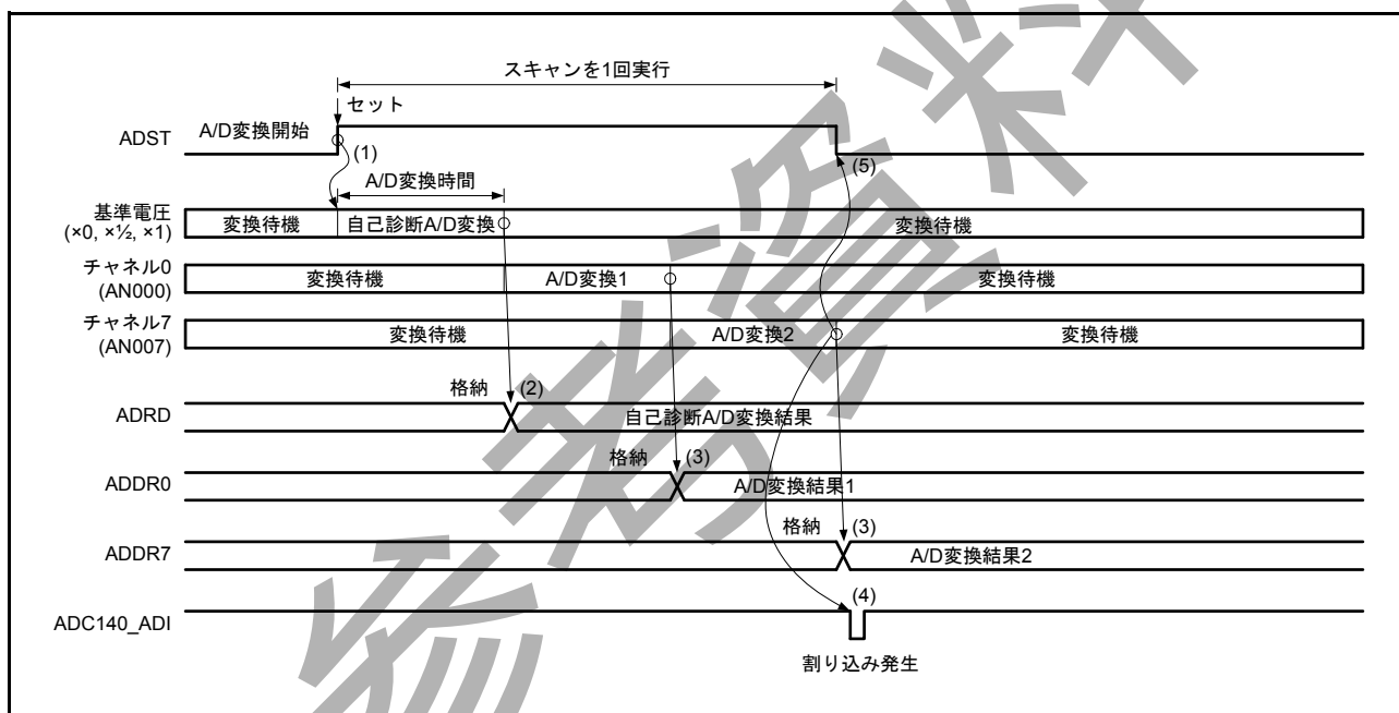
図 39.7 シングルスキャンモードの動作例 (基本動作 : AN000、AN007 選択 + 自己診断)
